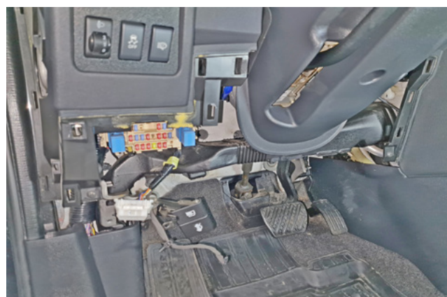
Фото 1.6. Накладка под рулевой колонкой снята
