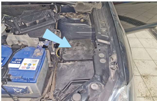
Фото 2.8. Возможное место установки подкапотного блока R6
