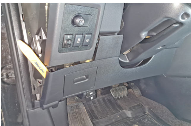
Фото 1.5. Снять пластиковую накладку под рулевой колонкой
