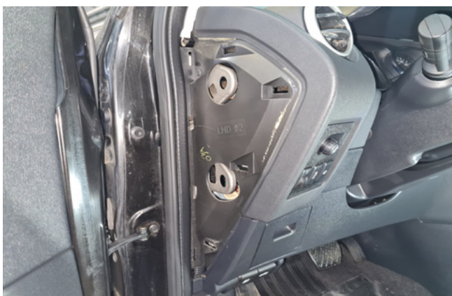
Фото 1.3. Боковая накладка снята
