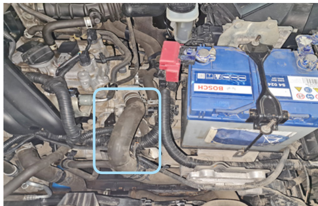
Фото 2.4. Место установки датчика температуры двигателя
