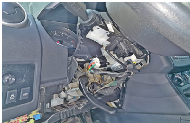
Фото 1.10. Нижняя часть кожуха рулевого вала снята
