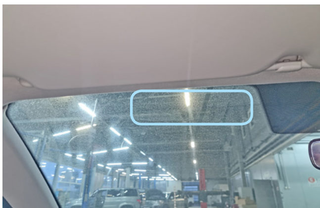
Фото 2.1. Возможное место установки антенного модуля
