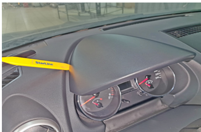
Фото 1.12. Снять солнцезащитный козырёк
