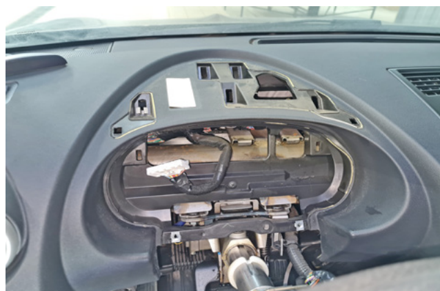
Фото 1.16. панель приборов снята
