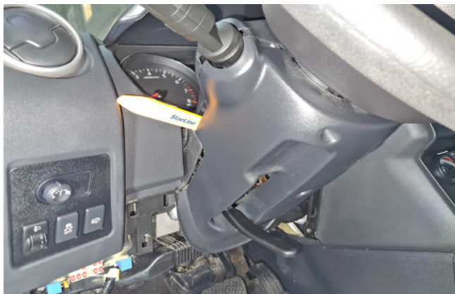
Фото 1.9. Снять нижнюю часть кожуха рулевого вала
