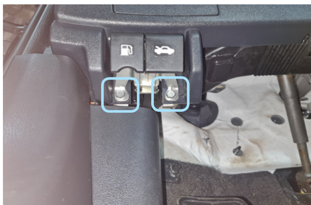
Фото 1.4. Болты крепления ручки отпирания капота и лючка бензобака
