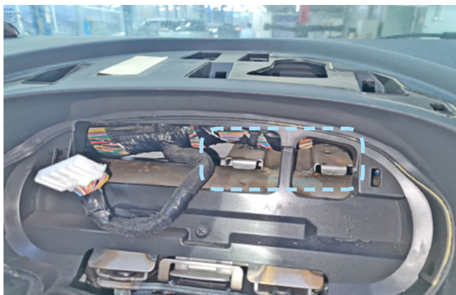
Фото 2.9. Пример расположения центрального блока охранно-телематического комплекса
