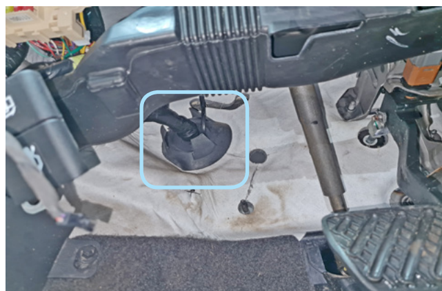
Фото 2.7. Штатный уплотнитель. Вид со стороны салона
