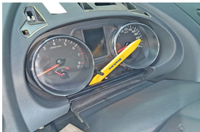
Фото 1.14. Снять декоративную накладку вместе с верхней частью кожуха рулевого вала
