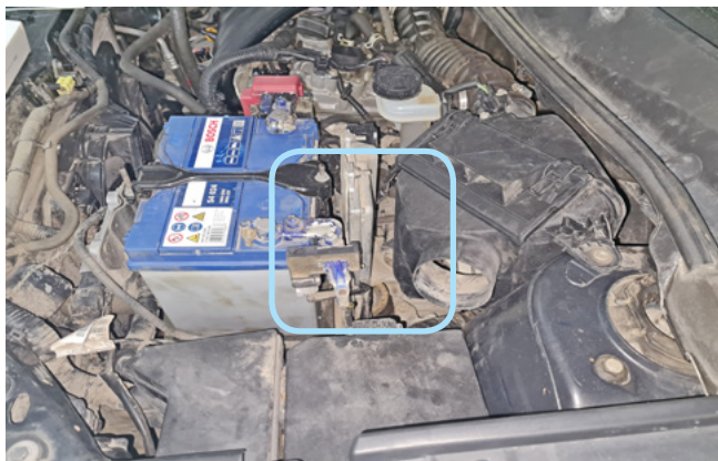
Фото 2.2. Возможное место установки сирены
