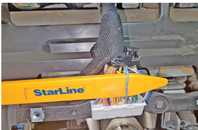
Фото 3.4. Управление индикатором штатного иммобилайзера (голубой)
