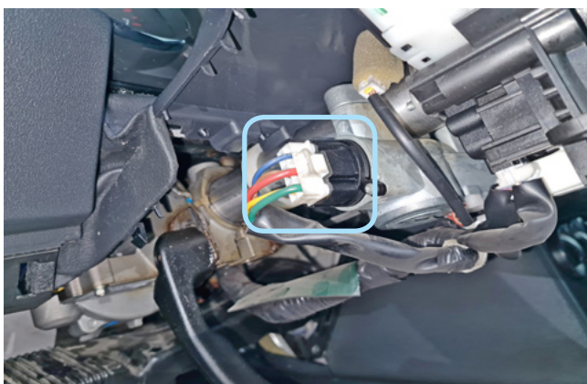
Фото 3.5. Местоположение разъёма замка зажигания
