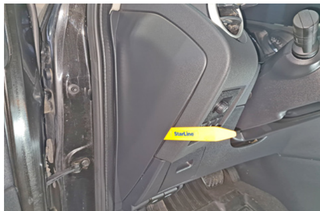
Фото 1.2. Снять боковую накладку передней панели
