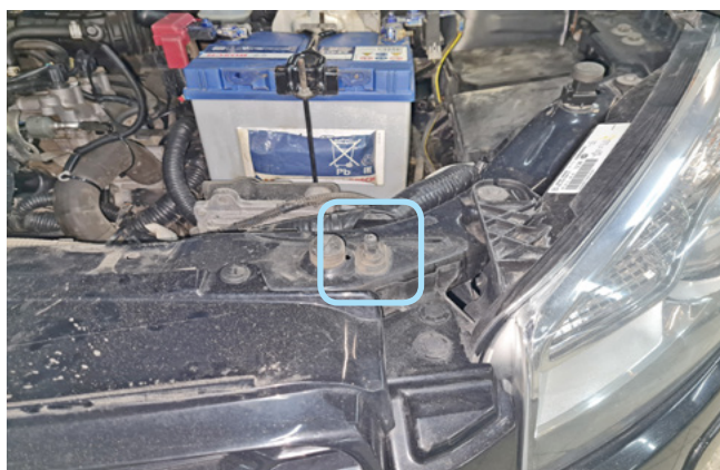
Фото 2.6. Возможное место установки концевика капота
