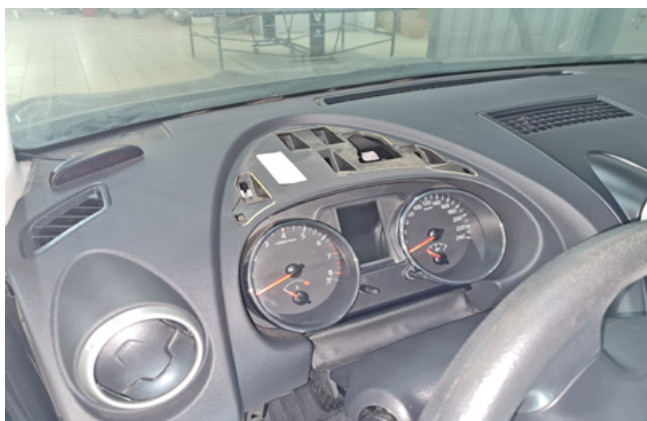
Фото 1.13. Солнцезащитный козырёк снят
