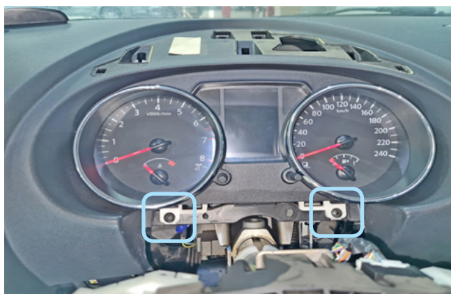
Фото 1.15. Декоративная накладка и верхняя часть кожуха рулевого вала сняты. Саморезы крепления
