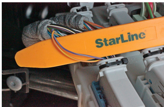
Фото 3.10. Шина данных штатного иммобилайзера (фиолетово-серый и жёлто-оранжевый)
