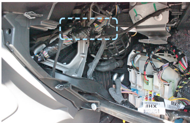
Фото 2.6. Пример расположения центрального блока охранно-телематического комплекса
