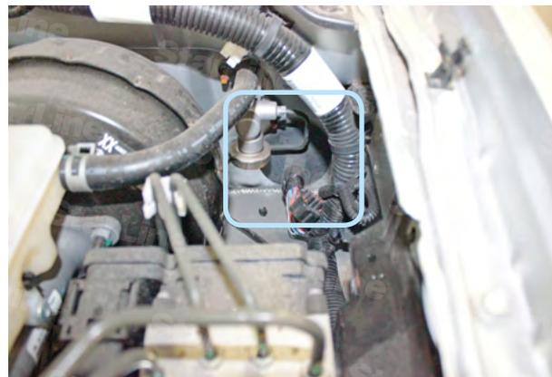
Фото 3.2. Штатный уплотнитель. Вид со стороны капота
