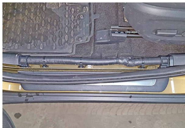
Фото 1.4. Накладка порога двери водителя снята
