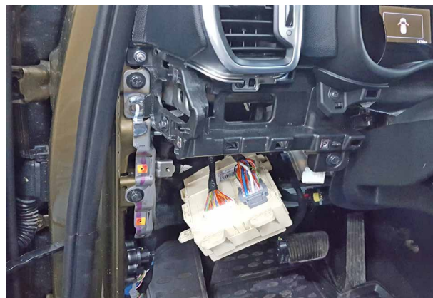
Фото 2.4. Монтажный блок предохранителей снят
