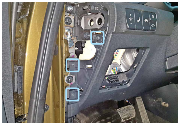
Фото 1.8. Накладка снята. Саморезы
