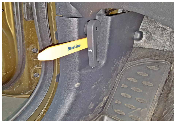
Фото 1.2. Снять ручку отпирания капота
