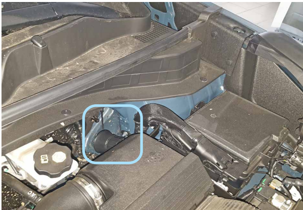
Фото 4.1. Возможное место установки сирены
