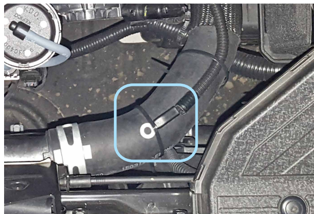
Фото 4.4. Крепление датчика температуры двигателя
