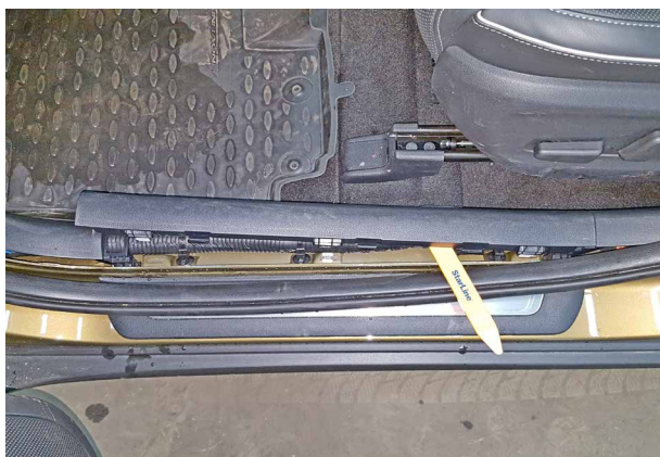
Фото 1.3. Снять накладку порога двери водителя
