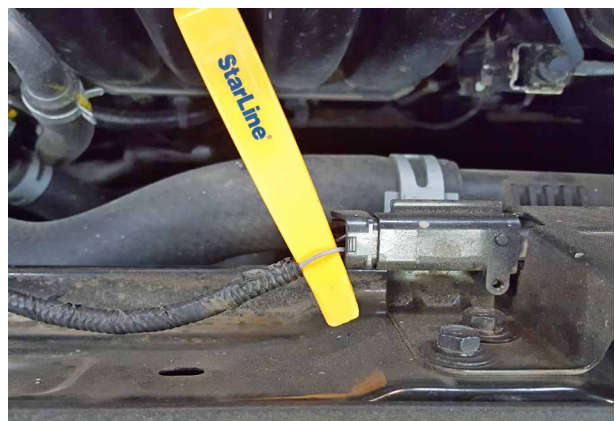
Фото 4.6. Контроль концевика капота (серый)
