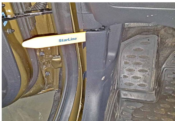
Фото 1.5. Снять накладку левой кик-панели
