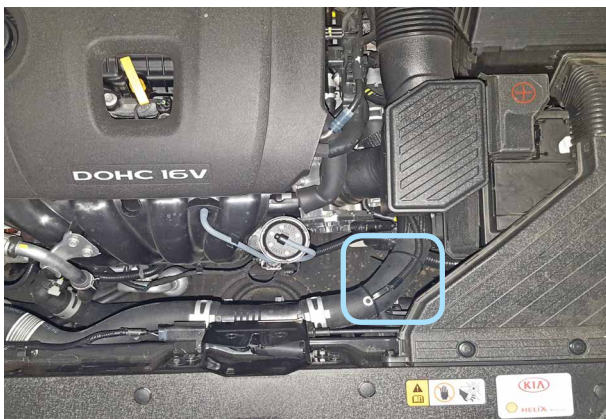
Фото 4.3. Место установки датчика температуры двигателя
