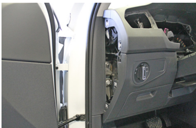
Фото 1.12. Левая боковая накладка снята
