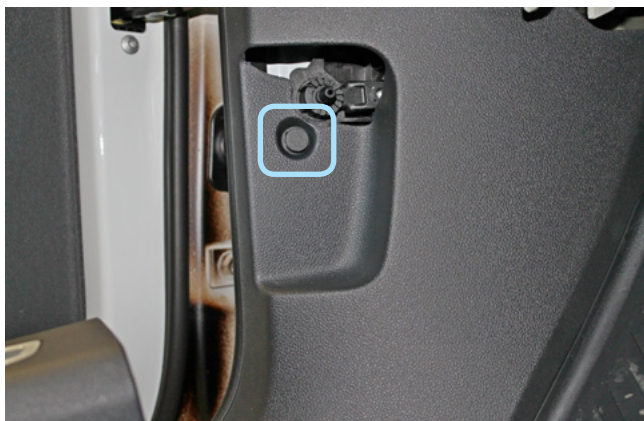
Фото 1.18. Ручка отпирания капота снята. Клипса крепления накладки кик-панели
