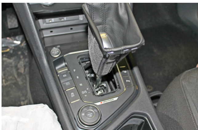
Фото 1.24. Пылезащитный кожух селектора АКПП снят
