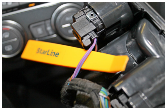
Фото 3.9. Управление кнопкой Старт-Стоп (фиолетовый и фиолетово-синий)
