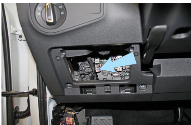
Фото 3.4. Местоположение жгута диагностического разъёма. Крышка блока предохранителей снята
