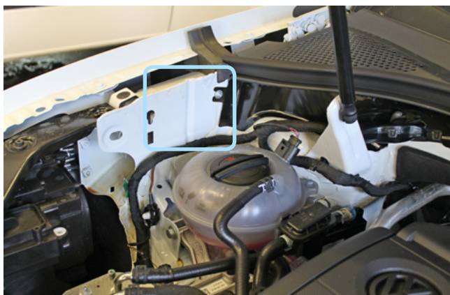
Фото 2.3. Возможное место установки сирены
