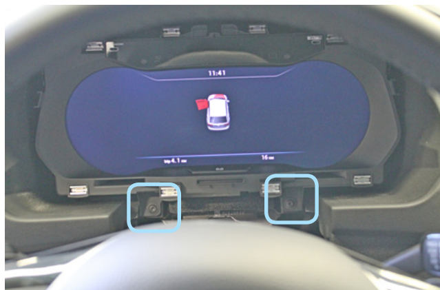
Фото 1.8. Винты крепления панели приборов
