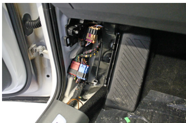
Фото 1.21. Накладка левой кик-панели снята
