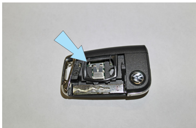
Фото 3.15. Контактная площадка (+) на плате ключа
