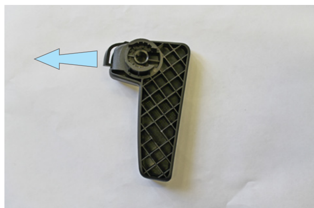
Фото 1.17. Сдвинуть фиксатор ручки отпирания капота
