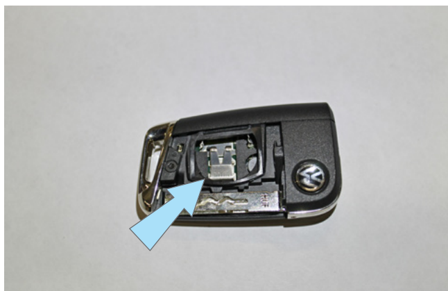
Фото 3.14. Контактная площадка (-) на плате ключа
