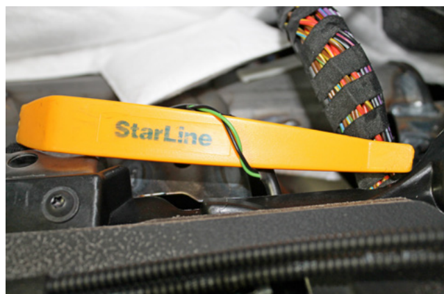
Фото 3.13. Провода антенны штатного иммобилайзера (зелёный и чёрный)
