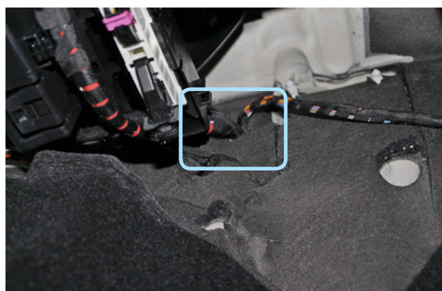
Фото 2.7. Штатный уплотнитель. Вид со стороны салона
