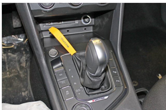
Фото 1.23. Снять пылезащитный кожух селектора АКПП
