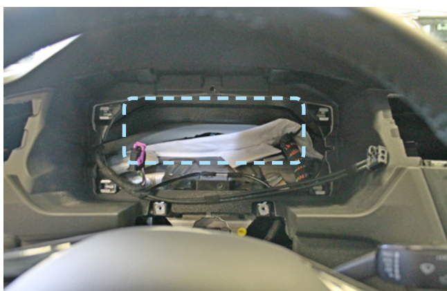
Фото 2.8. Пример расположения центрального блока охранно-телематического комплекса
