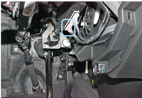
Фото 8.1. Местоположение разъёма на блоке BCM
