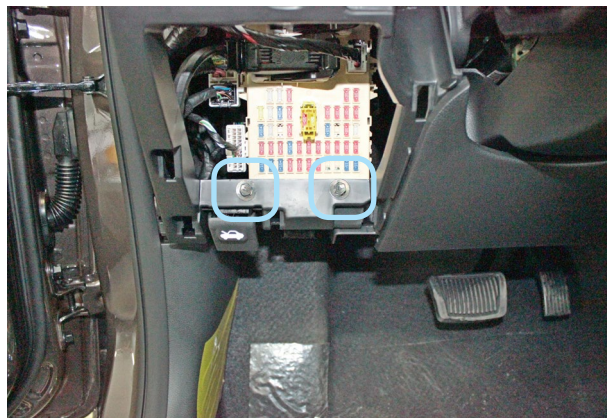
Фото 1.8. Болты крепления пластиковой наклейки под рулевой колонкой
