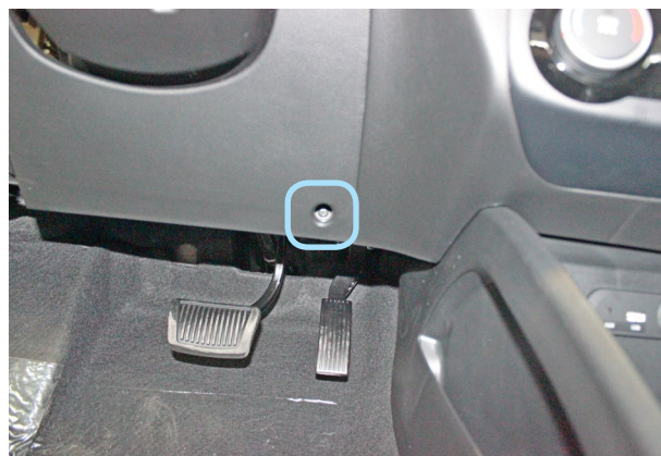
Фото 1.10. Саморез крепления пластиковой наклейки под рулевой колонкой
