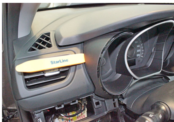
Фото 3.2. Снять декоративную накладку панели приборов
