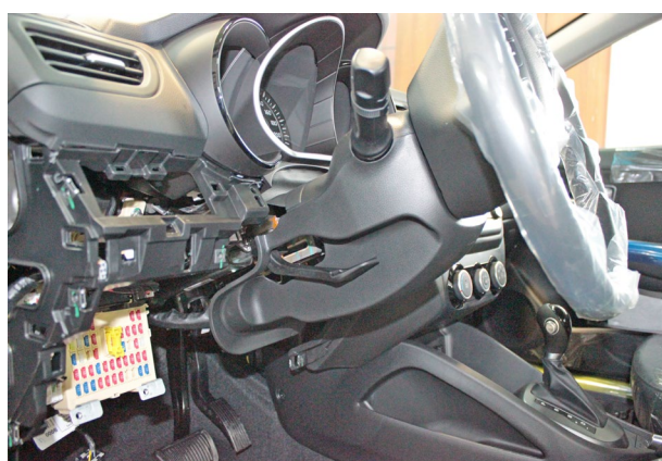
Фото 2.1. Кожух рулевого вала. Общий вид
