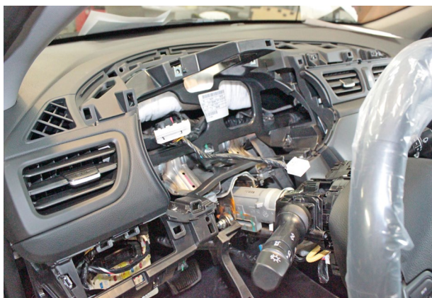
Фото 3.5. Панель приборов снята
