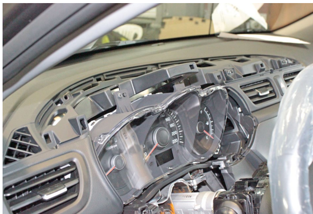
Фото 3.3. Накладка панели приборов снята
