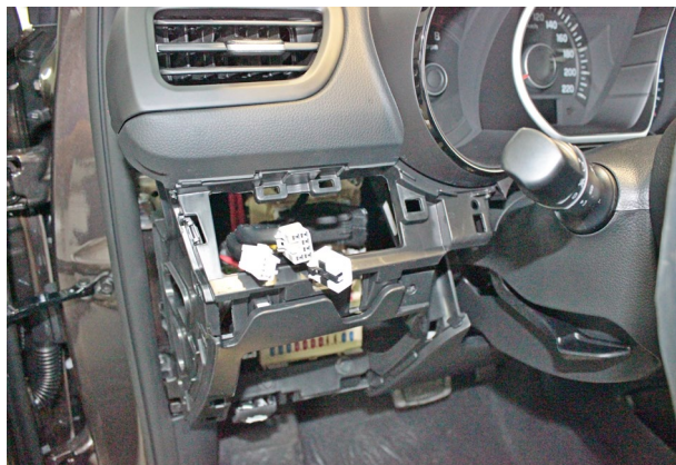
Фото 1.7. Блок кнопок управления снят
