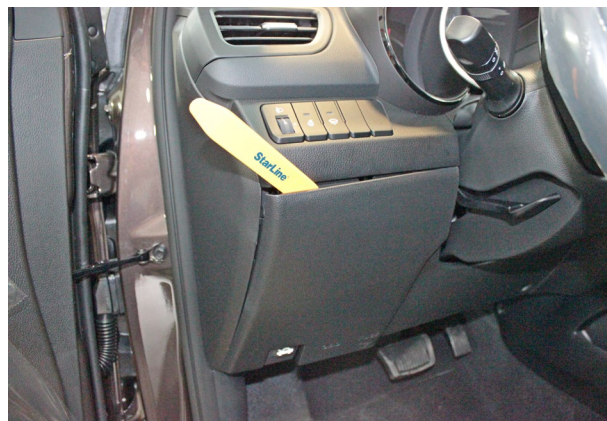
Фото 1.2. Снять крышку монтажного блока предохранителей
