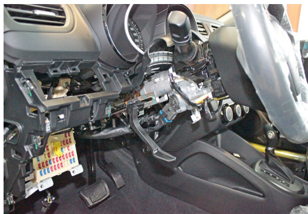
Фото 2.6. Кожух рулевого вала снят
