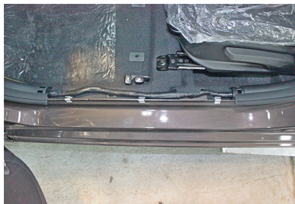
Фото 1.12. Накладка порога двери водителя снята
