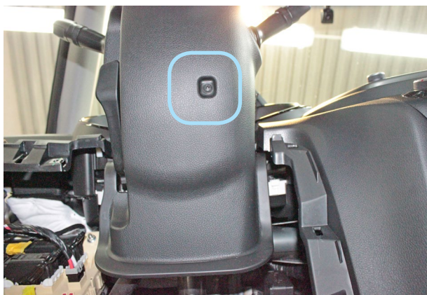
Фото 2.5. Саморез крепления нижней части кожану рулевого вала снизу
