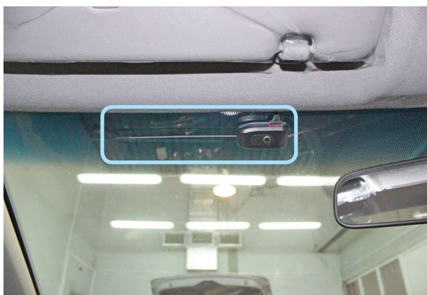
Фото 4.1. Возможное место установки антенного модуля
