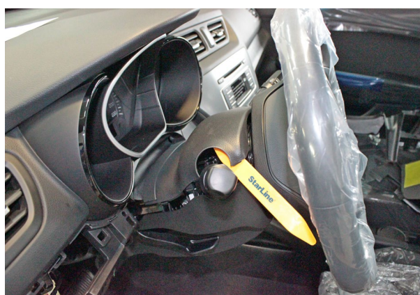
Фото 2.2. Снять верхнюю часть кожуха рулевого вала
