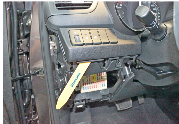
Фото 1.6. Снять блок кнопок слева от рулевой колонки
