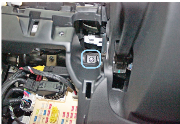
Фото 1.9. Гайка крепления пластиковой наклейки под рулевой колонкой
