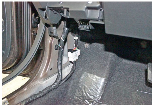
Фото 1.14. Накладка левой кик-панели снята
