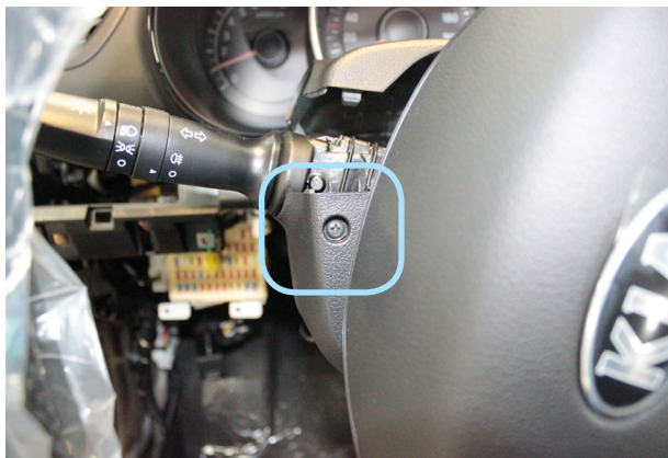
Фото 2.3. Саморез крепления нижней части кожану рулевого вала слева
