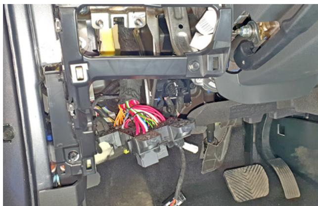
Фото 1.7. Монтажный блок предохранителей снят
