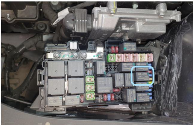
Фото 3.12. Местоположение реле стартера
