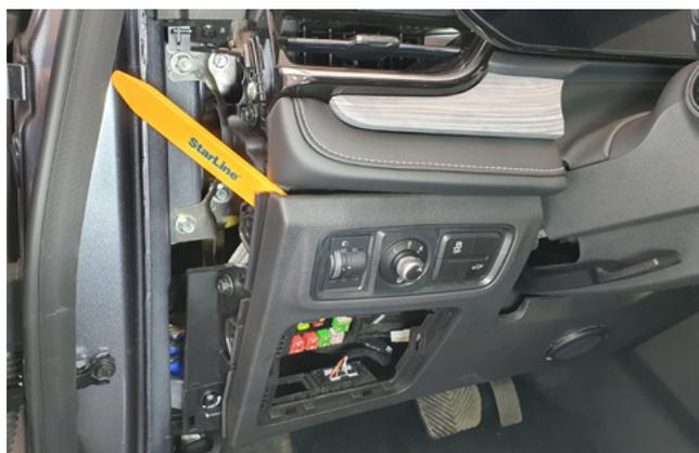
Фото 1.4. Снять пластиковую накладку под рулевой колонкой
