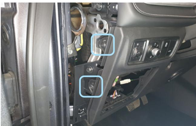
Фото 1.3. Саморезы крепления пластиковой накладки под рулевой колонкой
