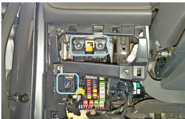
Фото 1.6. Гайки крепления монтажного блока предохранителей
