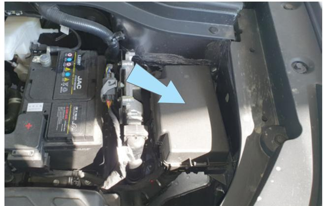
Фото 3.11. Монтажный блок предохранителей под капотом
