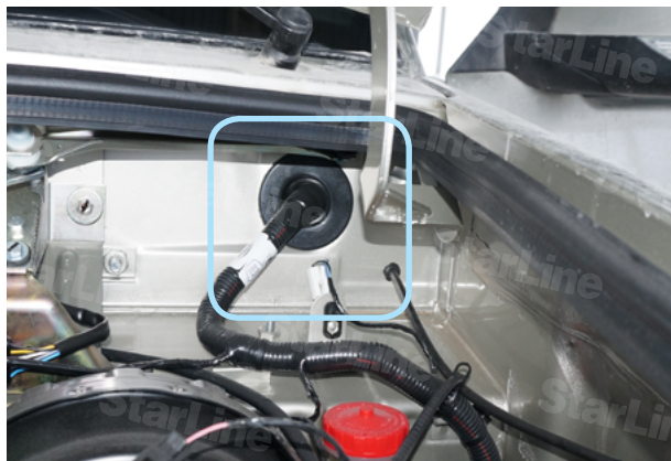
Фото 5.7. Штатный уплотнитель. Вид со стороны капота
