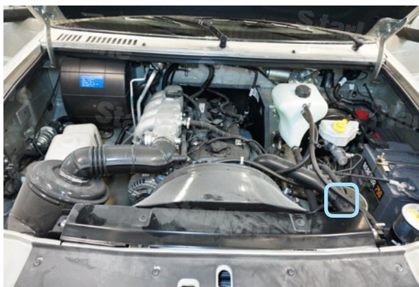
Фото 5.3. Место установки датчика температуры двигателя
