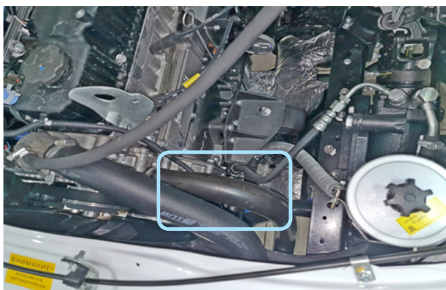
Фото 2.4. Место установки датчика температуры двигателя
