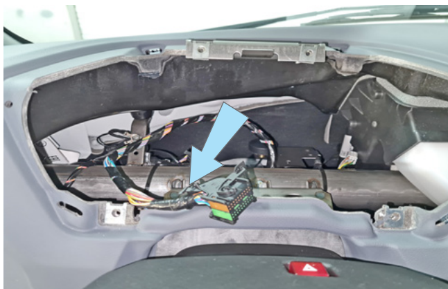
Фото 3.2. Местоположение жгута разъёма панели приборов
