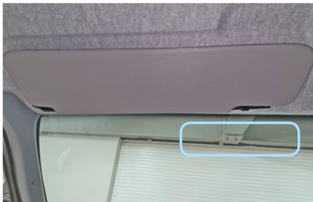
Фото 2.1. Возможное место установки антенного модуля
