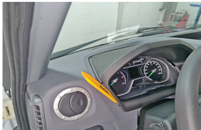
Фото 1.2. Снять декоративную накладку панели приборов
