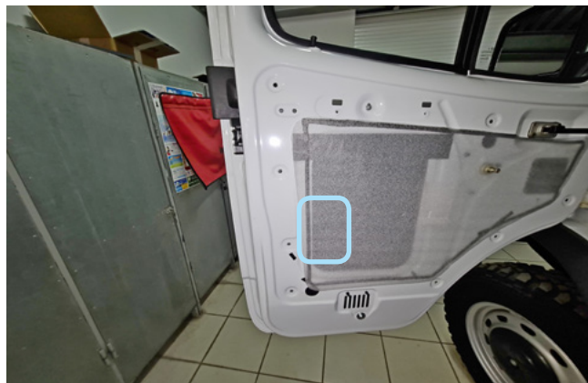
Фото 2.8. Место установки электропривода двери водителя
