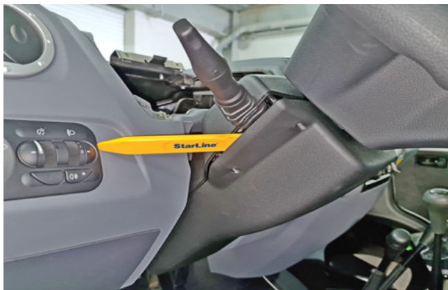
Фото 1.7. Снять кожух рулевого вала
