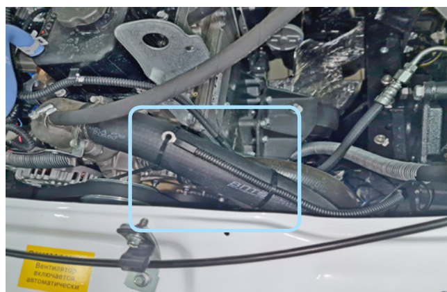
Фото 2.5. Крепление датчика температуры двигателя
