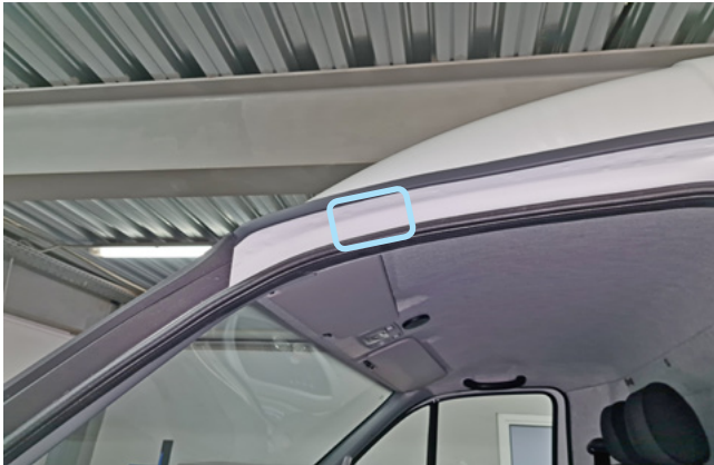
Фото 2.9. Возможное место установки концевика двери
