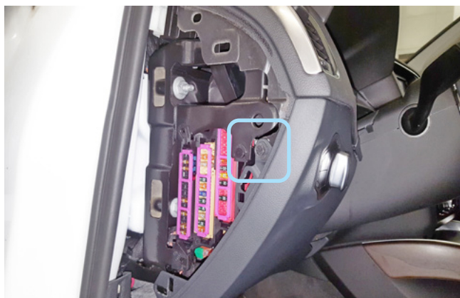
Фото 1.3. Боковая накладка снята. Саморез
