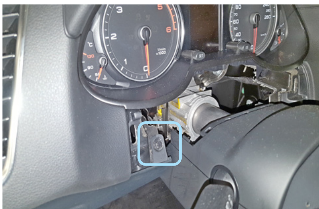
Фото 1.5. Накладка снята. Саморез
