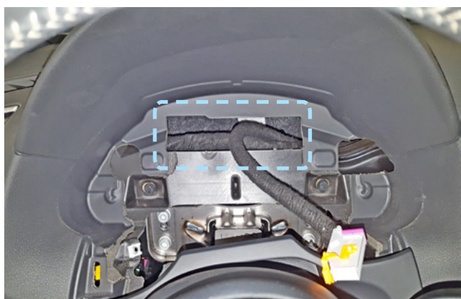
Фото 2.9. Пример расположения центрального блока охранно-телематического комплекса
