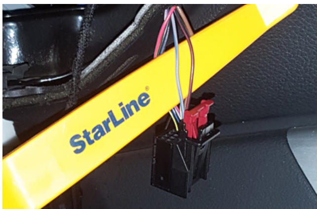
Фото 3.5. Управление запуском и остановкой двигателя (серо-голубой и чёрно-красный)
