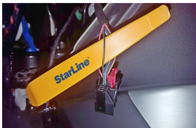
Фото 3.4. Сигнал «ключ в слоте для запуска двигателя» (чёрно-жёлтый)
