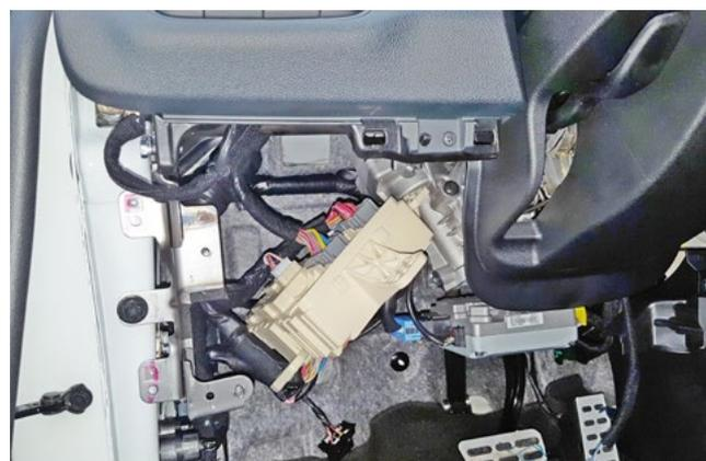
Фото 1.11. Монтажный блок предохранителей снят
