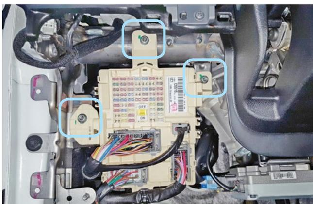
Фото 1.10. Крепление монтажного блока предохранителей
