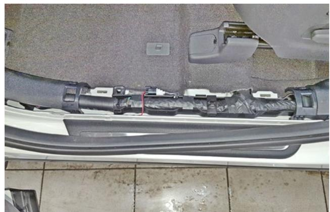
Фото 1.4. Накладка порога двери водителя снята
