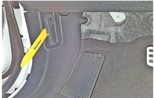
Фото 1.2. Снять ручку отпирания капота
