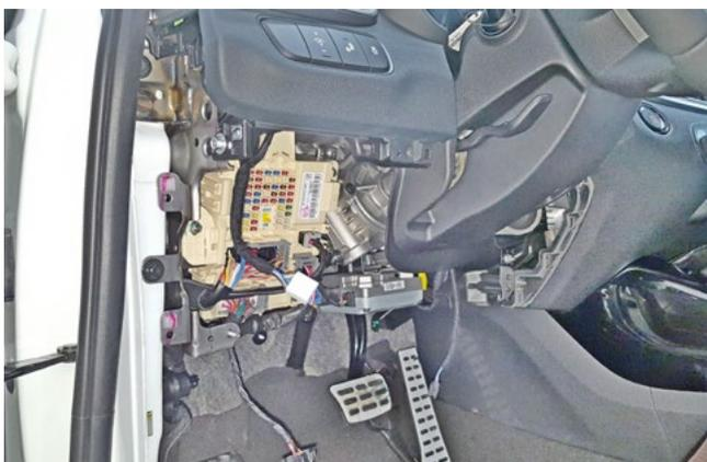
Фото 1.9. Пластиковая накладка под рулевой колонкой снята
