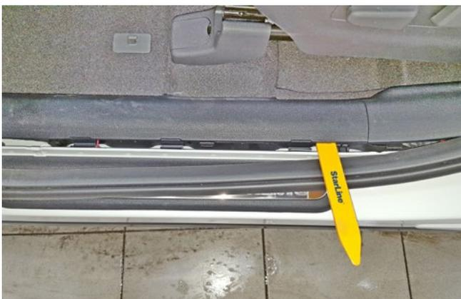
Фото 1.3. Снять накладку порога двери водителя
