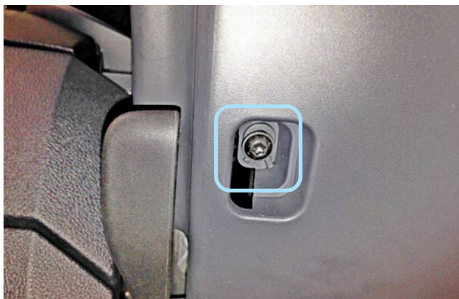
Фото 1.7. Винт крепления нижней части кожуха рулевого вала снизу
