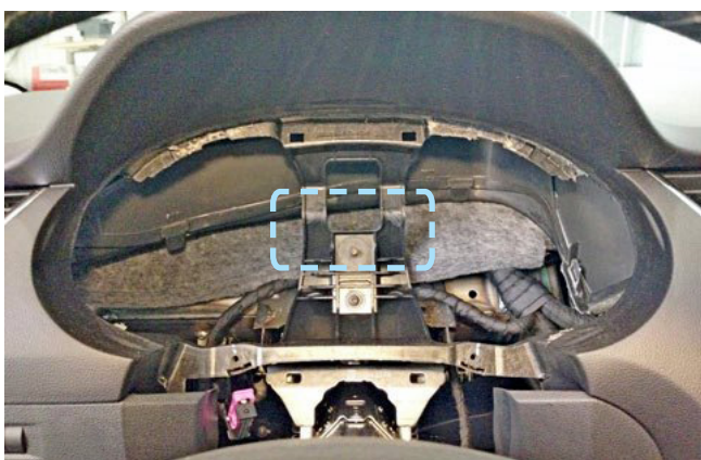
Фото 2.7. Пример расположения центрального блока охранно-телематического комплекса
