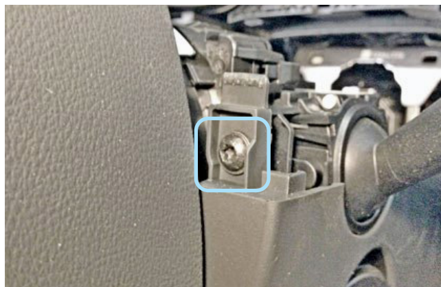
Фото 1.6. Винт крепления нижней части кожуха рулевого вала справа
