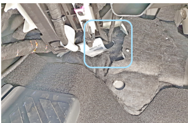
Фото 2.6. Штатный уплотнитель. Вид со стороны салона
