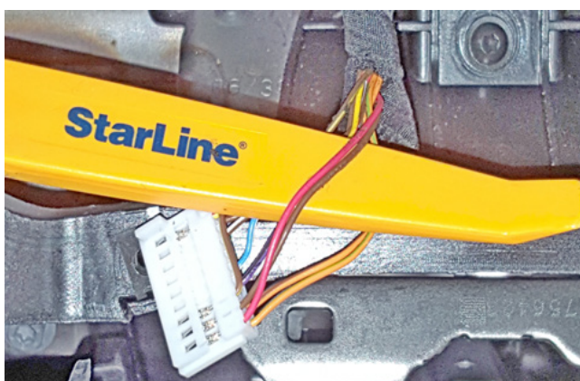
Фото 3.13. Провода антенны штатного иммобилайзера (красный и коричневый)
