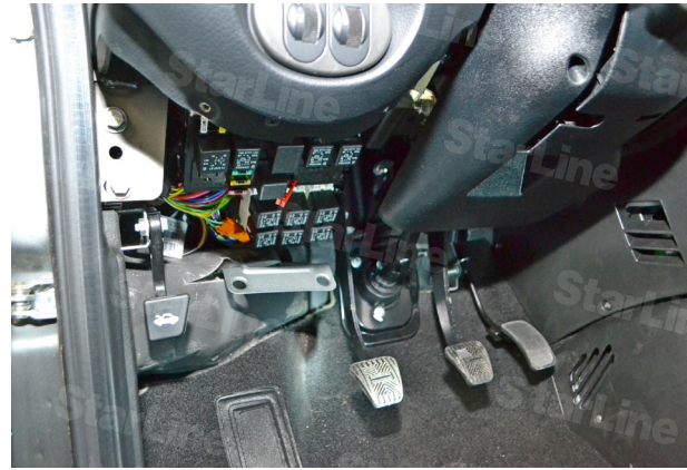
Фото 3.2. Пластиковая накладка снята
