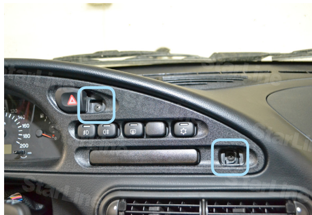
Фото 2.2. Саморезы крепления декоративной накладке панели приборов
