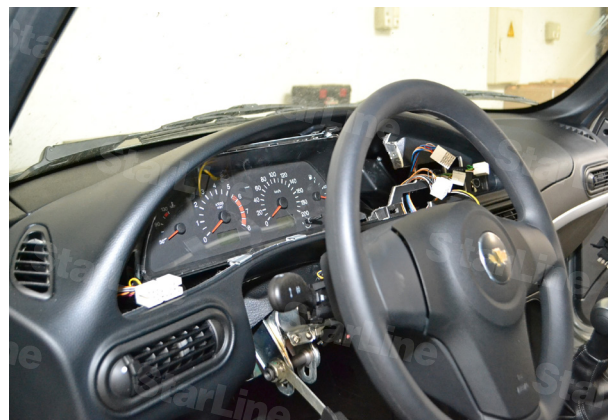
Фото 2.4. Декоративная накладке панели приборов снята
