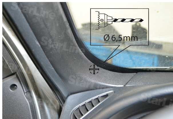
Фото 4.2. Место установки светодиода
