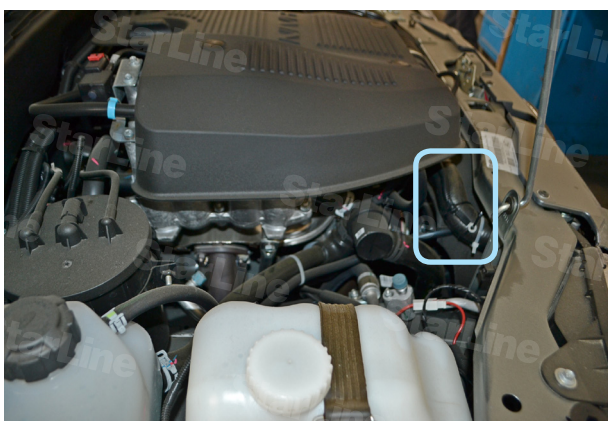
Фото 5.3. Место установки датчика температуры двигателя
