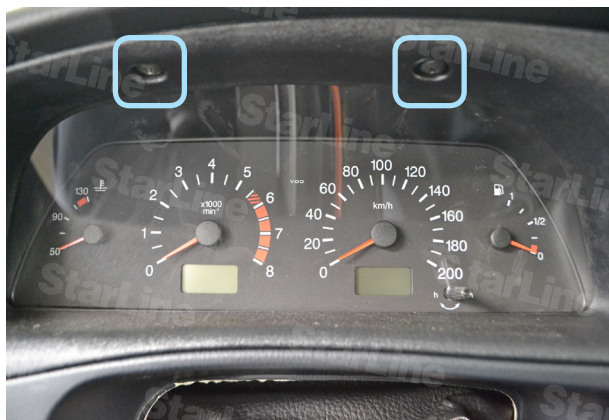
Фото 2.3. Саморезы крепления декоративной накладке панели приборов
