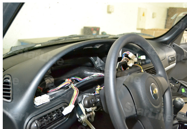
Фото 2.6. Панель приборов снята
