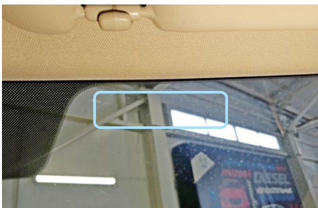
Фото 2.1. Возможное место установки антенного модуля
