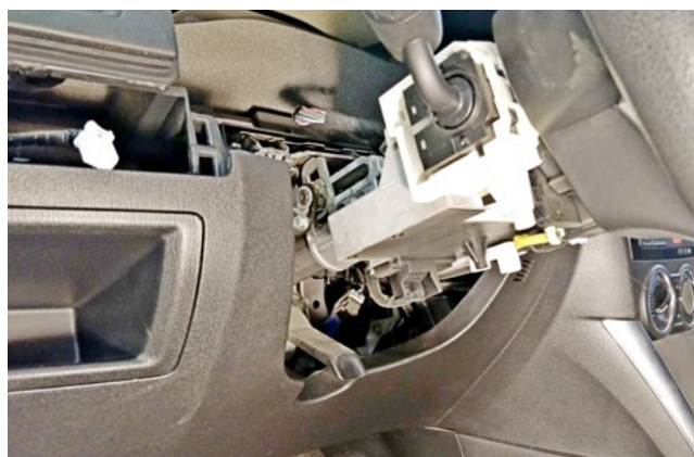
Фото 1.13. Нижняя часть кожуха рулевого вала снята
