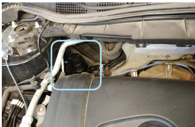
Фото 2.3. Возможное место установки сирены
