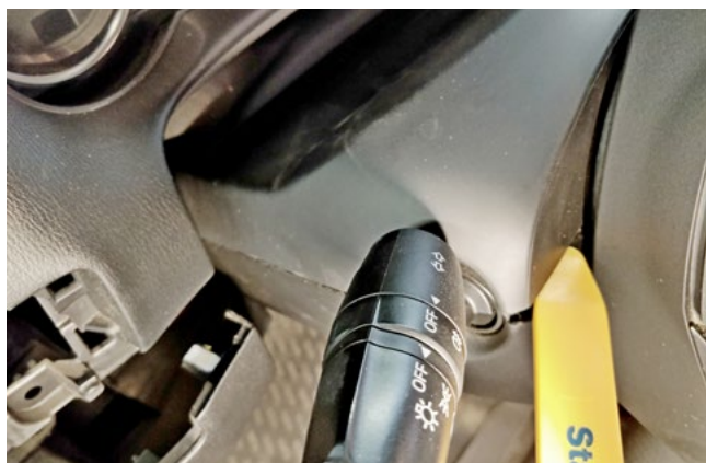
Фото 1.7. Снять верхнюю часть кожуа рулевого вала
