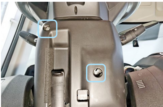
Фото 1.12. Саморезы крепления нижней части кожуха рулевого вала
