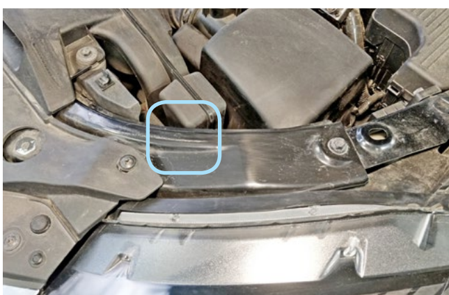
Фото 2.7. Возможное место установки концевика капота
