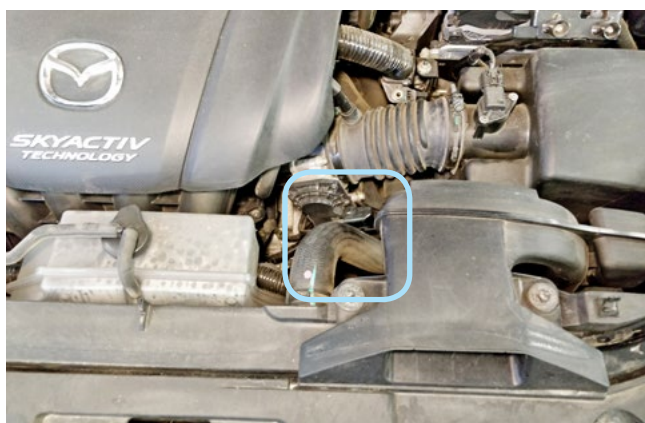
Фото 2.5. Место установки датчика температуры двигателя
