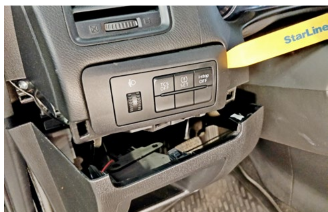
Фото 1.6. Левая часть накладки под рулевой колонкой снята. Снять блок кнопок
