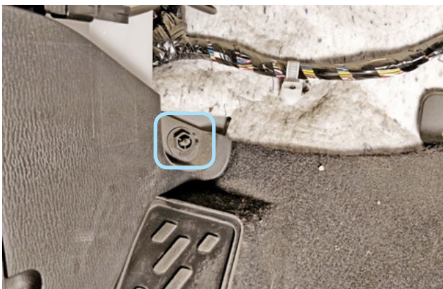
Фото 1.3. Клипса крепления накладки левой кик-панели
