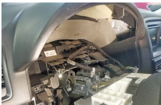
Фото 1.11. Панель приборов снята
