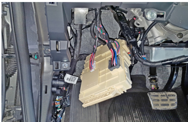
Фото 1.13. Монтажный блок предохранителей снят
