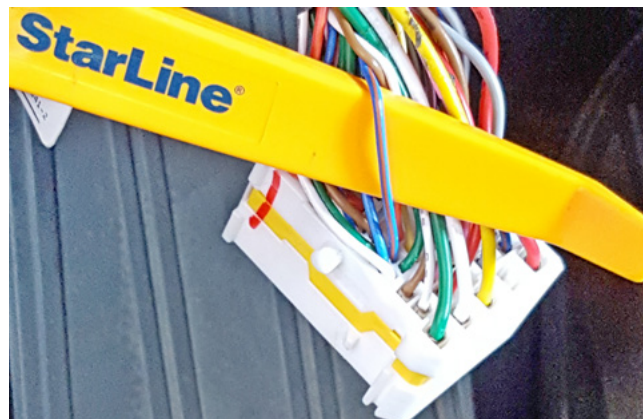
Фото 3.7. Шина данных штатного иммобилайзера (сине-оранжевый)
