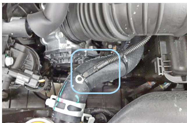
Фото 2.4. Крепление датчика температуры двигателя
