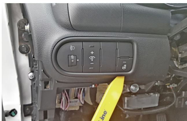
Фото 1.11. Снять блок кнопок слева от рулевой колонки
