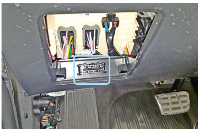
Фото 3.4. Местоположение диагностического разъёма
