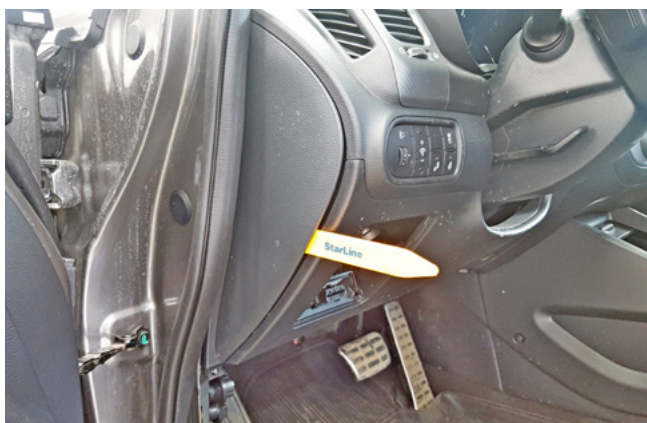
Фото 1.7. Снять боковую накладку передней панели
