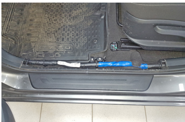
Фото 1.5. Накладка порога двери водителя снята
