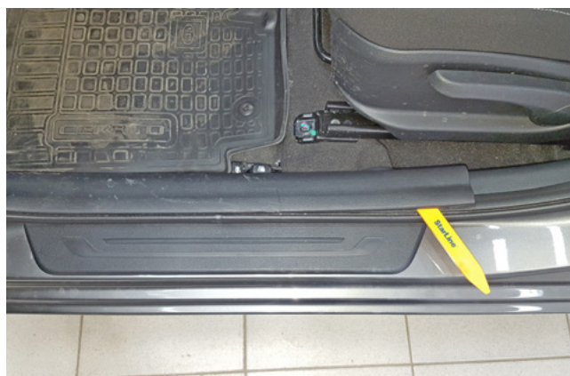
Фото 1.4. Снять накладку порога двери водителя
