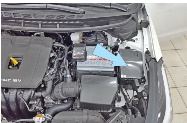
Фото 2.6. Возможное место установки подкапотного блока R6
