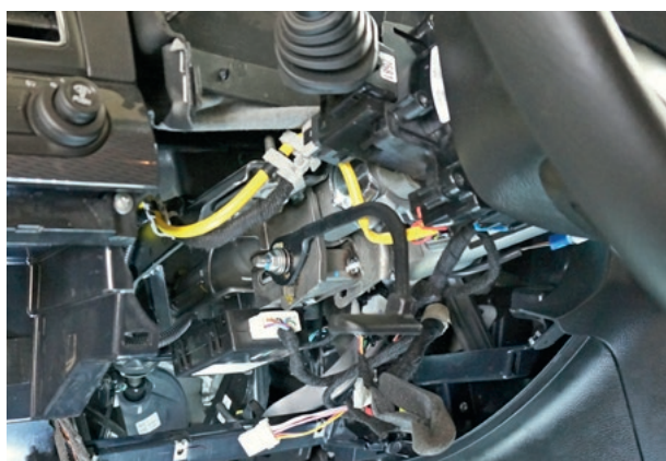
Фото 3.5. Кожух рулевого вала снят
