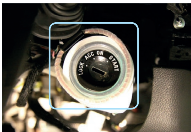
Фото 13. Расположение антенны модуля BP-03 на замке зажигания
