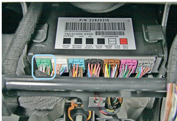
Фото 10.1. Местоположение зелёного (GREEN) разъёма блока BCM
