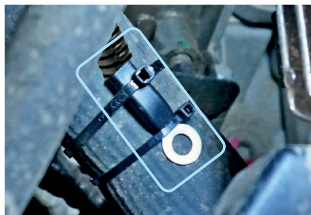
Фото 5.4. Крепление датчика температуры двигателя
