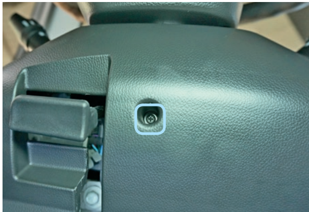
Фото 3.1. Винт крепления кожуха рулевого вала
