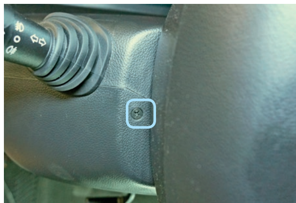
Фото 3.2. Саморез крепления кожуха рулевого вала
