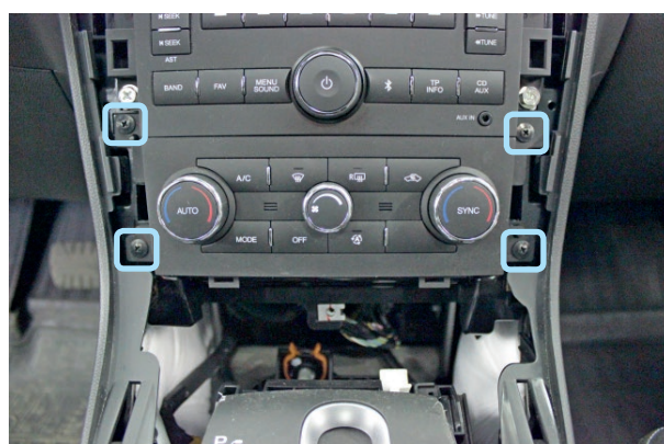
Фото 2.4. Саморезы крепления блока управления климат-контролем
