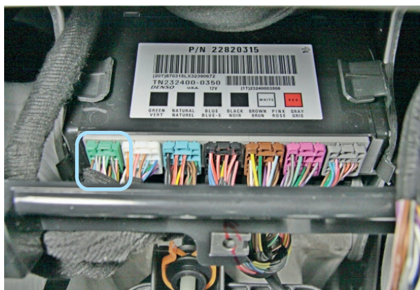
Фото 9.1. Местоположение зелёного (GREEN) разъёма блока BCM
