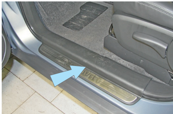
Фото 1.2. Накладка порога двери водителя
