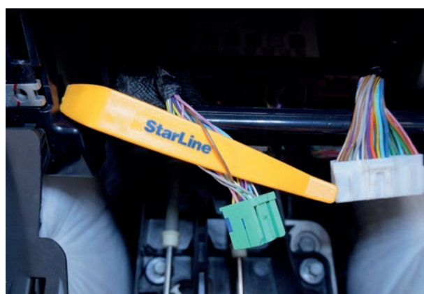
Фото 9.2. Управление световыми сигналами (коричневый)
