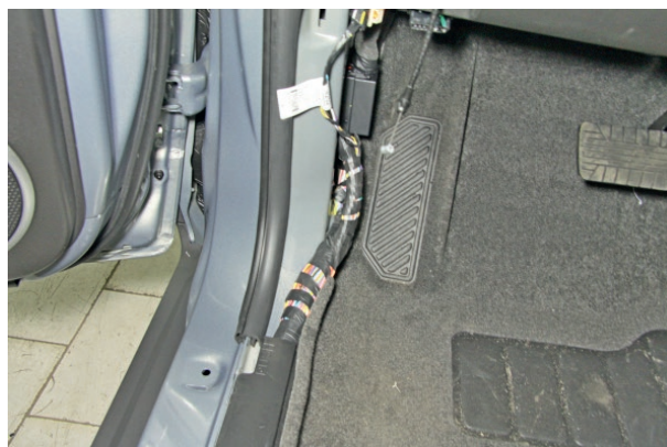
Фото 1.4. Накладка левой кик-панели снята
