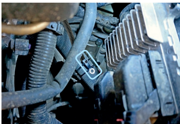
Фото 5.3. Место установки датчика температуры двигателя
