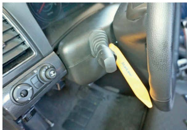
Фото 3.4. Снять верхнюю часть кожуха
