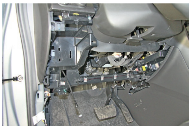
Фото 1.6. Пластиковая накладка под рулевой колонкой снята
