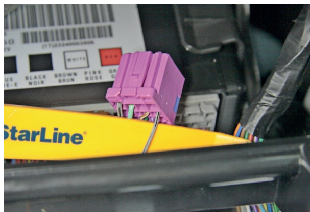
Фото 12.2. Концевик двери водителя (серо-чёрный)
