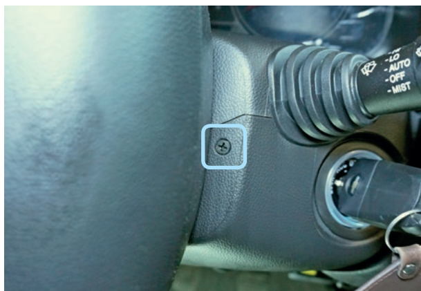
Фото 3.3. Саморез крепления кожуха рулевого вала
