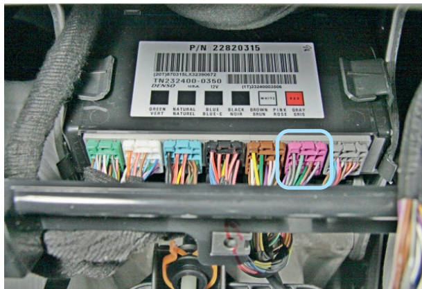
Фото 12.1. Местоположение розового (PINK) разъёма блока BCM
