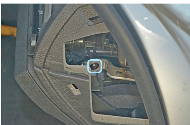
Фото 1.9. Саморез крепления перчаточного ящика
