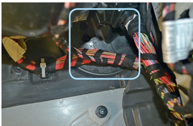
Фото 2.9. Штатный уплотнитель. Вид со стороны салона
