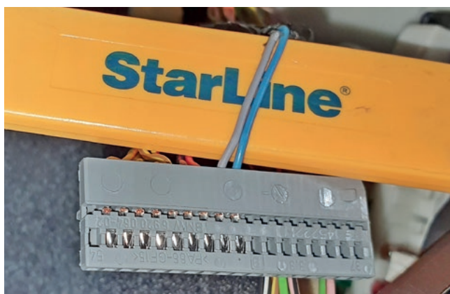
Фото 3.4. Шина CAN-B (серый и синий)
