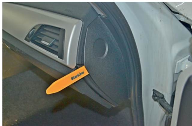
Фото 1.2. Снять правую накладку передней панели
