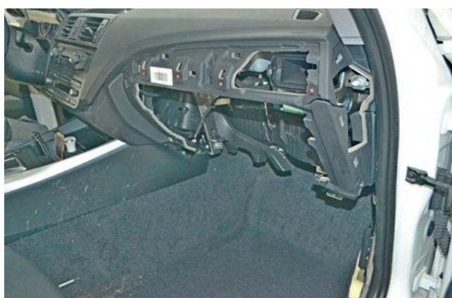
Фото 1.10. Перчаточный ящик снят
