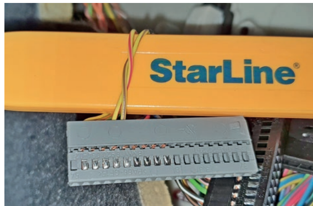
Фото 3.3. Шина CAN-A (жёлто-красный и жёлто-коричневый)
