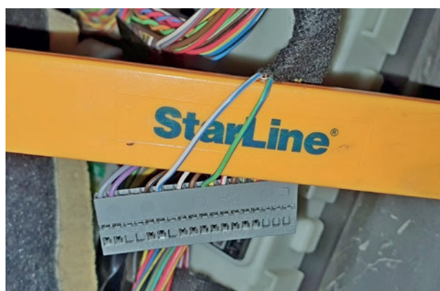
Фото 3.6. Управление кнопкой Старт-Стоп (белосиний и зелёно-синий)
