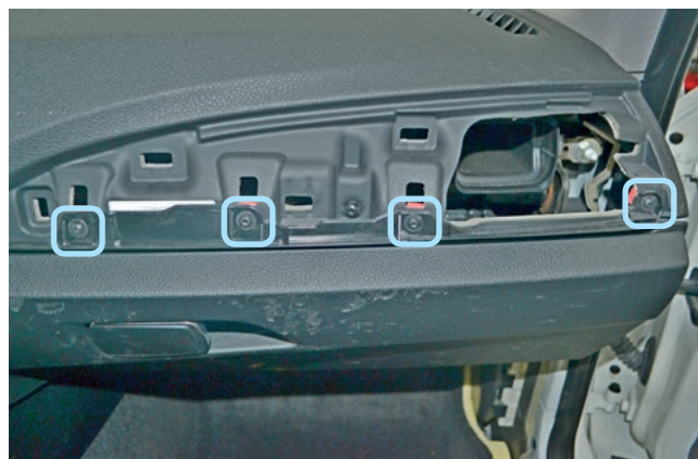
Фото 1.8. Саморезы крепления перчаточного ящика
