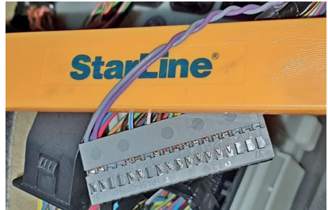
Фото 3.11. Провод штатной антенны иммобилайзера (серый и фиолетовый)
