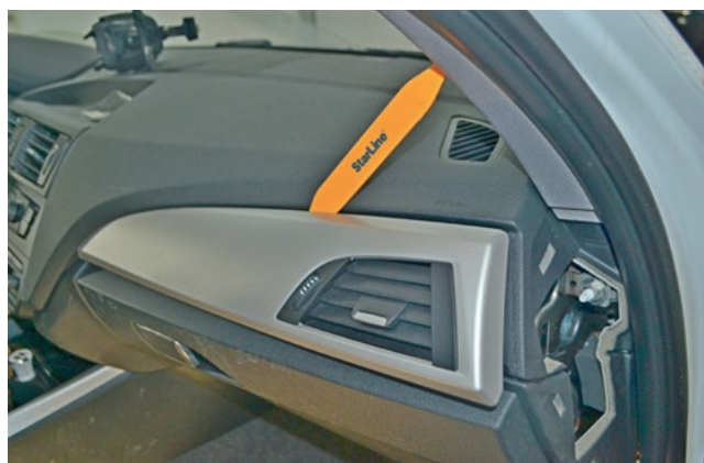
Фото 1.4. Снять декоративную накладку передней панели
