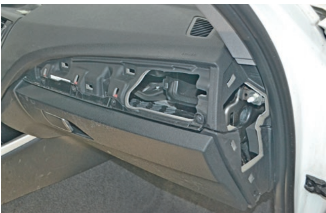
Фото 1.5. Декоративная накладка передней панели снята
