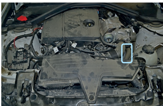
Фото 2.3. Место установки датчика температуры двигателя
