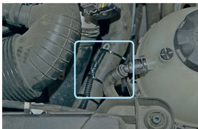
Фото 2.4. Крепление датчика температуры двигателя
