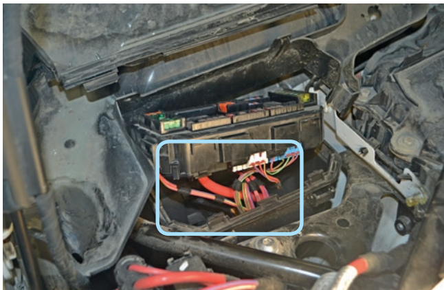
Фото 2.5. Возможное место установки модуля R6
