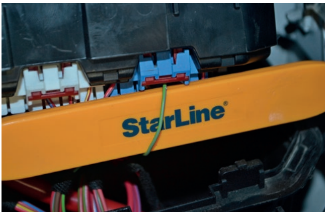
Фото 2.7. Подключение цепи зажигания R6 (зелёно-серый)
