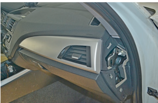
Фото 1.3. Правая накладка передней панели снята
