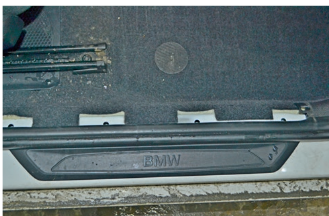
Фото 1.12. Накладка порога передней правой двери снята
