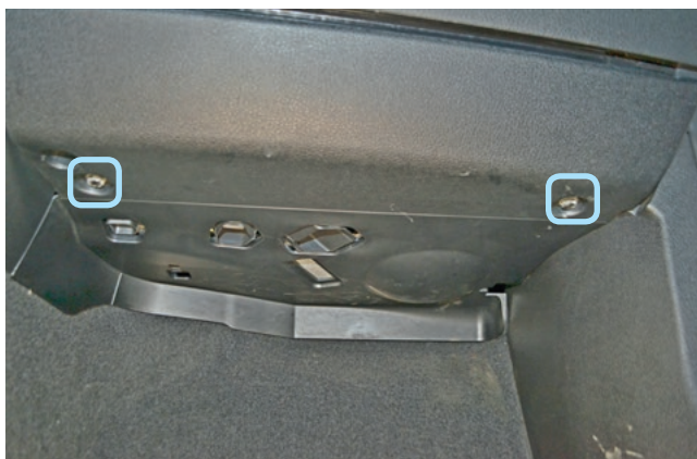
Фото 1.6. Болты крепления накладки под перчаточным ящиком
