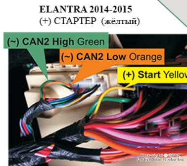
Местоположение разъёма с обратной стороны монтажного блока предохранителей
