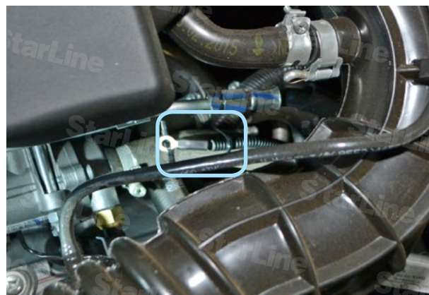
Фото 5.4. Крепление датчика температуры двигателя
