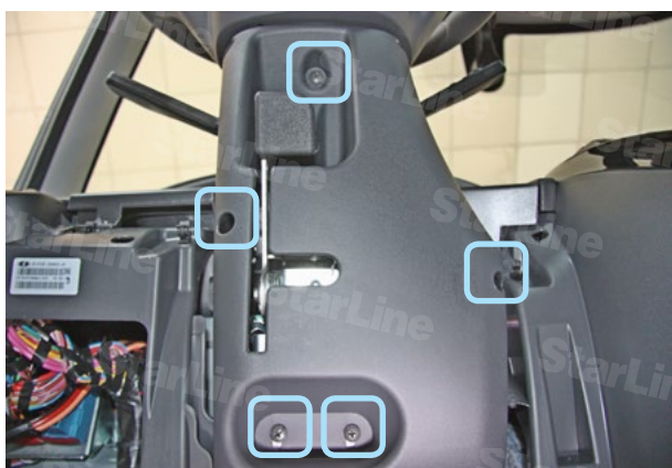
Фото 2.5. Крепление нижней части рулевого кожуха
