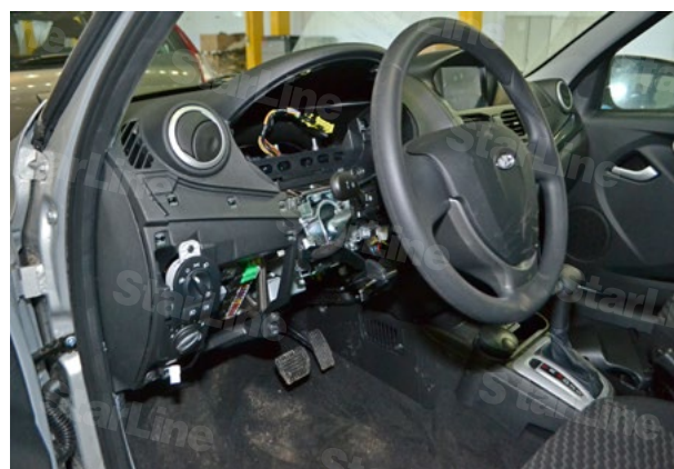
Фото 3.6. Панель приборов снята
