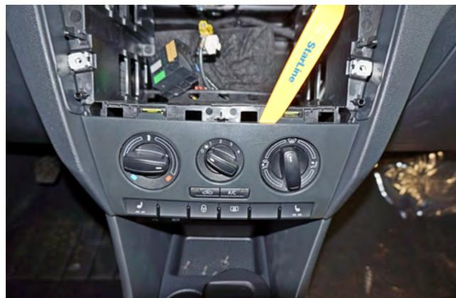
Фото 1.8. Снять декоративную накладку блока управления климат-контролем
