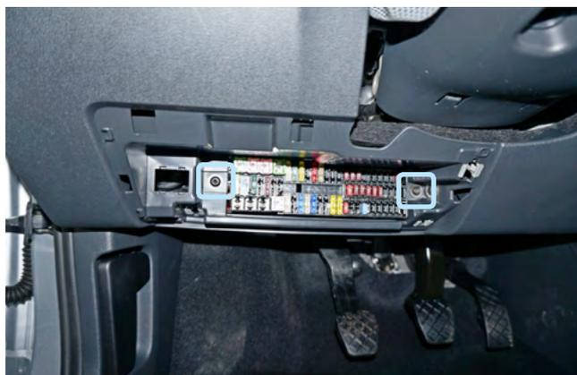
Фото 1.13. Винты крепления блока предохранителей
