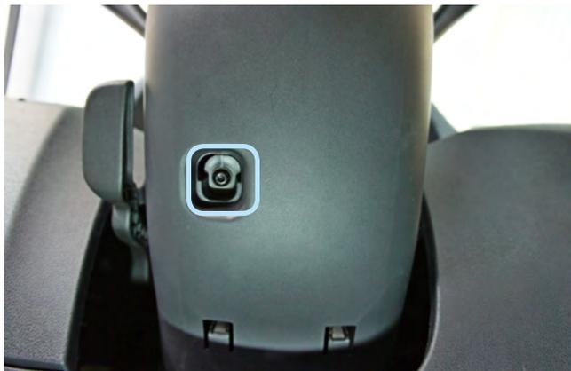
Фото 1.2. Винт крепления нижней части кожуха
