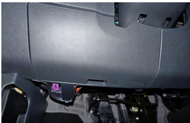
Фото 1.12. Крышка монтажного блока предохранителей
