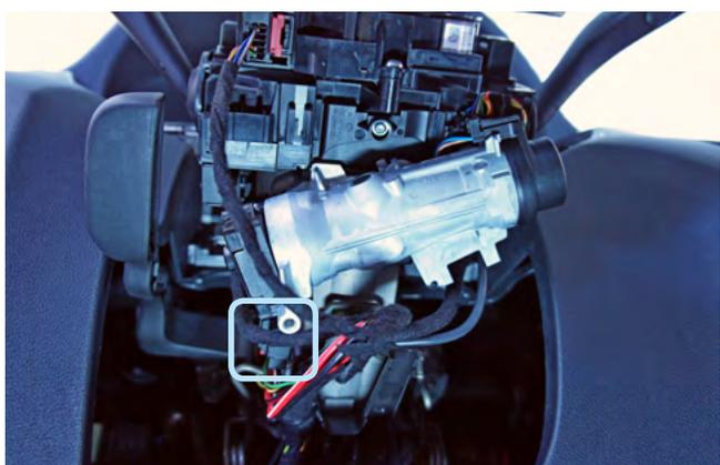
Фото 3.10. Местоположение разъёма
