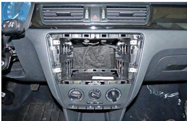
Фото 1.7. Магнитола снята
