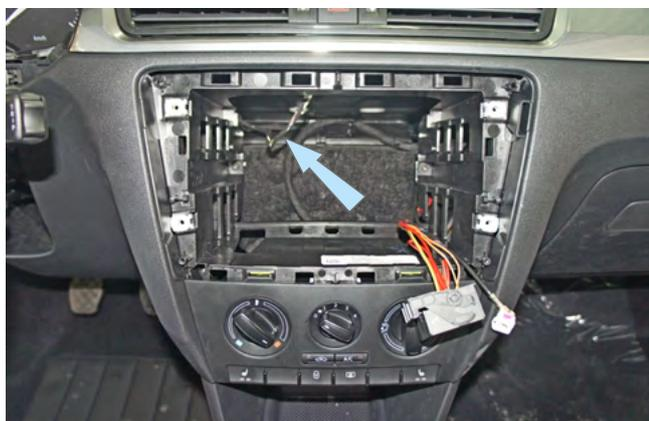
Фото 3.6. Местоположение жгута разъёма кнопки аварийной сигнализации
