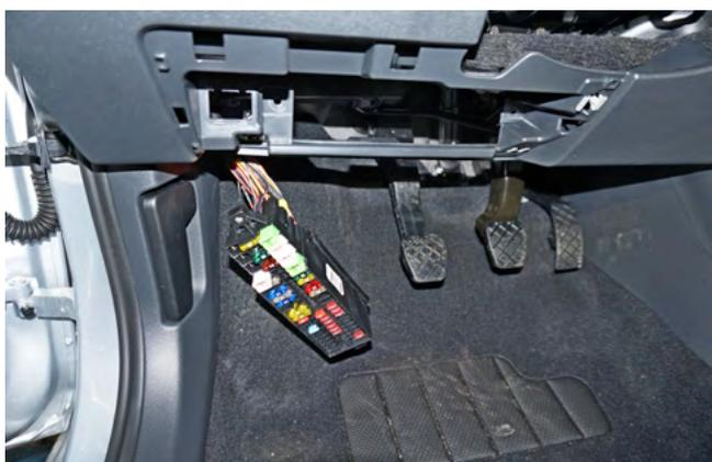
Фото 1.14. Монтажный блок предохранителей снят
