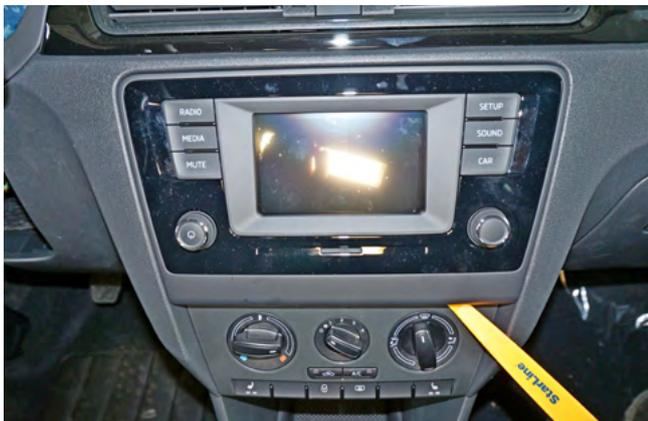
Фото 1.5. Снять декоративную накладку
