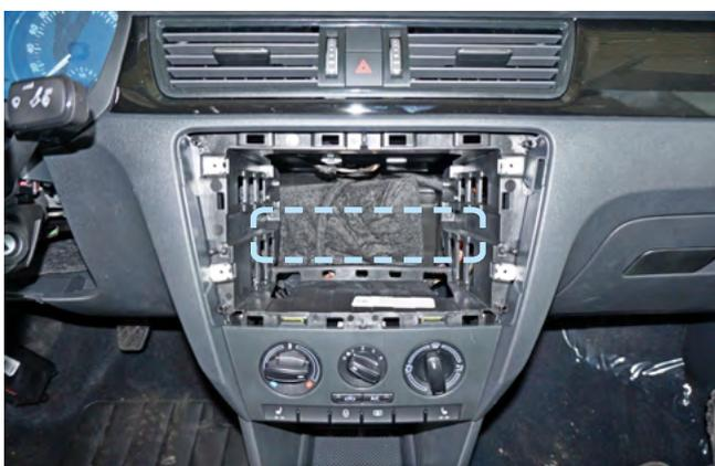
Фото 2.8. Пример расположения центрального блока охранно-телематического комплекса
