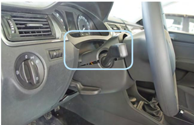
Фото 1.1. Верхняя часть кожуха рулевого вала
