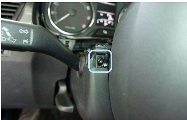
Фото 1.3. Винт крепления нижней части кожуха
