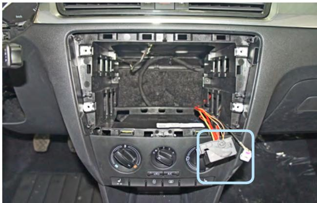
Фото 3.2. Местоположение разъёма магнитолы
