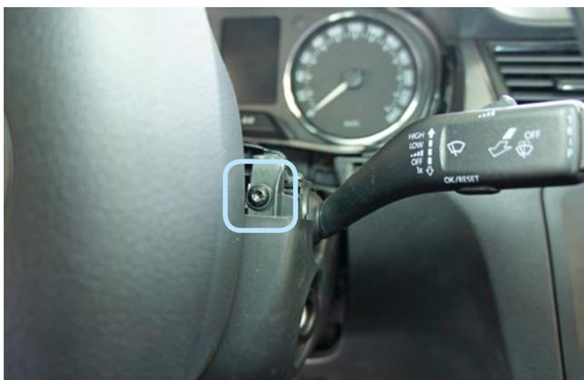
Фото 1.4. Винт крепления нижней части кожуха
