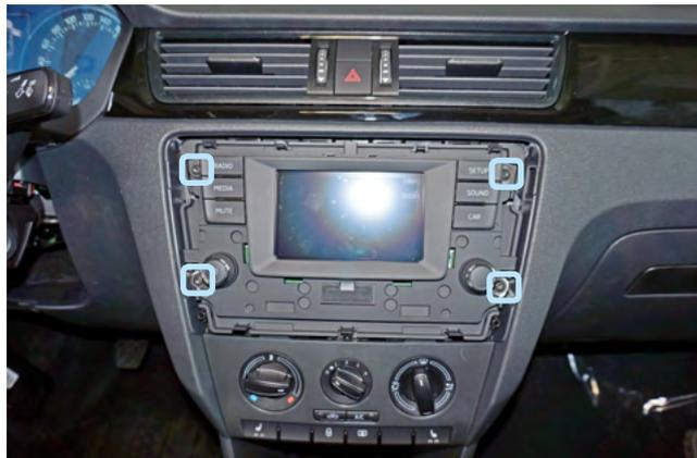
Фото 1.6. Декоративная накладка снята. Саморезы
