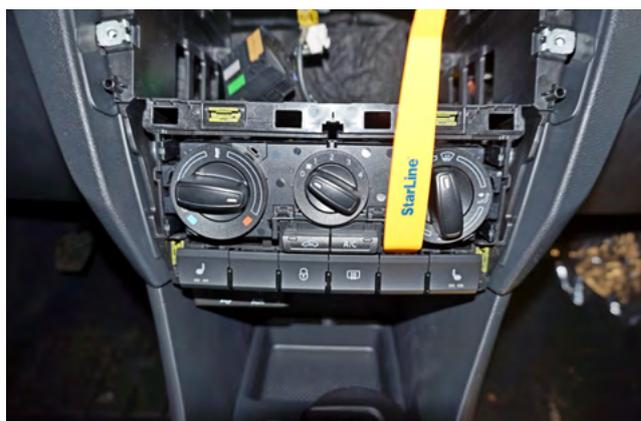
Фото 1.10. Снять блок кнопок
