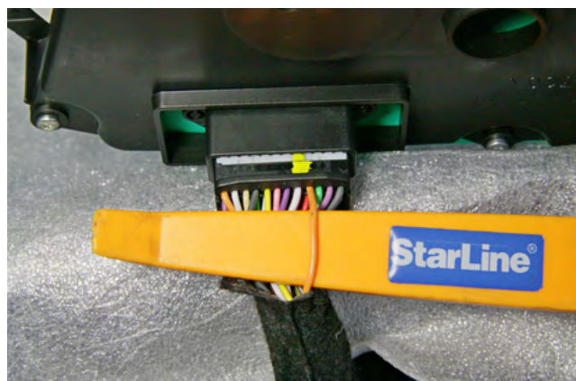
Фото 3.3. Контроль работы двигателя (оранжевый)
