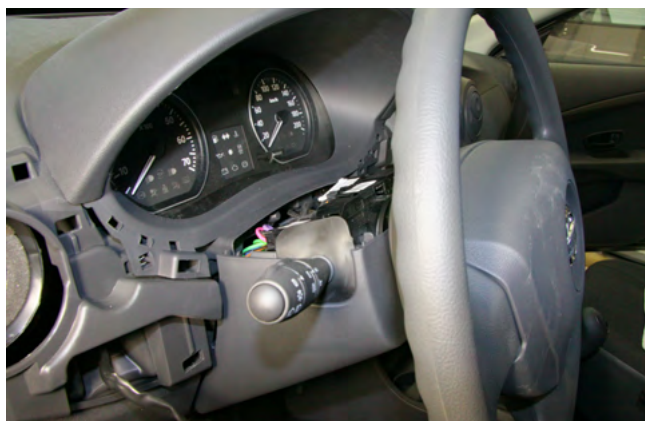
Фото 1.9. Верхняя часть кожуха снята
