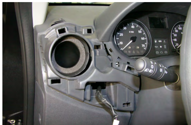
Фото 1.2. Декоративная накладка с воздуховодом снята
