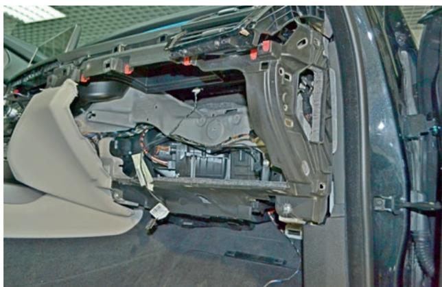
Фото 1.17. Перчаточный ящик снят
