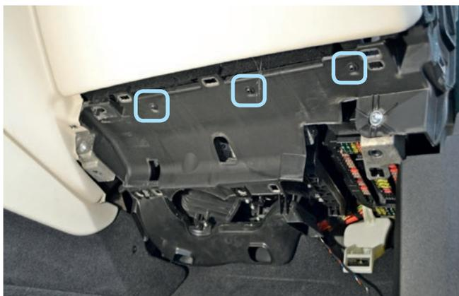
Фото 1.14. Саморезы крепления перчаточного ящика
