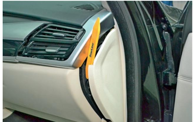
Фото 1.2. Снять правую накладку передней панели
