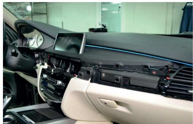
Фото 1.6. Декоративная накладка передней панели снята
