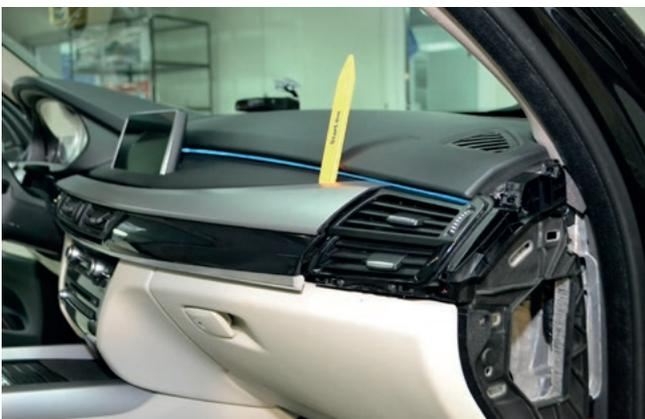
Фото 1.5. Снять декоративную накладку передней панели. Накладка правого воздуховода снята
