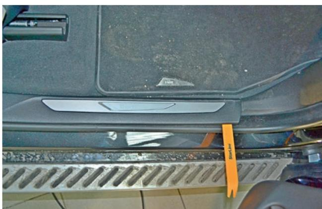
Фото 1.18. Снять накладку порога передней правой двери
