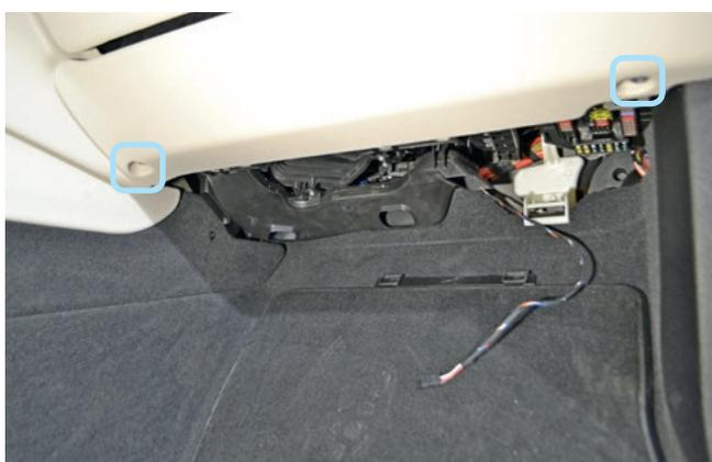
Фото 1.11. Саморезы крепления декоративной накладки. Нижняя пластиковая накладка снята
