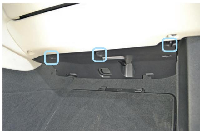
Фото 1.10. Фиксаторы крепления пластиковой накладки
