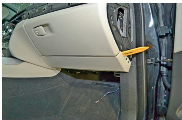
Фото 1.12. Снять декоративную накладку под перчаточным ящиком
