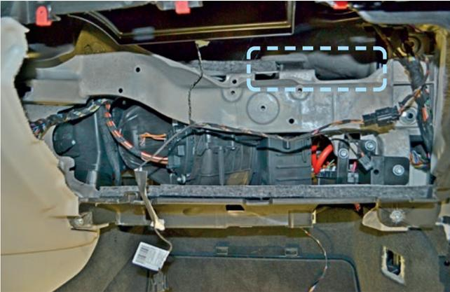
Фото 2.11. Пример расположения центрального блока охранно-телематического комплекса
