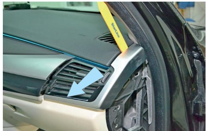
Фото 1.4. Снять накладку правого воздуховода
