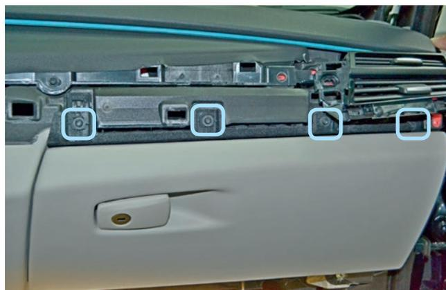
Фото 1.15. Саморезы крепления перчаточного ящика
