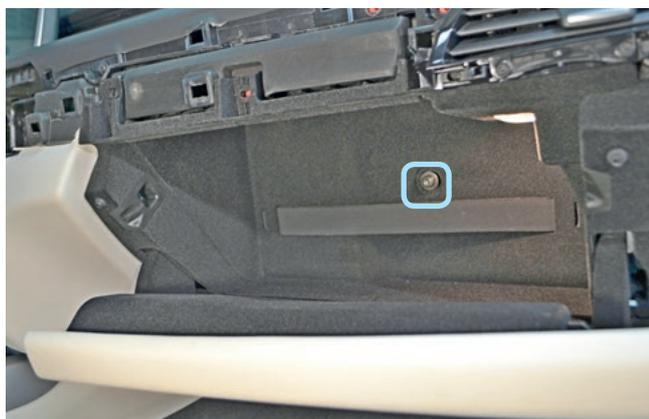
Фото 1.16. Саморез крепления перчаточного ящика
