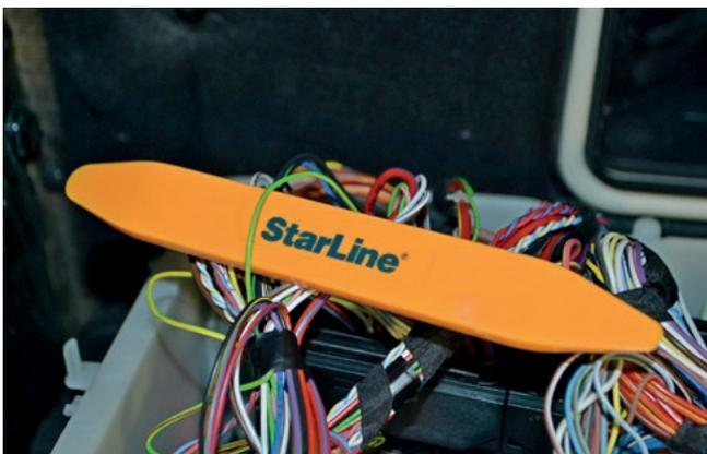
Фото 2.9. Подключение цепи зажигания R6 (зелёно-жёлтый)
