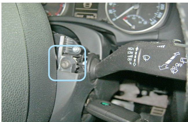
Фото 1.10. Винт крепления нижней части кожуха рулевого вала справа
