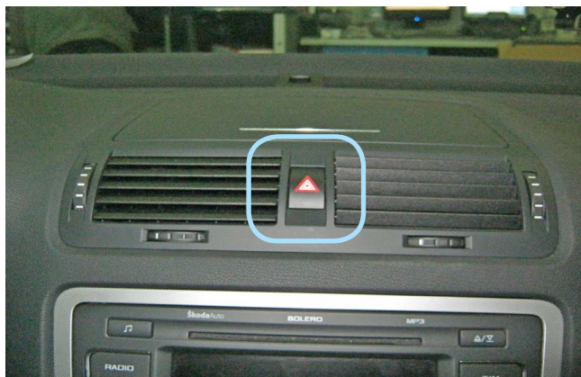
Фото 3.3. Местоположение кнопки аварийной сигнализации
