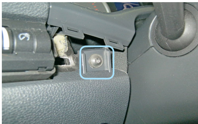
Фото 1.3. Накладка снята. Саморез
