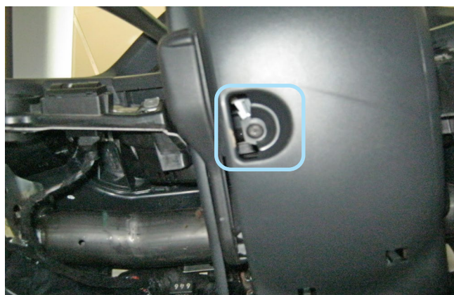
Фото 1.11. Винт крепления нижней части кожуха рулевого вала снизу
