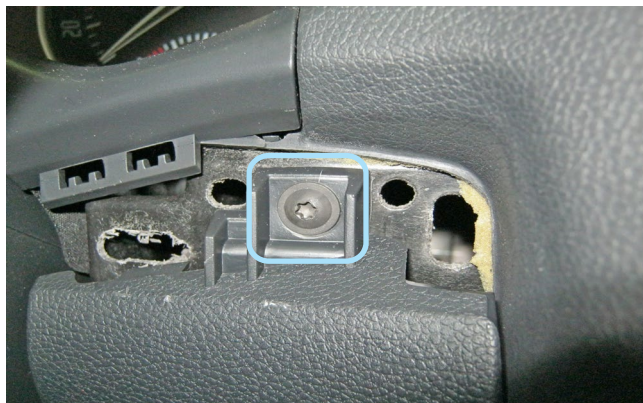
Фото 1.4. Накладка снята. Саморез
