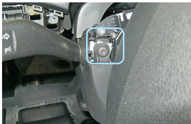
Фото 1.9. Винт крепления нижней части кожуха рулевого вала слева
