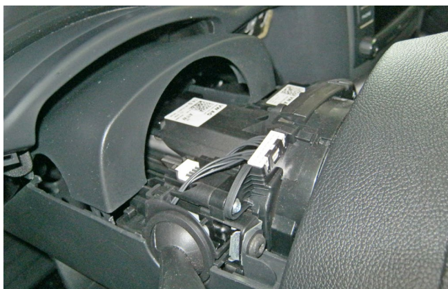
Фото 1.8. Верхняя часть кожуха снята
