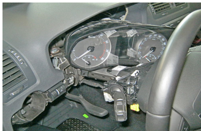
Фото 1.15. Панель приборов снята
