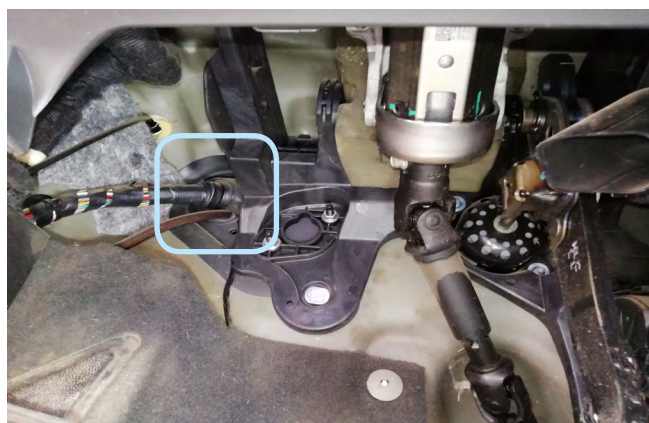
Фото 2.6. Штатный уплотнитель. Вид со стороны салона
