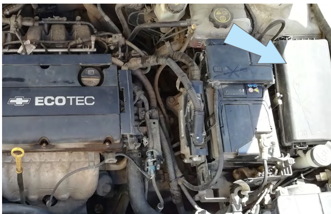
Фото 2.7. Возможное место установки подкапотного блока R6
