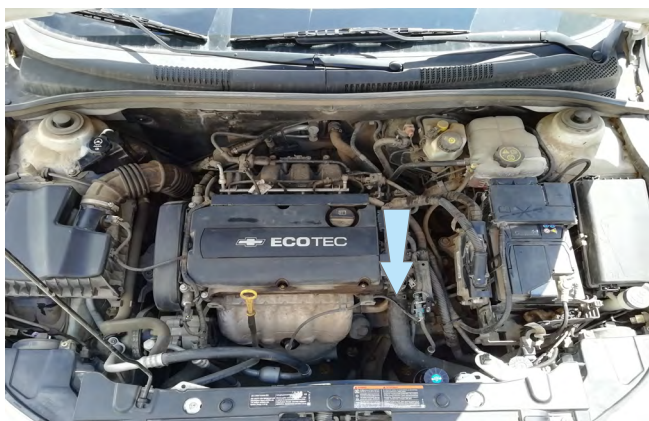
Фото 2.4. Место установки датчика температуры двигателя
