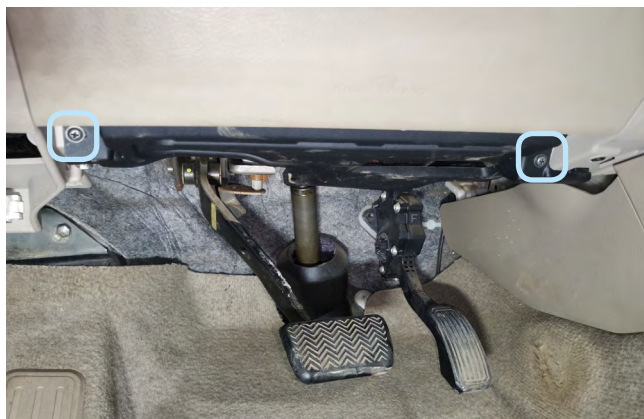
Фото 1.4. Саморез крепления накладки педального узла
