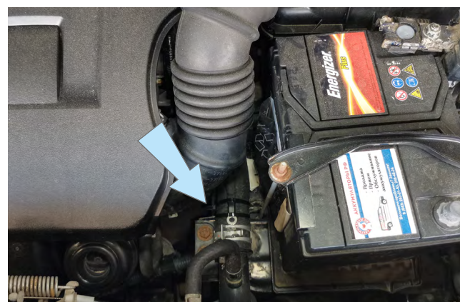
Фото 2.5. Крепление датчика температуры двигателя
