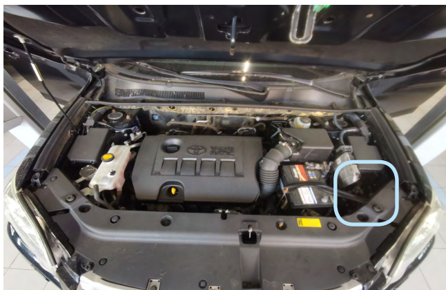
Фото 2.2. Возможное место установки сирены
