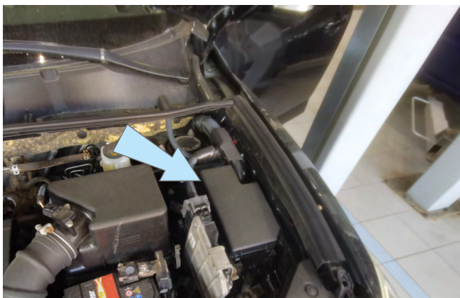
Фото 2.7. Возможное место установки подкапотного блока R6
