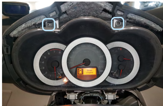
Фото 1.2. Накладка снята. Саморезы крепления панели приборов
