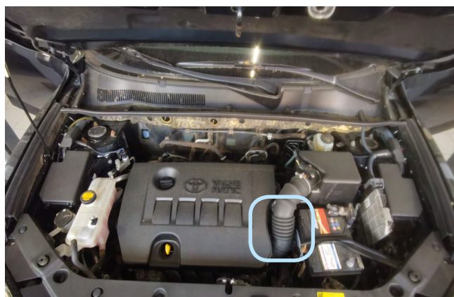
Фото 2.4. Место установки датчика температуры двигателя
