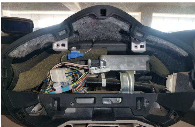
Фото 1.3. Панель приборов снята
