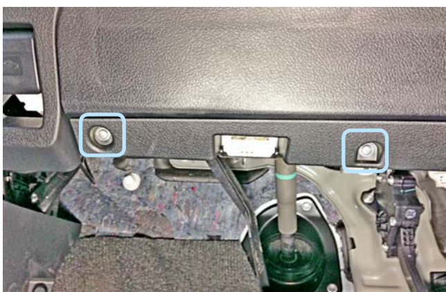
Фото 1.15. Саморезы крепления декоративной накладки под подушкой безопасности
