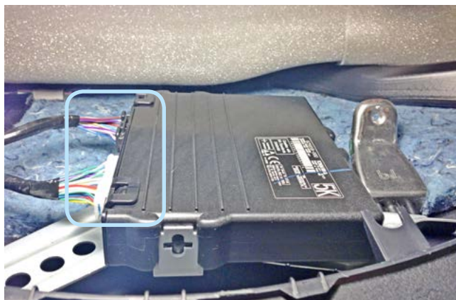
Фото 3.2. Местоположение блока сертификации. Разъёмы
