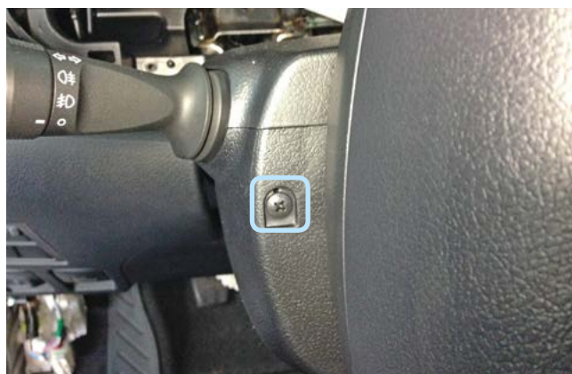
Фото 1.10. Саморез крепления кожуха рулевого вала слева
