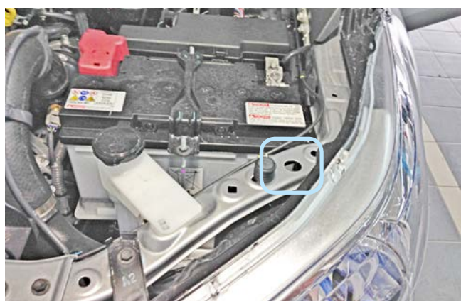
Фото 2.7. Возможное место установки концевика капота
