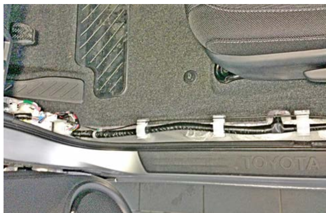
Фото 1.3. Накладки порога и кик-панели сняты
