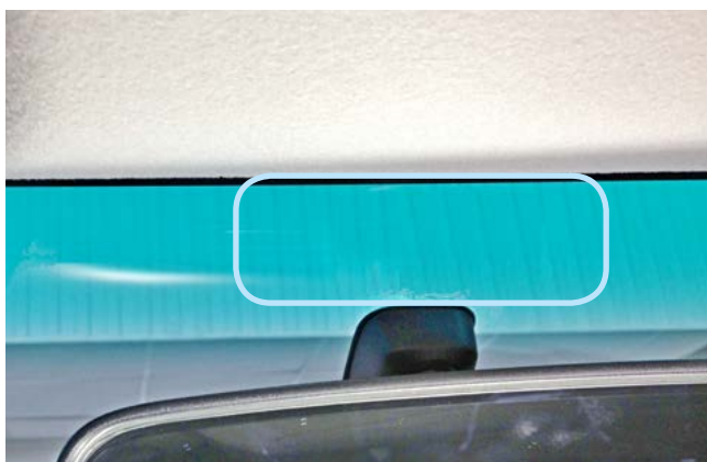
Фото 2.1. Возможное место установки антенного модуля
