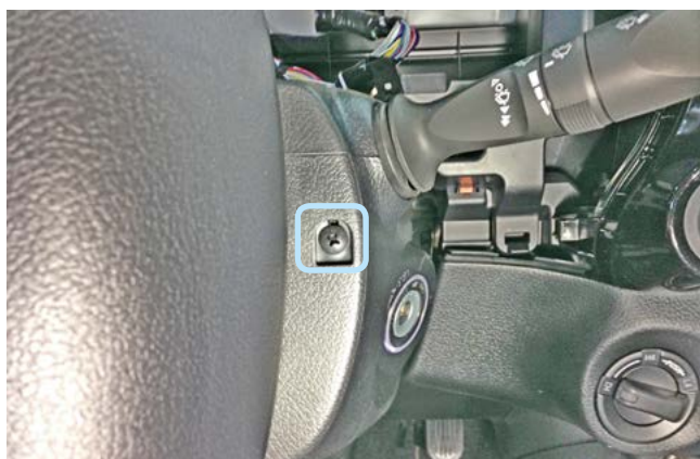
Фото 1.11. Саморез крепления кожану рулевого вала справа
