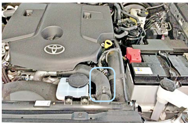
Фото 2.5. Место установки датчика температуры двигателя
