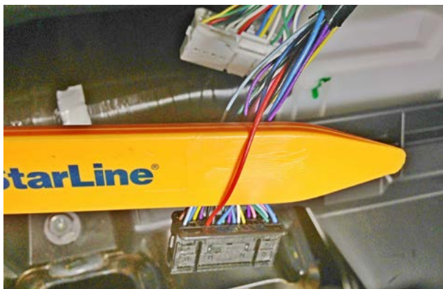
Фото 3.4. Разблокировка рулевого вала (красный)
