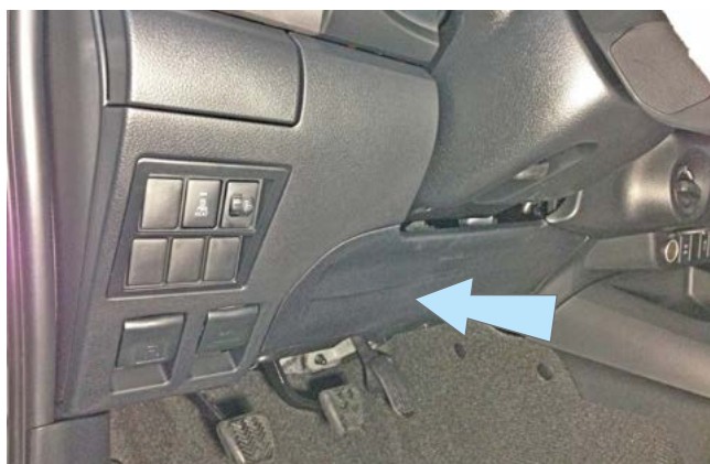
Фото 1.9. Коленная подушка безопасности водителя. Общий вид
