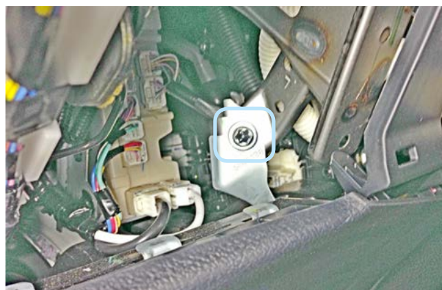
Фото 1.18. Болт крепления подушки безопасности вверху справа
