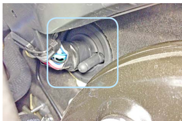
Фото 2.8. Штатный уплотнитель. Вид со стороны моторного отсека
