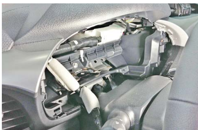
Фото 1.8. Панель приборов снята
