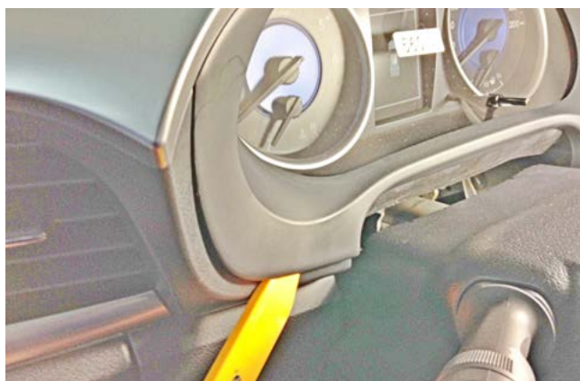
Фото 1.6. Снять накладку панели приборов
