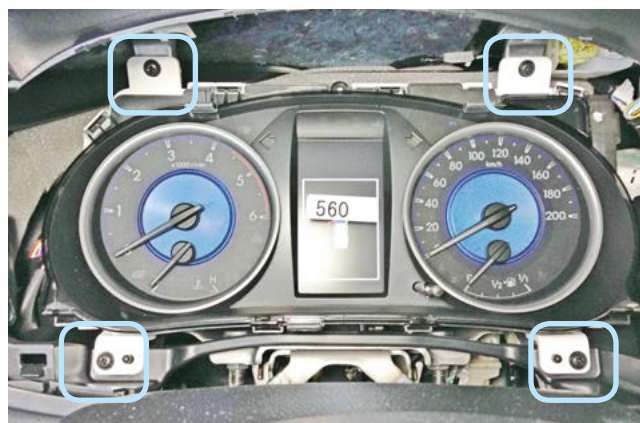
Фото 1.7. Саморезы крепления панели приборов
