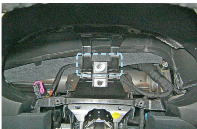
Фото 2.6. Пример расположения центрального блока охранно-телематического комплекса
