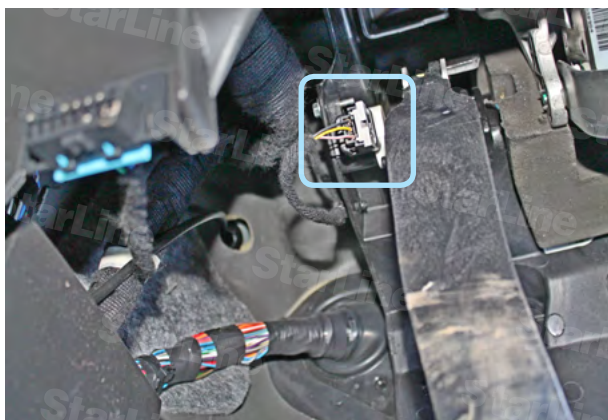
Фото 8.1. Местоположение разъёма педали сцепления
