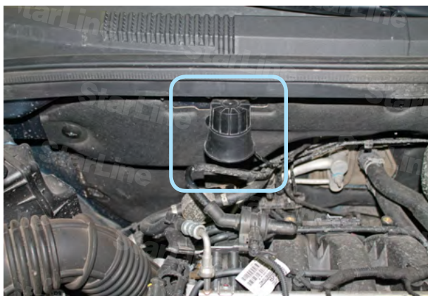
Фото 4.1. Возможное место установки сирены
