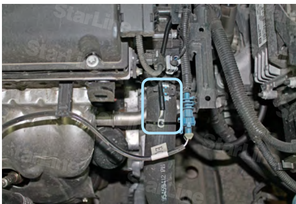
Фото 4.3. Место установки датчика температуры двигателя
