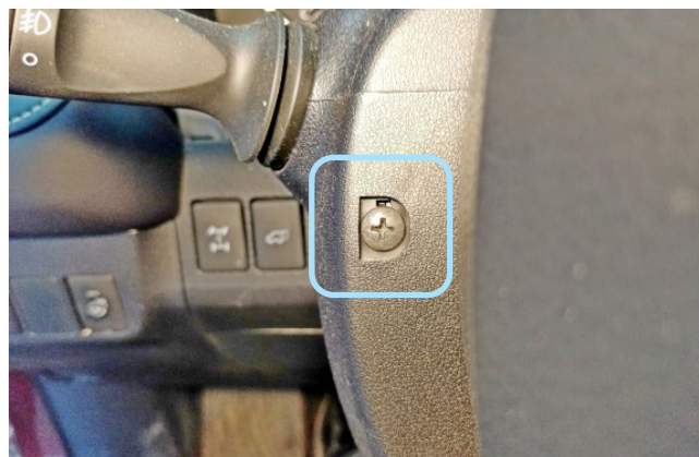
Фото 1.14. Саморез крепления кожуха рулевого вала слева
