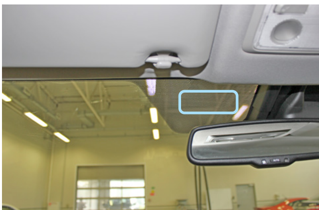
Фото 2.1. Возможное место установки антенны 868 МГц
