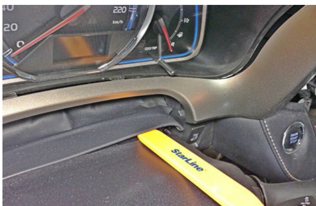
Фото 1.9. Снять пылезащитный кожух рулевой колонки
