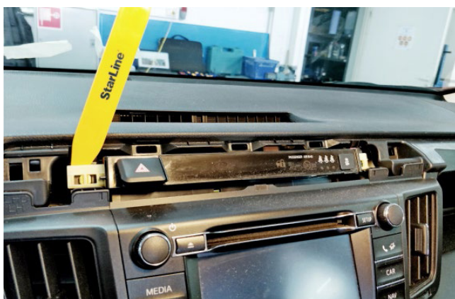
Фото 1.21. Снять панель индикации
