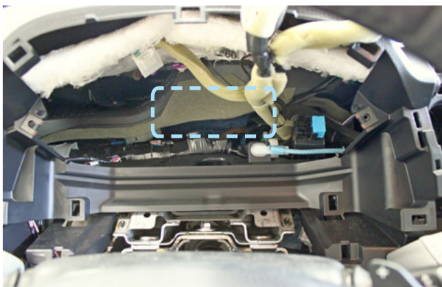
Фото 2.8. Пример расположения центрального блока охранно-телематического комплекса
