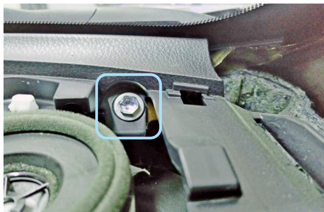
Фото 1.20. Болт крепления верхней накладке передней панели справа
