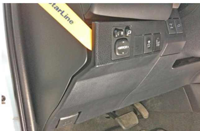
Фото 1.5. Снять накладку слева от рулевой колонки
