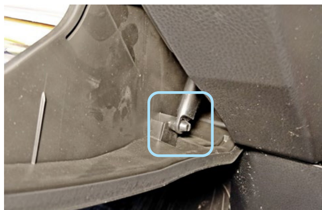
Фото 1.24. Ограничитель открытия перчаточного ящика
