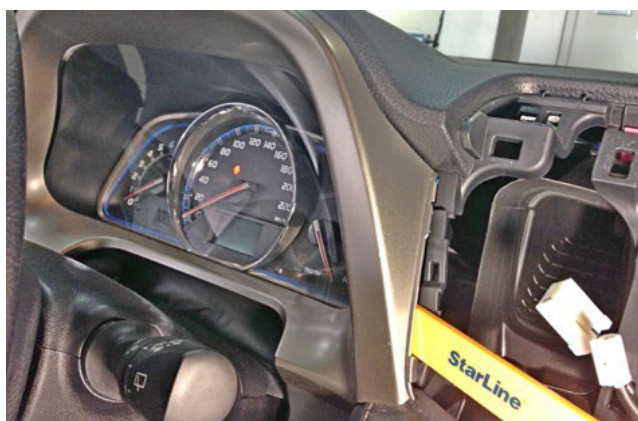
Фото 1.10. Снять накладку панели приборов
