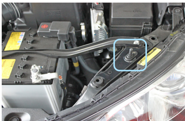
Фото 2.5. Возможное место установки концевика капота
