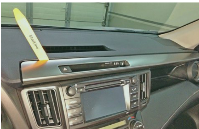
Фото 1.7. Снять декоративную накладку центральной консоли
