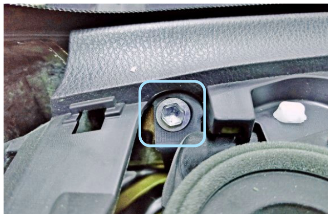
Фото 1.18. Болт крепления верхней накладки передней панели слева
