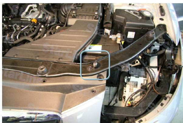
Фото 6.5. Концевик капота
