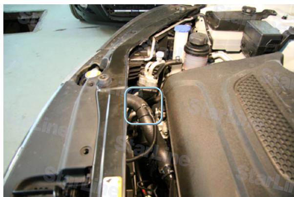
Фото 6.3. Датчик температуры — общий вид
