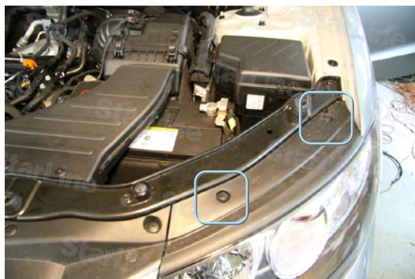
Фото 5.1. Болты крепления блок-фары
