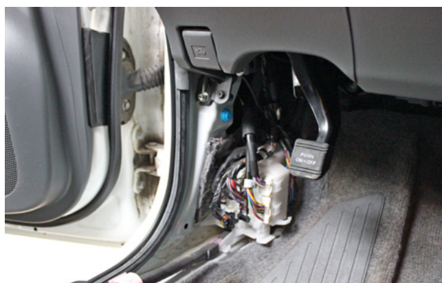
Фото 1.4. Накладка левой кик-панели снята
