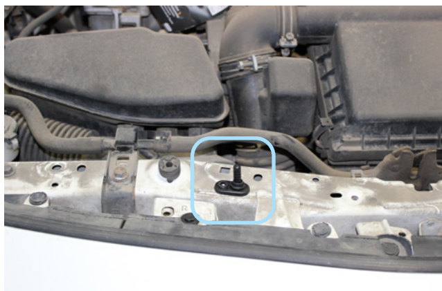
Фото 2.4. Возможное место установки концевика капота
