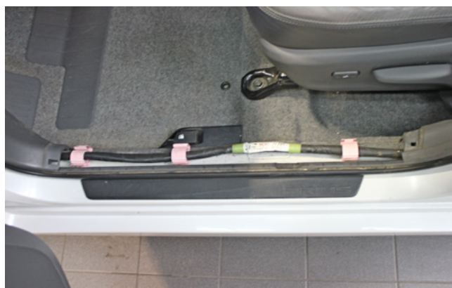
Фото 1.2. Накладка порога снята
