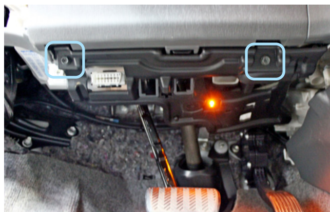
Фото 1.8. Саморезы крепления накладки педального узла
