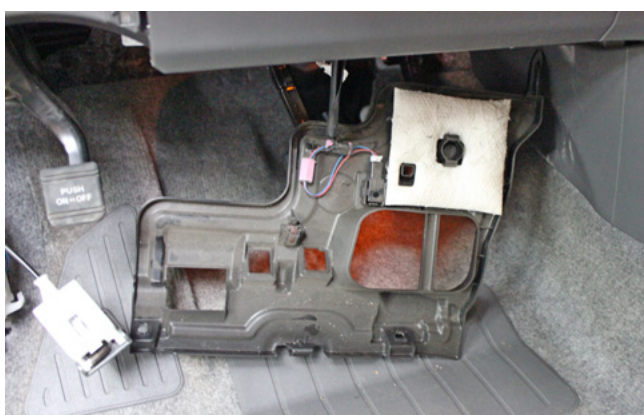
Фото 1.9. Накладка педального узла снята
