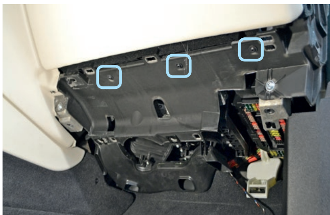
Фото 1.14. Саморезы крепления перчаточного ящика
