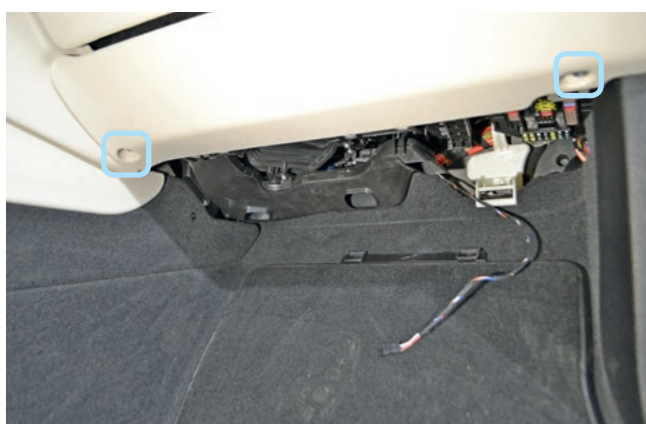
Фото 1.11. Саморезы крепления декоративной накладки. Нижняя пластиковая накладка снята
