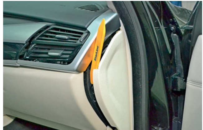
Фото 1.2. Снять правую накладку передней панели
