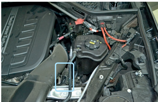
Фото 2.3. Место установки датчика температуры двигателя
