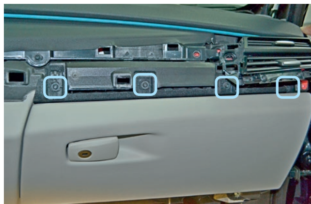
Фото 1.15. Саморезы крепления перчаточного ящика
