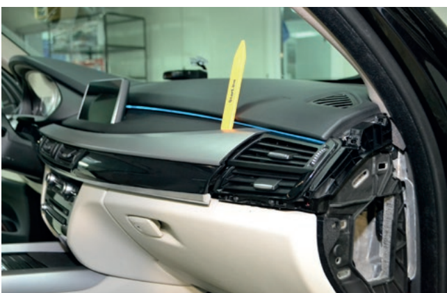
Фото 1.5. Снять декоративную накладку передней панели. Накладка правого воздуховода снята
