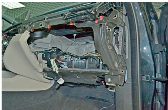
Фото 1.17. Перчаточный ящик снят
