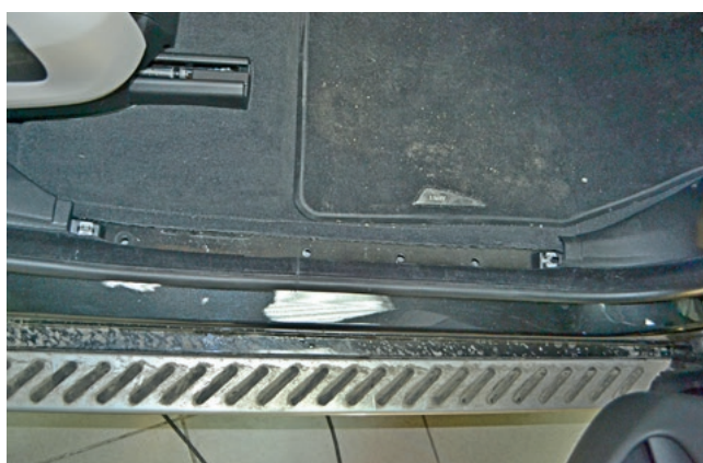
Фото 1.19. Накладка порога передней правой двери снята
