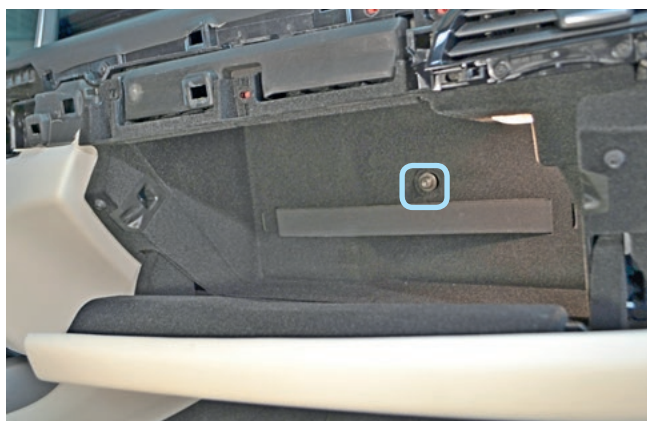
Фото 1.16. Саморез крепления перчаточного ящика
