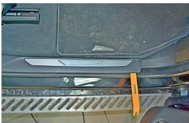
Фото 1.18. Снять накладку порога передней правой двери
