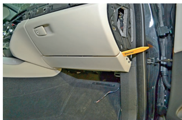
Фото 1.12. Снять декоративную накладку под перчаточным ящиком
