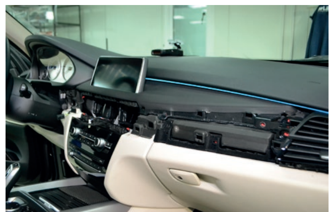
Фото 1.6. Декоративная накладка передней панели снята
