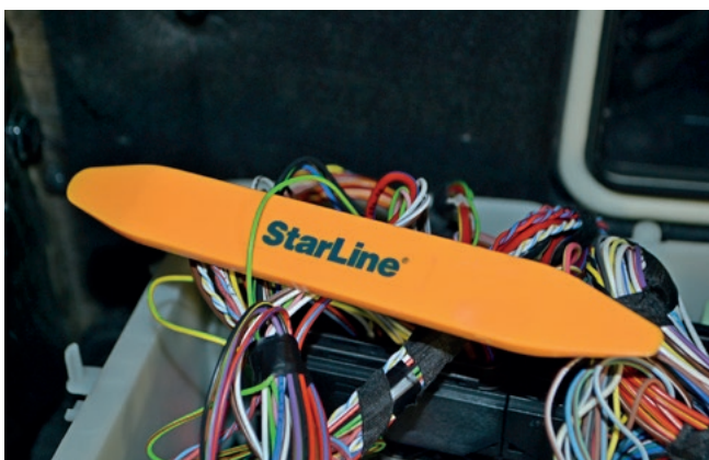
Фото 2.9. Подключение цепи зажигания R6 (зелёно-жёлтый)
