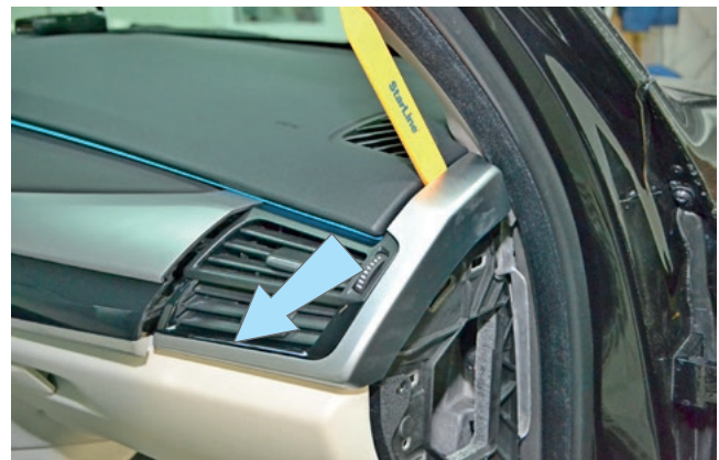
Фото 1.4. Снять накладку правого воздуховода
