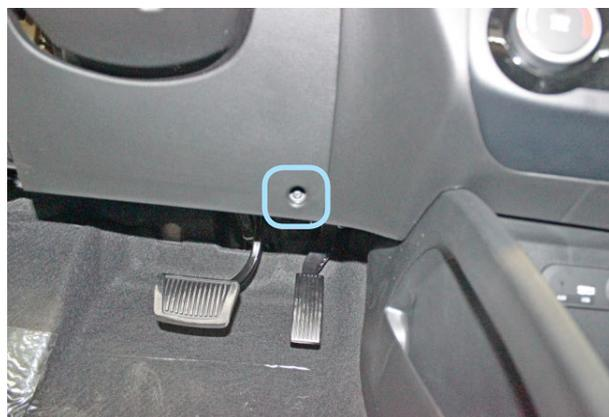
Фото 1.10. Саморез крепления пластиковой накладки под рулевой колонкой
