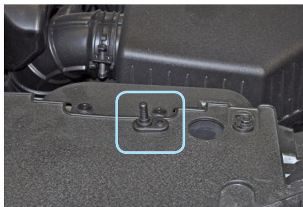
Фото 4.5. Возможное место установки концевика капота
