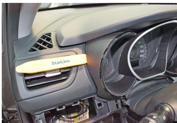
Фото 2.2. Снять декоративную накладку панели приборов
