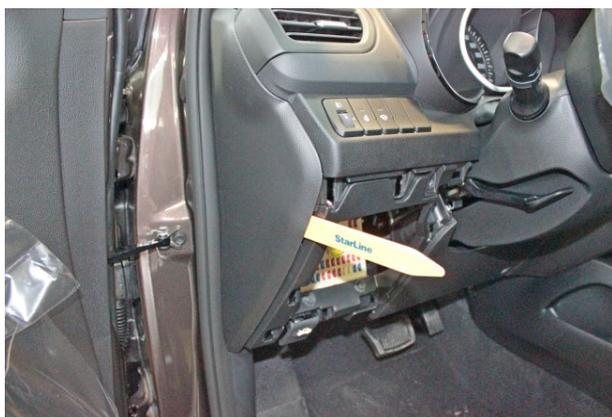
Фото 1.3. Снять боковую накладку передней панели
