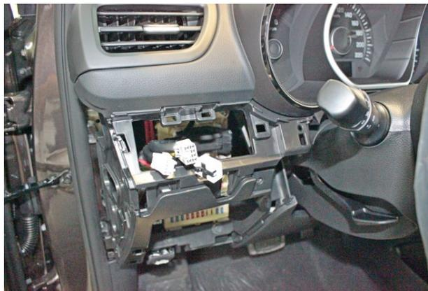
Фото 1.7. Блок кнопок управления снят
