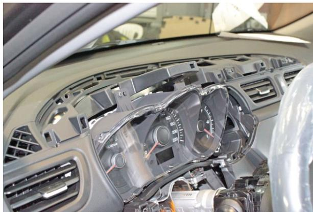
Фото 2.3. Накладка панели приборов снята
