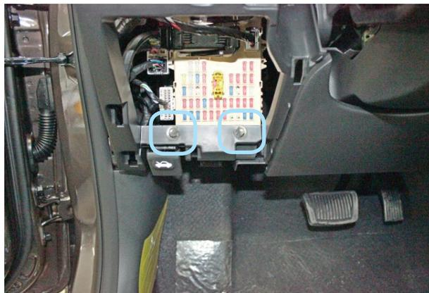
Фото 1.8. Болты крепления пластиковой накладки под рулевой колонкой
