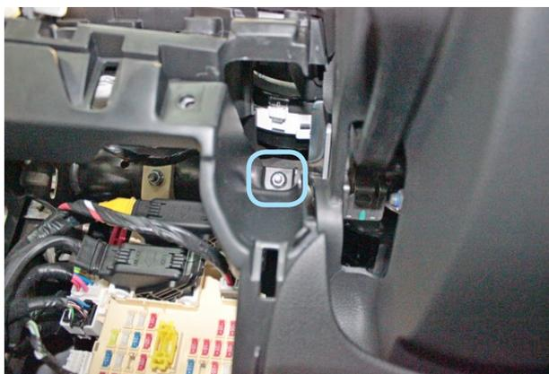
Фото 1.9. Гайка крепления пластиковой накладки под рулевой колонкой
