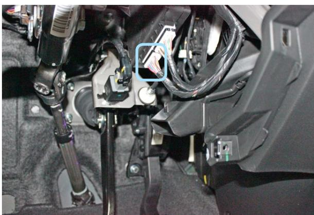
Фото 7.1. Местоположение разъёма на блоке BCM
