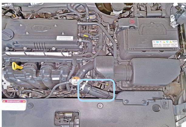
Фото 4.3. Место установки датчика температуры двигателя
