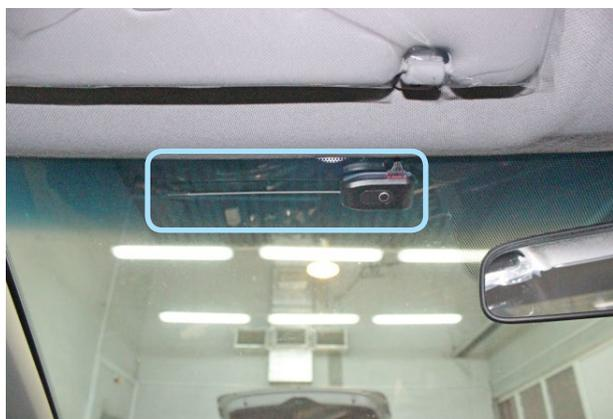
Фото 3.1. Возможное место установки антенного модуля
