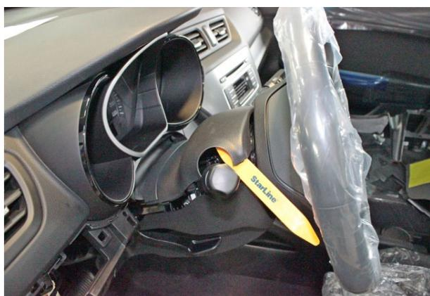
Фото 2.1. Снять верхнюю часть кожуха рулевого вала
