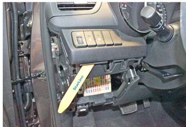
Фото 1.6. Снять блок кнопок слева от рулевой колонки
