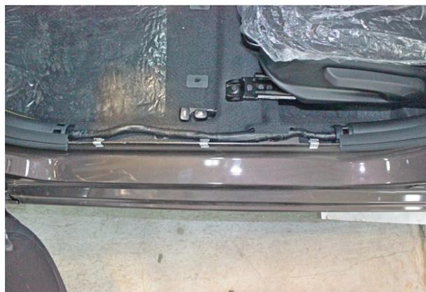
Фото 1.12. Накладка порога двери водителя снята
