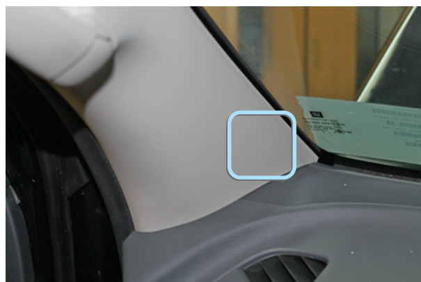
Фото 3.2. Светодиод. Возможное место установки
