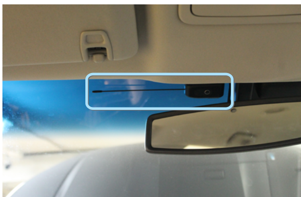
Фото 3.1. Антенна на лобовом стекле
