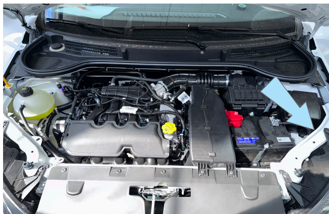
Фото 2.2. Возможное место установки сирены
