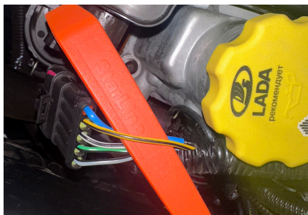
Фото 3.19. Контроль работы двигателя (жёлто-чёрный)
