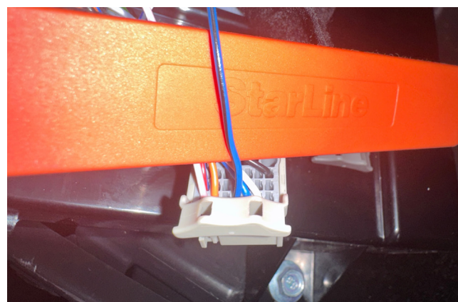
Фото 3.21. Управление центральным замком (сине-чёрный)
