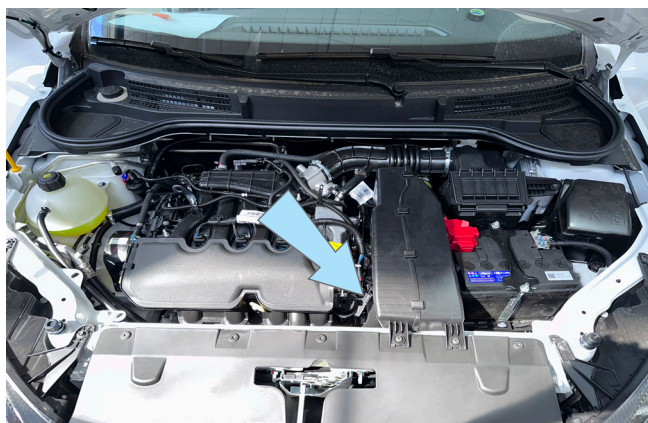
Фото 2.4. Место установки датчика температуры двигателя
