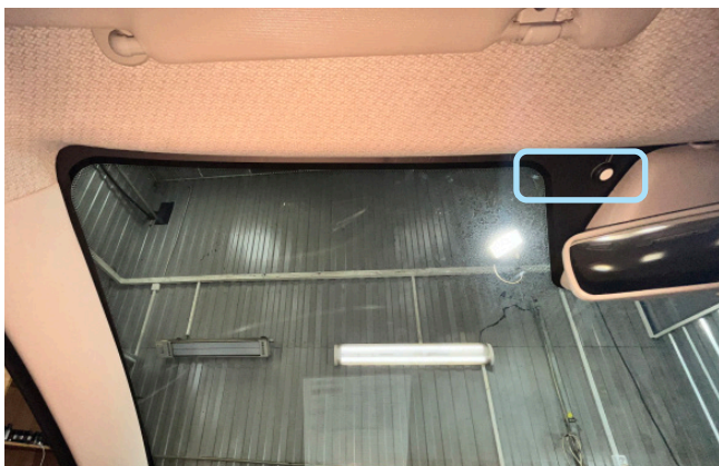
Фото 2.1. Возможное место установки антенны (сервисной кнопки)
