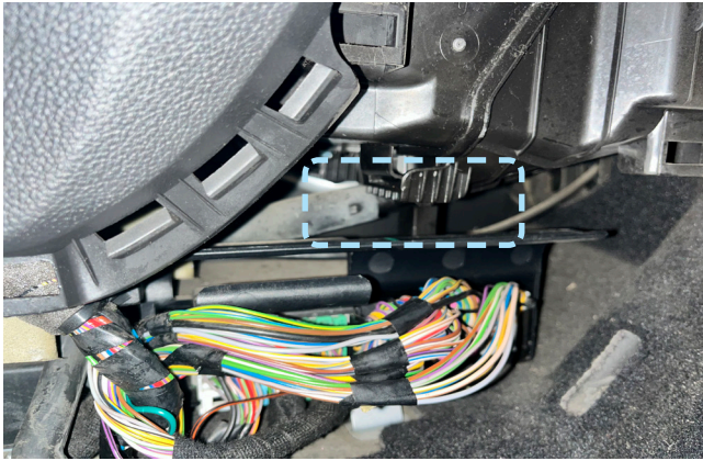
Фото 2.7. Пример расположения центрального блока охранно-телематического комплекса
