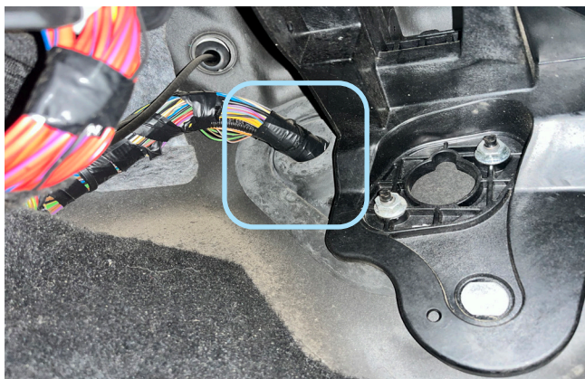
Фото 2.6. Штатный уплотнитель. Вид со стороны салона
