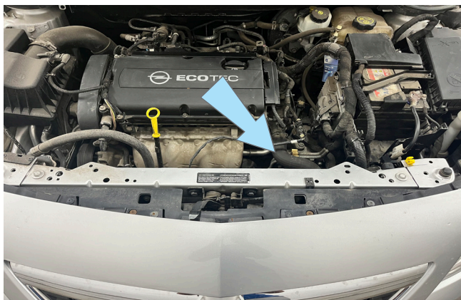
Фото 2.4. Место установки датчика температуры двигателя
