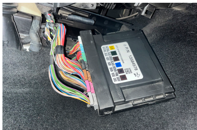
Фото 1.4. Блок BCM снят
