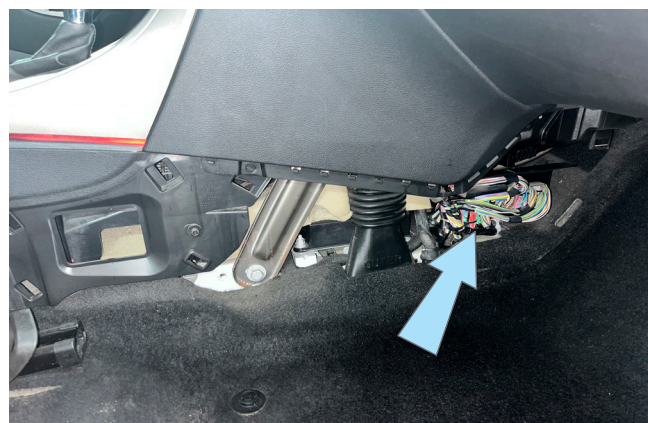
Фото 1.3. Декоративная накладка снята, местоположение блока BCM
