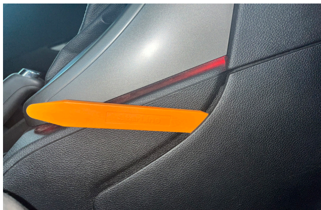
Фото 1.2. Снять правую декоративную накладку
