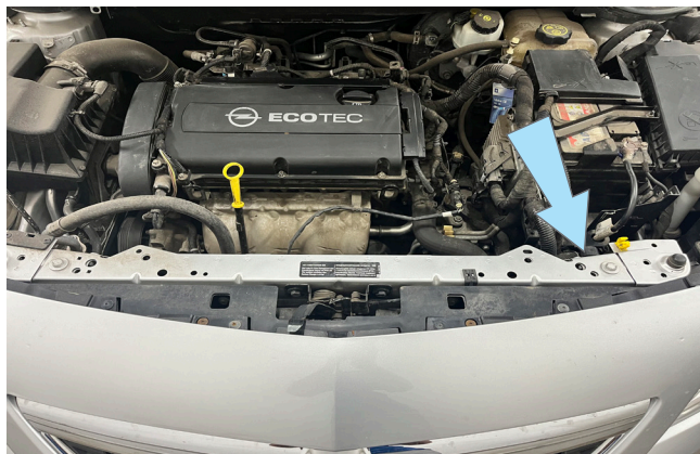
Фото 2.2. Возможное место установки сирены
