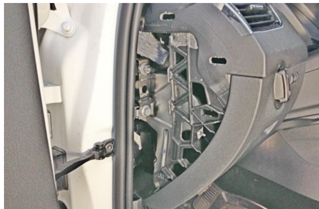
Фото 1.2. Левая боковая накладка передней панели снята
