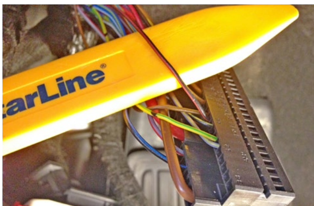
Фото 3.10. Разъём А, зажигание 2 (чёрно-красный)
