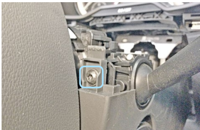
Фото 1.11. Винт крепления кожуха рулевого вала справа
