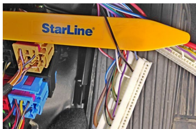
Фото 3.13. Разъём С, имитация нажатия педали тормоза (чёрно-красный)
