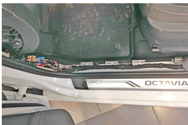
Фото 1.6. Накладка порога двери водителя снята
