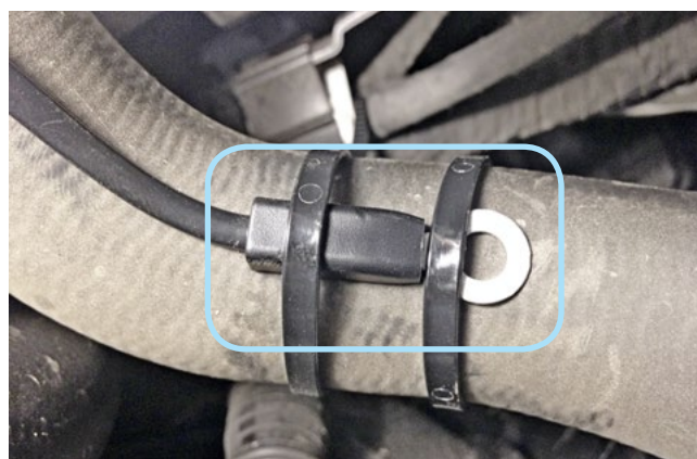
Фото 2.4. Крепление датчика температуры двигателя
