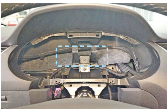
Фото 2.7. Пример расположения центрального блока охранно-телематического комплекса
