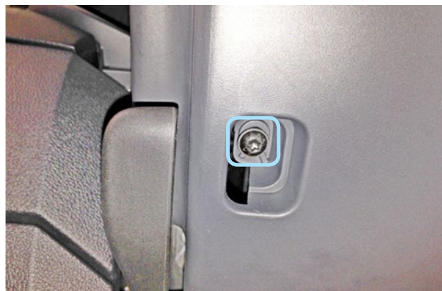
Фото 1.12. Винт крепления кожуха рулевого вала снизу
