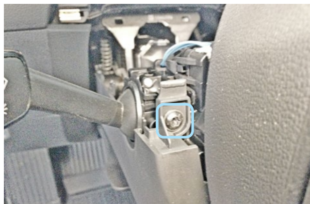
Фото 1.10. Винт крепления кожуха рулевого вала слева
