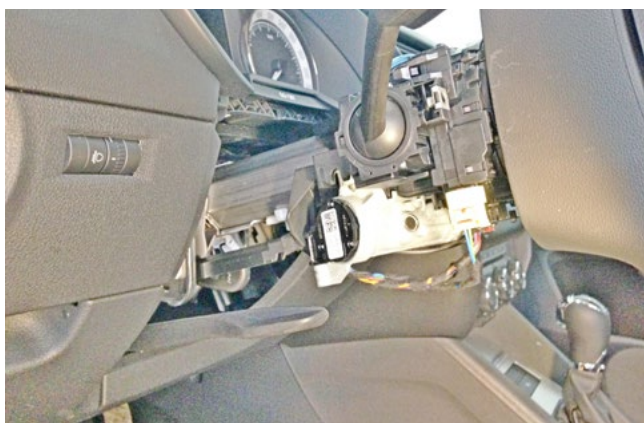
Фото 1.13. Кожух рулевого вала снят
