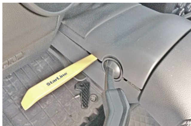
Фото 1.8. Отсоединить верхнюю часть кожуха рулевого вала
