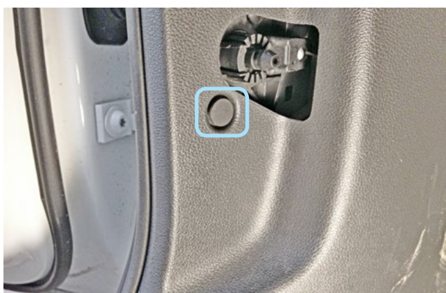
Фото 1.5. Ручка отпирания капота снята. Клипса крепления накладки левой кик-панели
