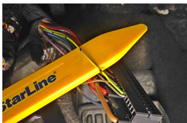
Фото 3.9. Разъём А, зажигание 1 (жёлто-зелёный)
