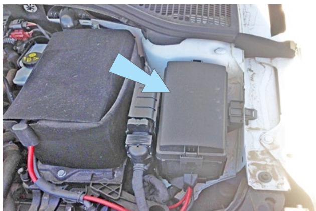
Фото 2.6. Возможное место установки подкапотного блока R6
