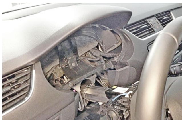
Фото 1.15. Панель приборов снята
