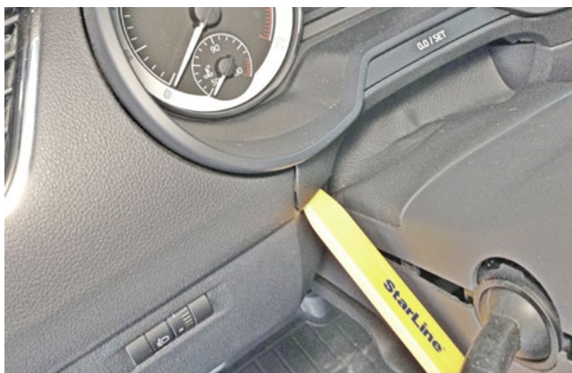
Фото 1.9. Снять накладку под панелью приборов
