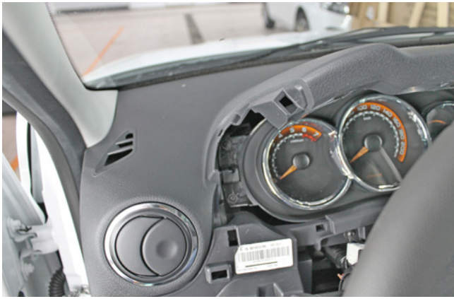
Фото 1.19. Накладка слева от панели приборов снята
