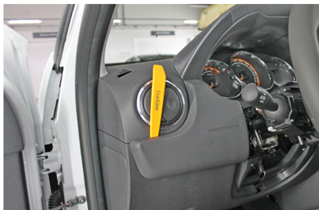
Фото 1.8. Снять пластиковую накладку слева от рулевой колонки
