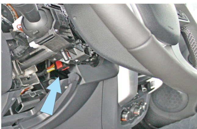
Фото 3.4. Местоположение разъёма замка зажигания
