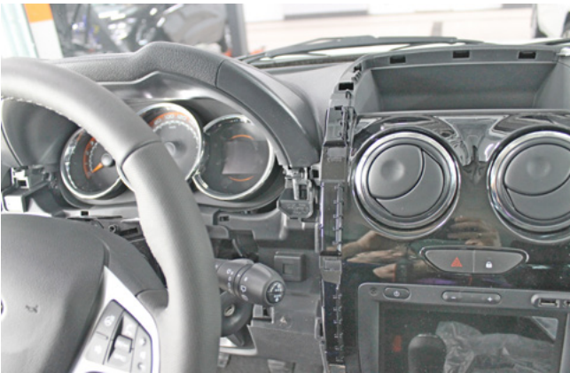
Фото 1.15. Пластиковая накладка снята
