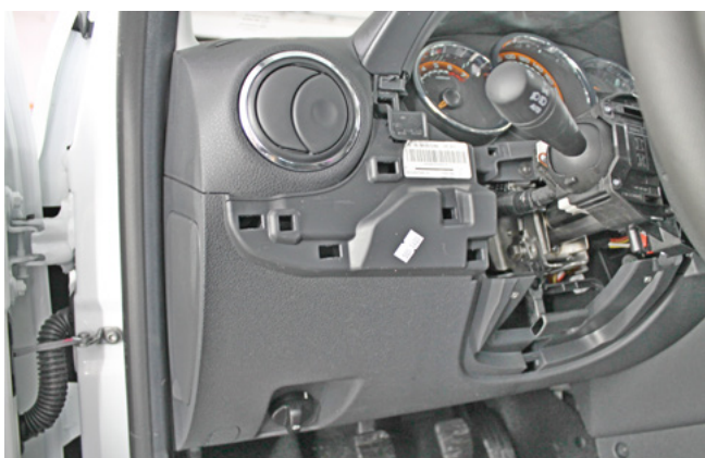
Фото 1.9. Пластиковая накладка снята
