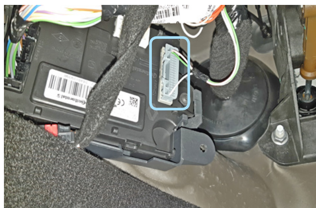
Фото 3.9. Местоположение серого разъёма на блоке BCM
