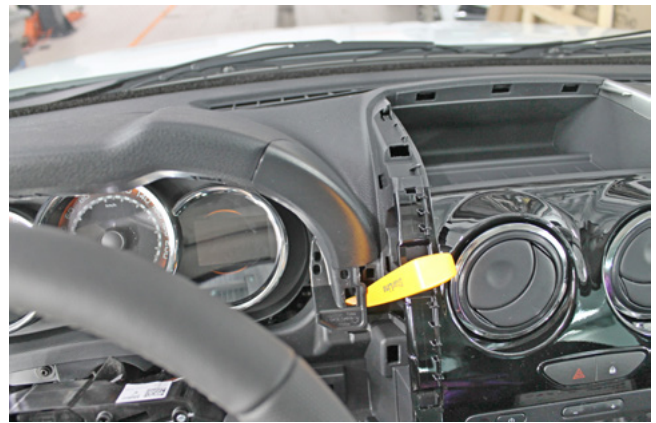
Фото 1.20. Снять накладку справа от панели приборов
