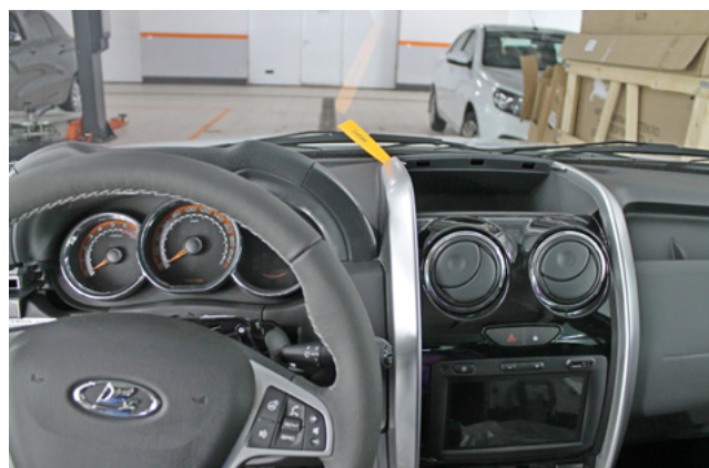
Фото 1.12. Снять левую декоративную накладку центральной консоли
