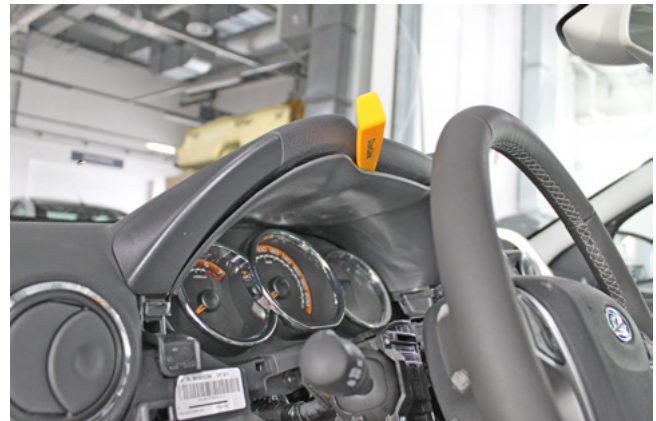
Фото 1.16. Снять декоративную накладку панели приборов
