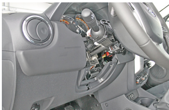
Фото 1.4. Кожух рулевого вала снят
