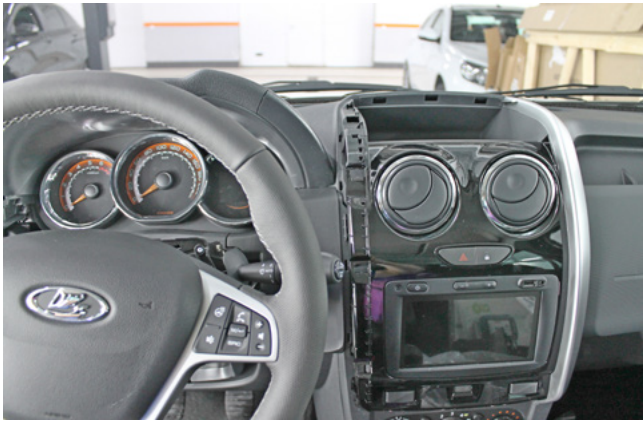
Фото 1.13. Декоративная накладка центральной консоли снята
