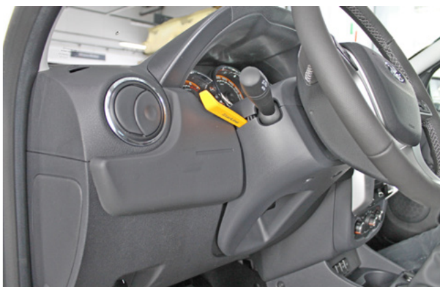
Фото 1.3. Снять кожух рулевого вала
