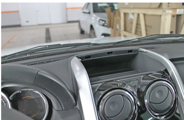
Фото 1.11. Пластиковая накладка снята
