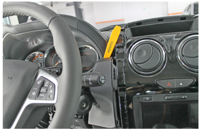
Фото 1.14. Снять пластиковую накладку справа от рулевой колонки
