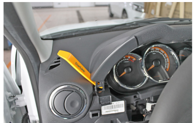
Фото 1.18. Снять накладку слева от панели приборов
