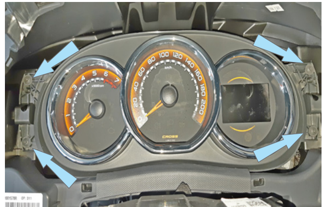
Фото 1.22. Саморезы крепления панели приборов
