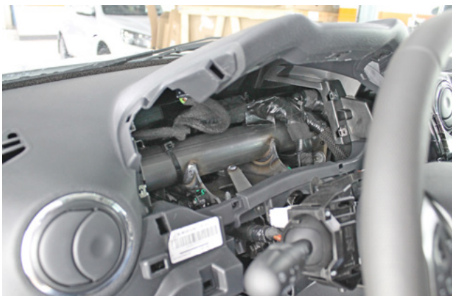
Фото 1.23. Панель приборов снята
