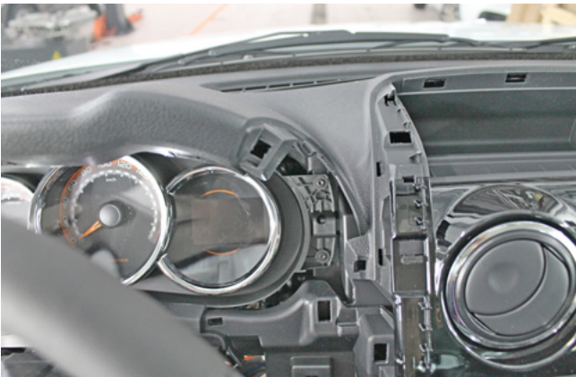
Фото 1.21. Накладка справа от панели приборов снята
