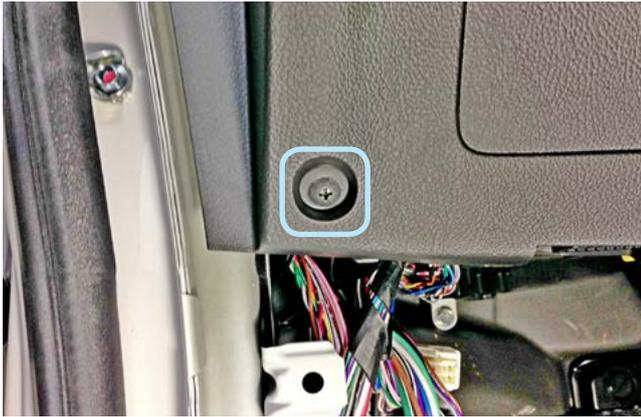
Фото 1.7. Саморез крепления декоративной накладки слева от рулевой колонки
