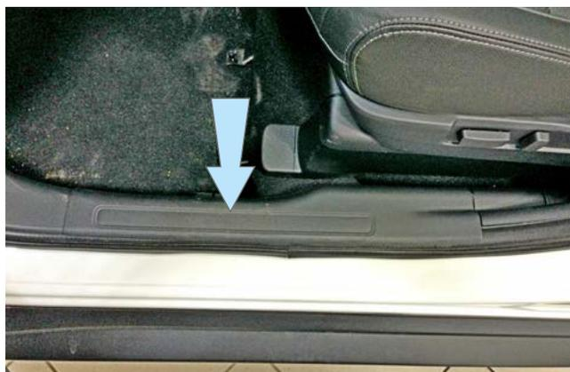
Фото 1.2. Снять накладку порога двери водителя
