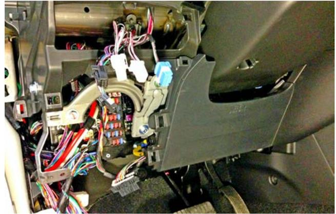
Фото 1.8. Декоративная накладка слева от рулевой колонки снята
