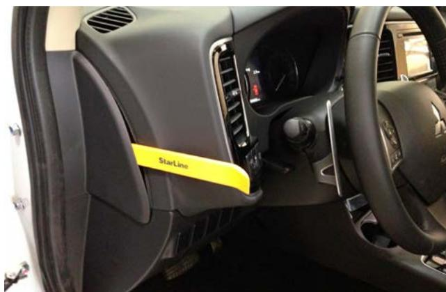
Фото 1.6. Снять левую боковую накладку передней панели
