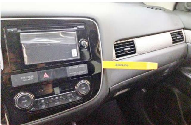
Фото 1.11. Снять декоративную накладку магнитолы
