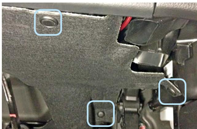
Фото 1.4. Клипсы крепления накладки pedalного узла
