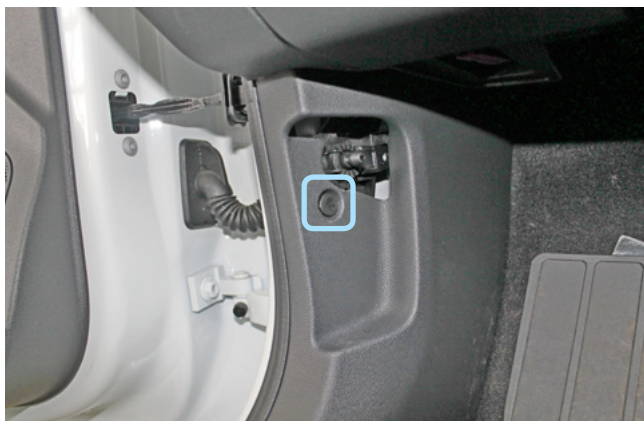
Фото 1.9. Ручка отпирания капота снята. Клипса крепления накладки левой кик-панели
