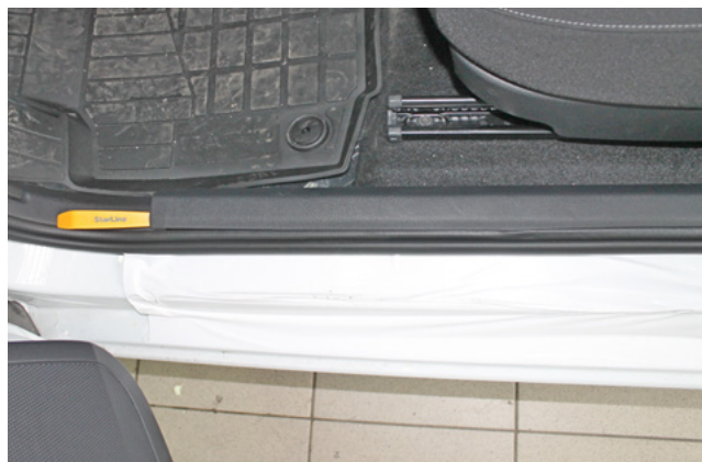
Фото 1.10. Частично снять пластиковую накладку порога двери водителя
