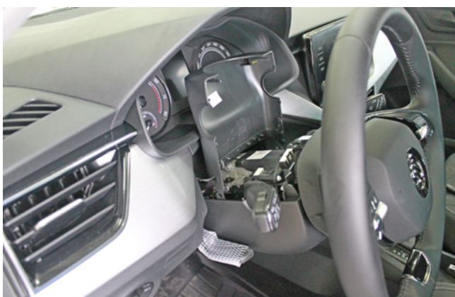
Фото 1.3. Верхняя часть кожуха рулевого вала снята
