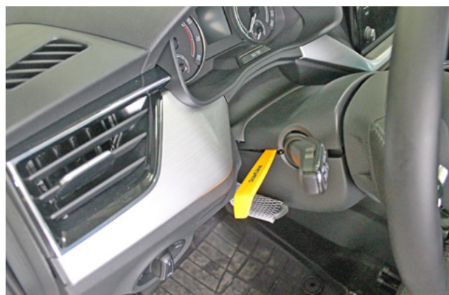
Фото 1.2. Снять верхнюю часть кожуха рулевого вала
