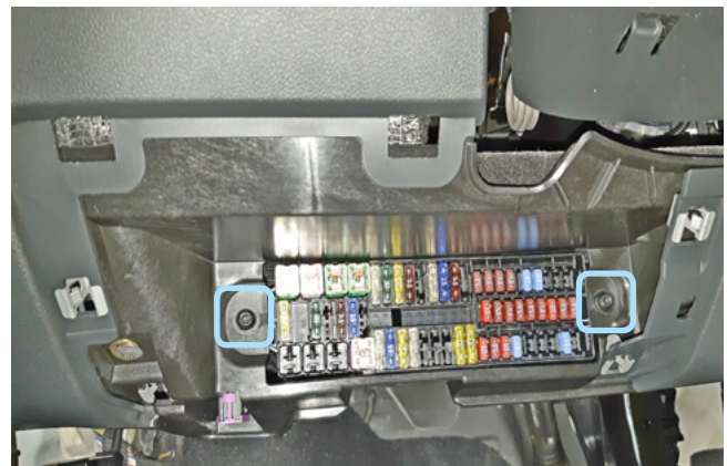
Фото 1.15. Крышка снята. Винты крепления
