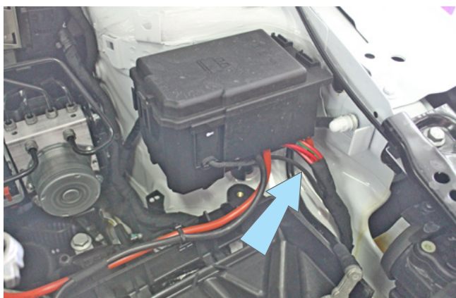
Фото 3.16. Местоположение жгута подкапотного блока предохранителей (аккумуляторная батарея снята)
