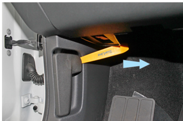
Фото 1.8. Сдвинуть фиксатор ручки отпирания капота в направлении стрелки
