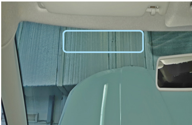
Фото 2.1. Возможное место установки антенного модуля
