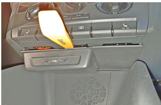
Фото 1.21. Снять пластиковую панель с разъёмами USB
