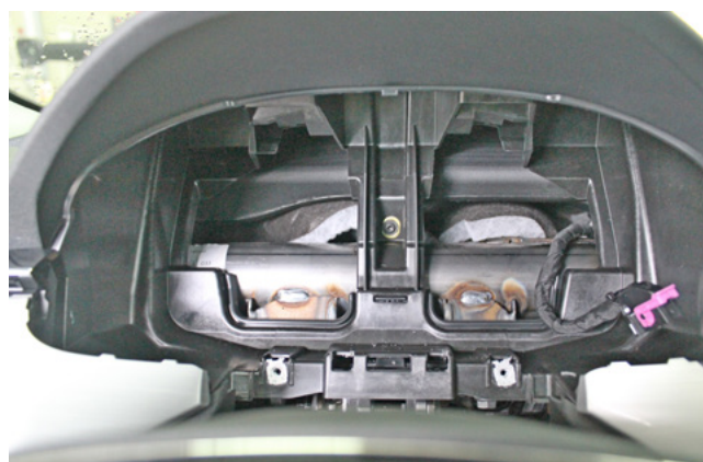
Фото 1.6. Панель приборов снята
