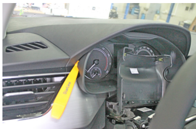
Фото 1.4. Снять декоративную накладку панели приборов
