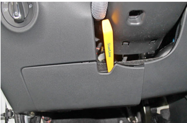
Фото 1.14. Снять пластиковую крышку блока предохранителей
