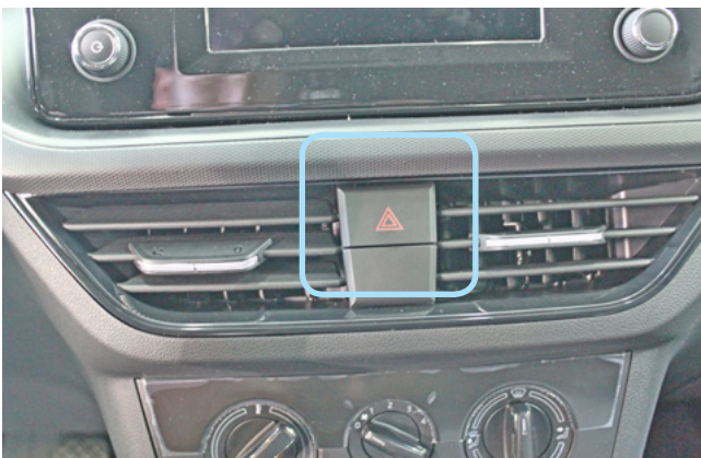
Фото 3.6. Местоположение кнопки аварийной сигнализации
