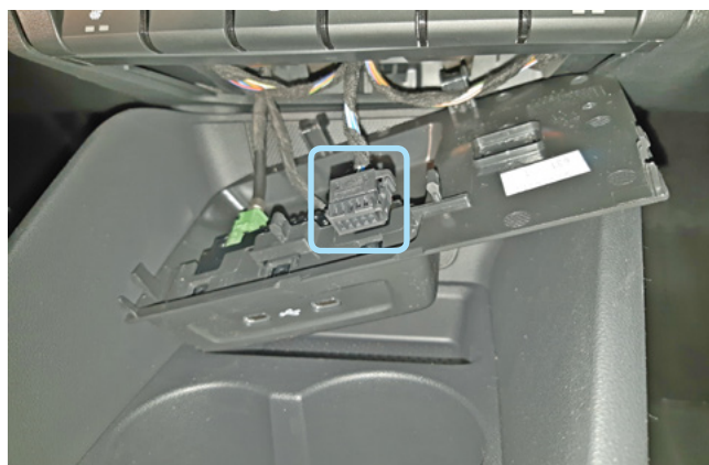
Фото 1.22. Панель снята. Разъём кнопки управления центральным замком
