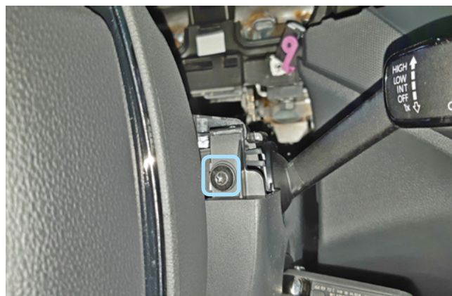
Фото 1.18. Винт крепления кожуха рулевого вала справа
