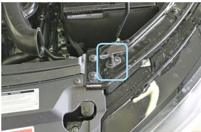
Фото 2.6. Возможное место установки концевика капота
