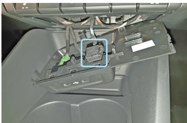
Фото 3.8. Местоположение разъёма кнопки
