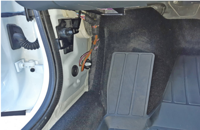
Фото 1.13. Пластиковая накладка левой кик-панели снята
