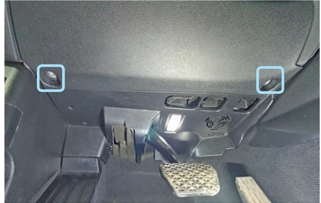
Фото 1.2. Саморезы крепления pedalного узла
