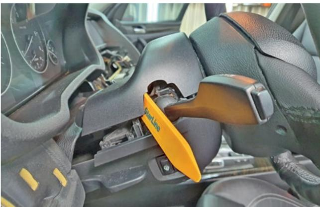
Фото 1.16. Снять верхнюю часть кожуха рулевого вала
