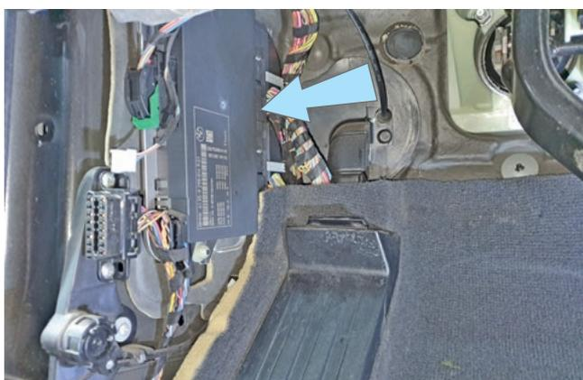
Фото 1.9. Накладка снята. Блок FRM
