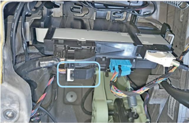
Фото 3.2. Местоположение разъёма
