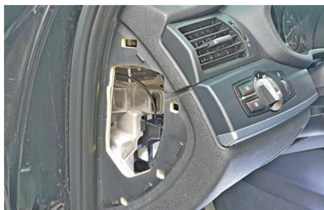
Фото 1.11. Левая накладка передней панели снята
