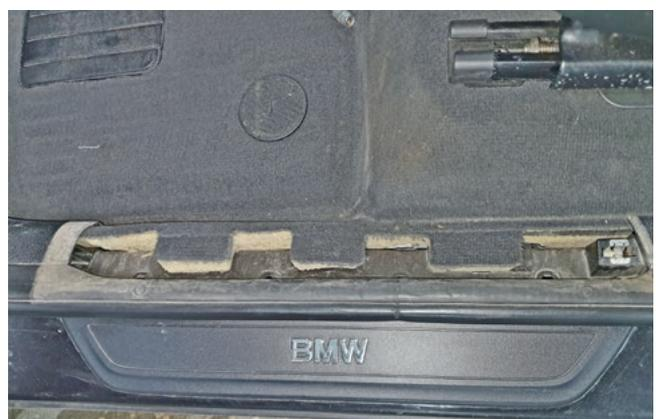
Фото 1.6. Накладка порога двери водителя снята
