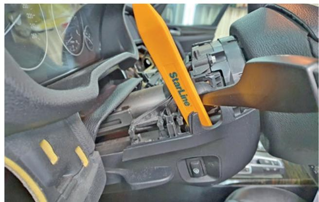
Фото 1.17. Снять нижнюю часть кожуха рулевого вала
