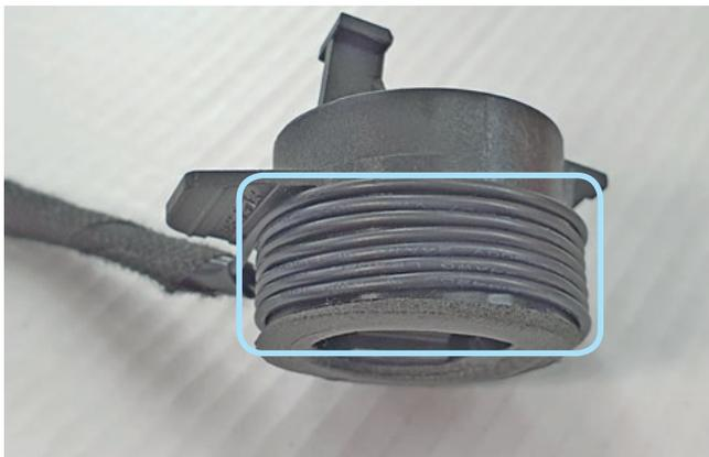
Фото 3.7. Расположение антенны модуля VP-03 на антенне штатного иммобилайзера
