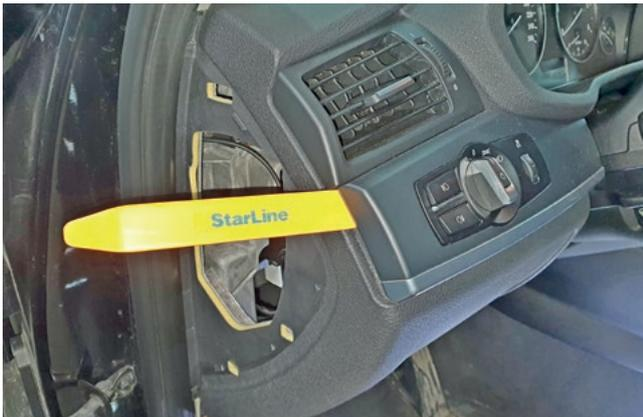
Фото 1.12. Снять блок кнопок переключателя света
