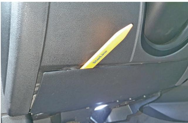
Фото 1.3. Снять накладку pedalного узла
