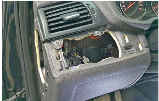
Фото 1.13. Блок кнопок снят
