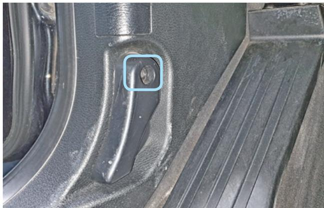
Фото 1.7. Саморез крепления ручки отпирания капота
