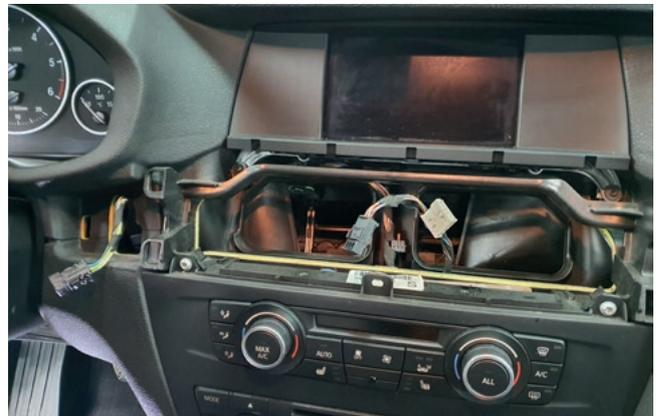
Фото 1.15. Накладка передней панели снята
