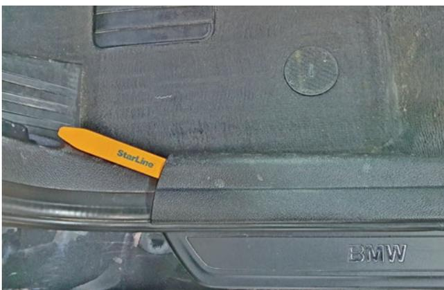
Фото 1.5. Снять накладку порога двери водителя
