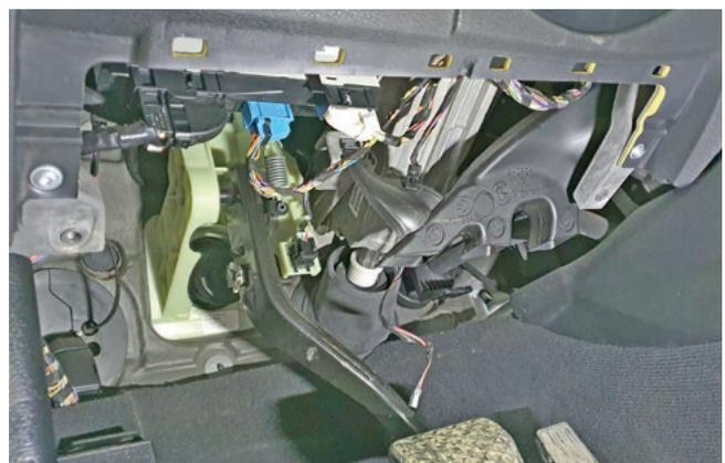
Фото 1.4. Накладка pedalного узла снята
