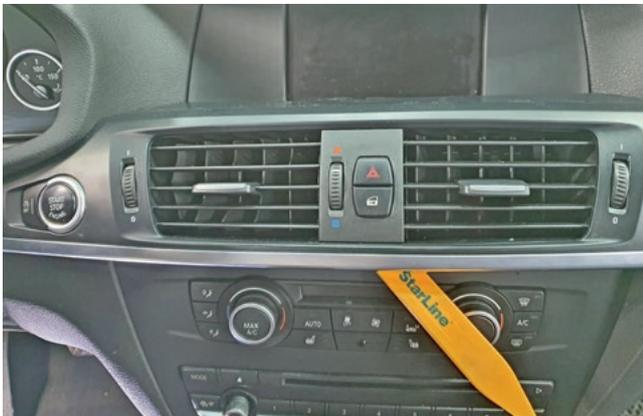
Фото 1.14. Снять накладку передней панели
