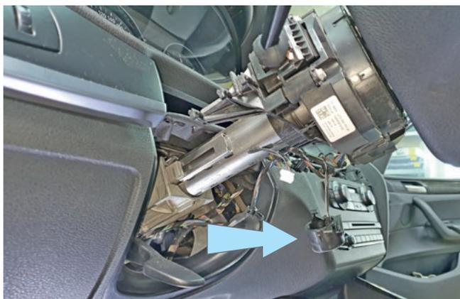
Фото 1.18. Кожух рулевого вала снят. Местоположение антенны штатного иммобилайзера
