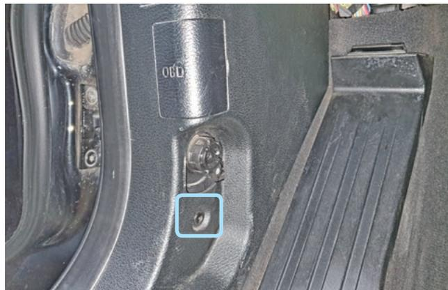
Фото 1.8. Саморез крепления накладки левой кик-панели
