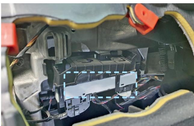
Фото 2.7. Пример расположения центрального блока охранно-телематического комплекса
