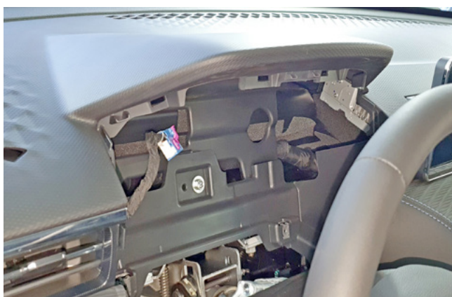
Фото 1.15. Панель приборов снята
