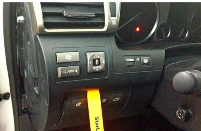
Фото 1.9. Снять блок кнопок
