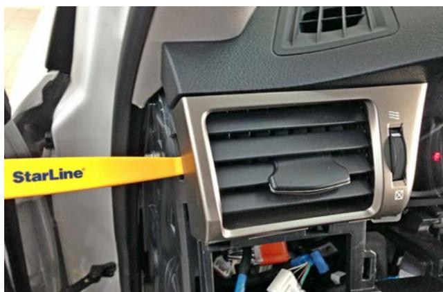
Фото 1.16. Снять воздуховод слева от панели приборов
