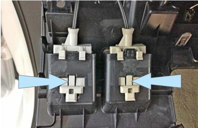
Фото 1.7. Фиксаторы крепления ручек отпирания капота и лючка бензобака
