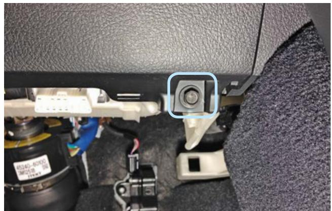
Фото 1.6. Болт крепления накладки под рулевой колонкой справа
