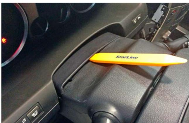
Фото 1.15. Снять декоративную накладку панели приборов и пылезащитный чехол
