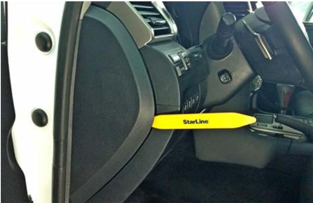
Фото 1.1. Снять левую боковую накладку передней панели
