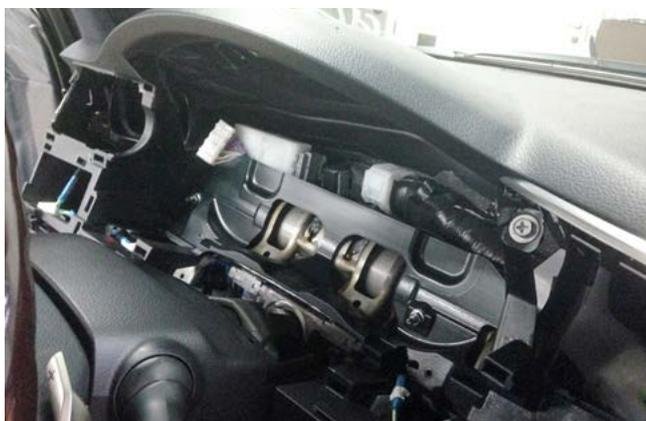
Фото 1.21. Панель приборов снята
