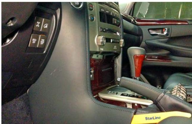
Фото 1.13. Снять левую накладку центрального тоннеля
