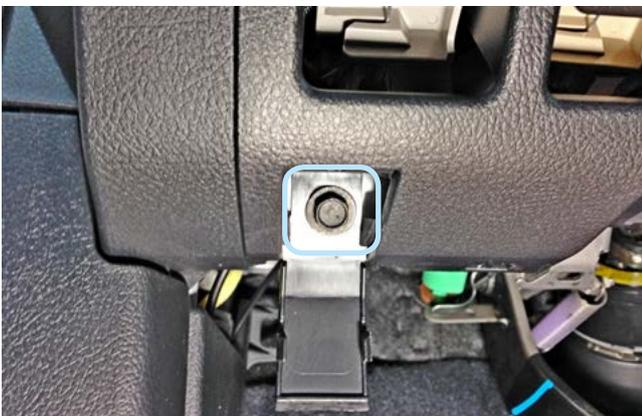
Фото 1.5. Болт крепления накладки под рулевой колонкой слева
