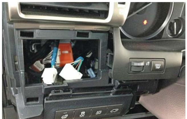
Фото 1.10. Блок кнопок снят
