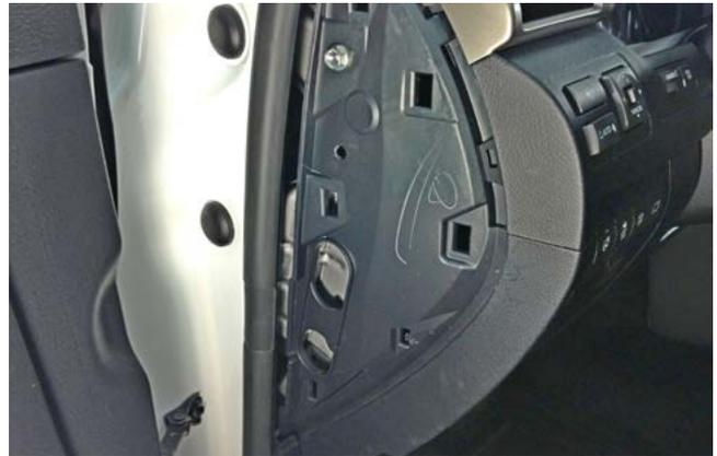
Фото 1.2. Левая боковая накладка передней панели снята
