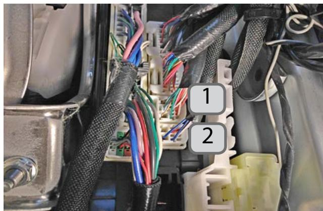
Фото 3.5. Нумерация разъёмов
