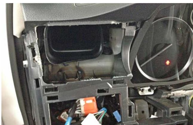
Фото 1.17. Воздуховод слева от панели приборов снят
