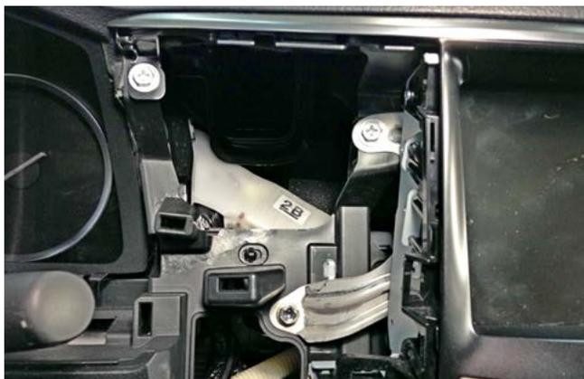
Фото 1.19. Воздуховод справа от панели приборов снят
