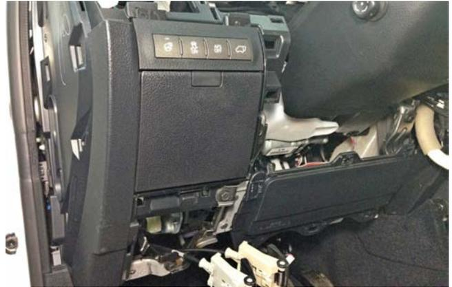
Фото 1.8. Накладка под рулевой колонкой снята
