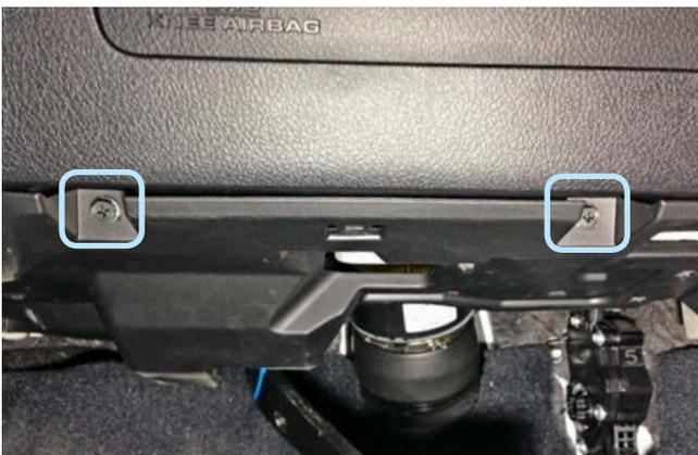
Фото 1.3. Саморезы крепления накладки педального узла
