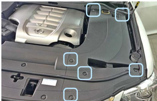
Фото 2.3. Клипсы крепления декоративной накладки моторного отсека
