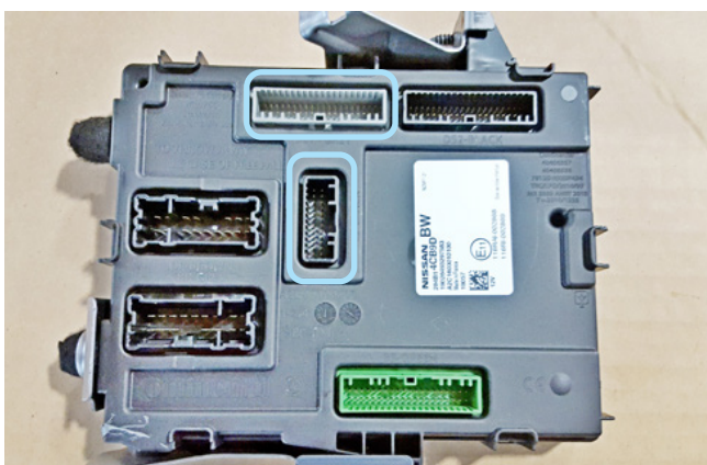
Фото 3.7. Местоположение разъёмов на блоке BCM
