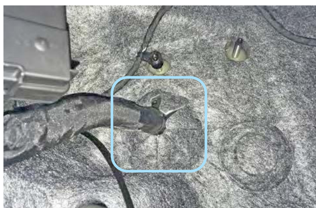
Фото 2.9. Штатный уплотнитель. Вид со стороны салона
