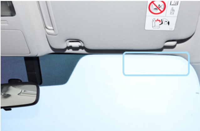
Фото 2.1. Возможное место установки антенного модуля
