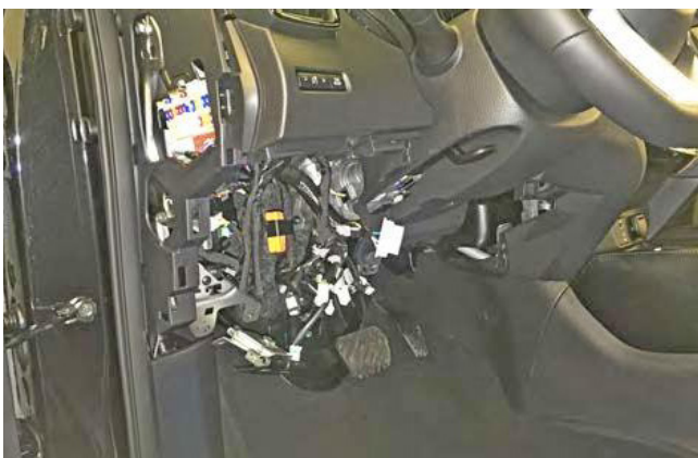
Фото 1.5. Пластиковая накладка под рулевой колонкой снята
