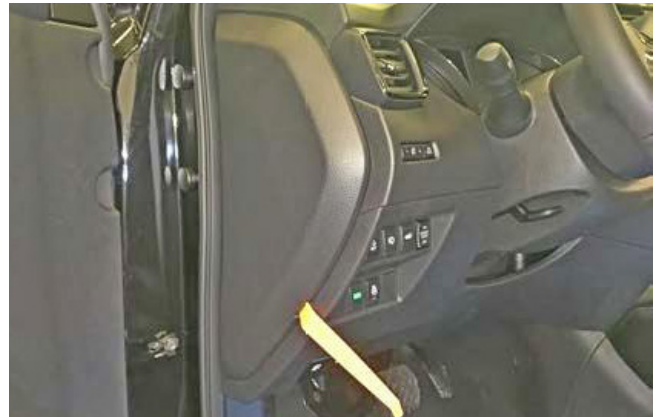
Фото 1.2. Снять боковую накладку передней панели
