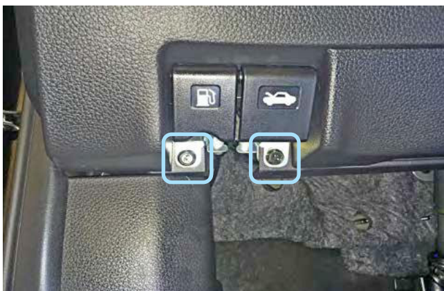
Фото 1.3. Болты крепления ручки отпирания капота
