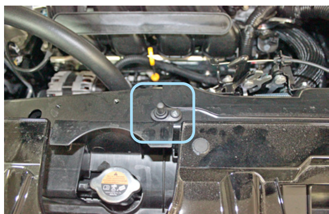
Фото 2.8. Возможное место установки концевика капота
