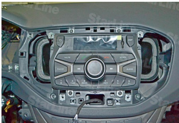
Фото 4.3. Центральные воздуховоды сняты
