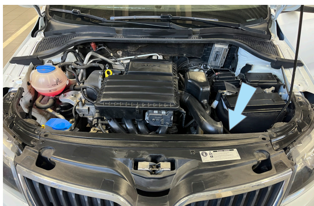
Фото 2.4. Место установки датчика температуры двигателя
