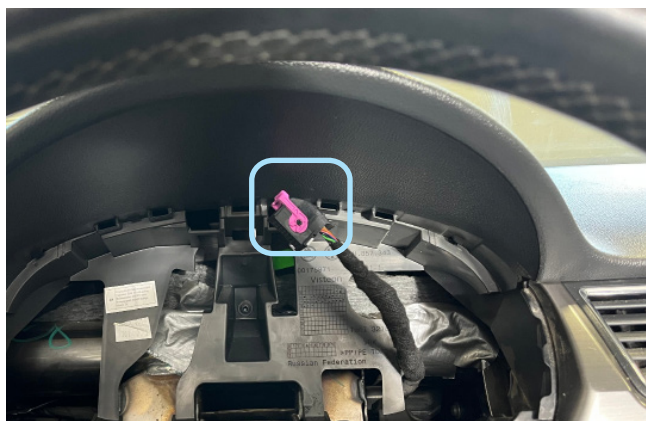
Фото 3.2. Местоположение разъёма панели приборов
