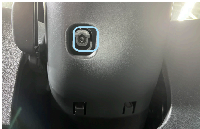
Фото 1.8. Винт крепления нижней части кожуха. Снизу
