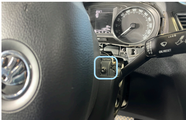
Фото 1.7. Винт крепления нижней части кожуха. Справа
