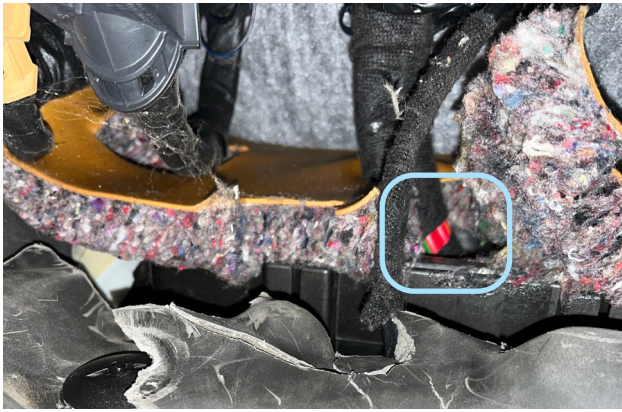
Фото 2.6. Штатный уплотнитель. Вид со стороны салона
