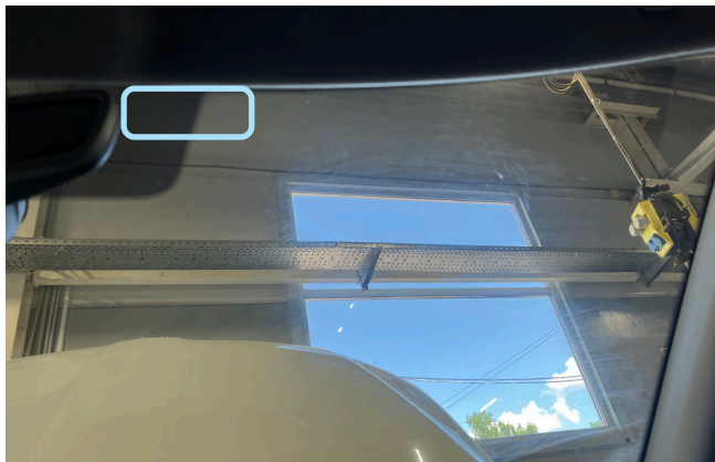
Фото 2.1. Возможное место установки антенны (Трансивера)
