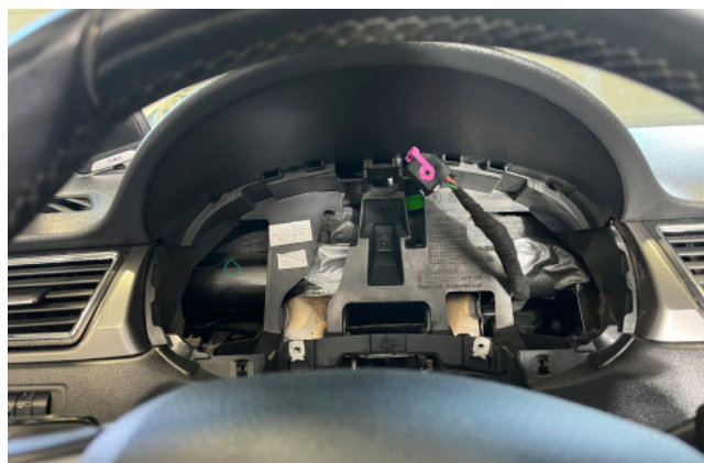
Фото 1.4. Панель приборов снята
