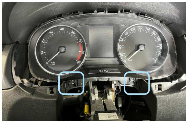
Фото 1.3. Саморезы крепления панели приборов
