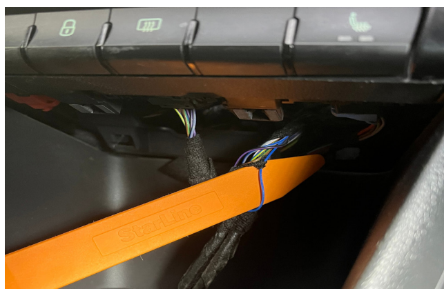
Фото 3.9. Альтернативное управление центральным замком (синий)
