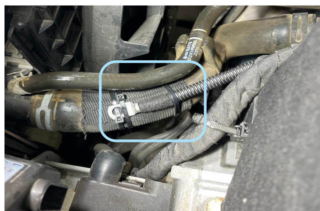
Фото 2.5. Установка датчика температуры двигателя
