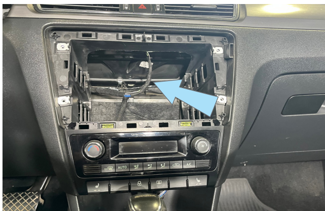
Фото 3.6. Местоположение жгута кнопки аварийной сигнализации
