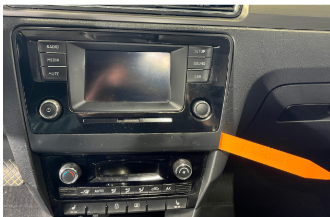
Фото 1.9. Снять декоративную накладку
