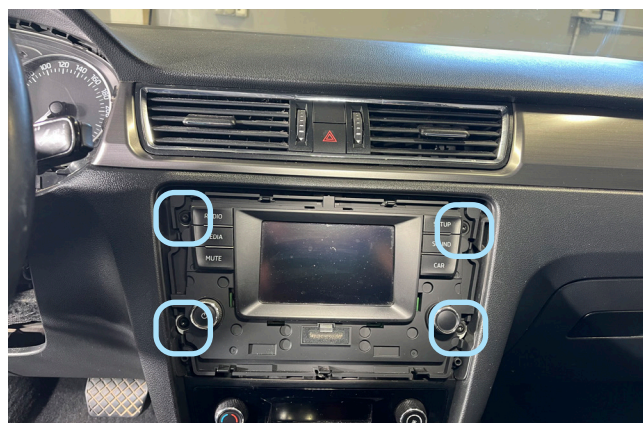
Фото 1.10. Декоративная накладка снята. Саморезы крепления магнитолы
