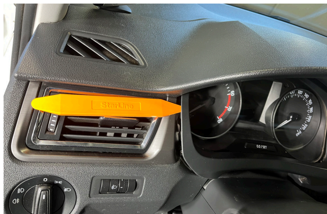
Фото 1.2. Снять накладку панели приборов
