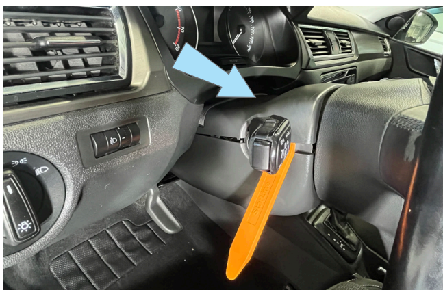
Фото 1.5. Верхняя часть кожуха рулевого вала
