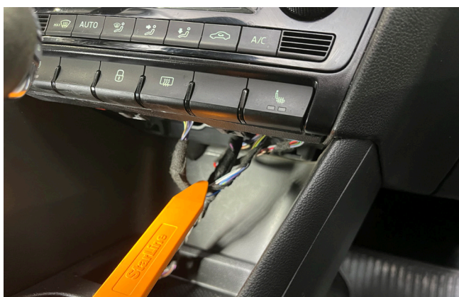
Фото 3.8. Местоположение жгута блока кнопок
