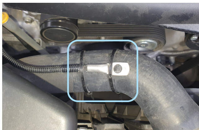
Фото 2.5. Крепление датчика температуры двигателя
