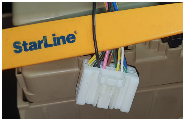
Фото 3.2. Подключение массы (чёрный, pin 3)
