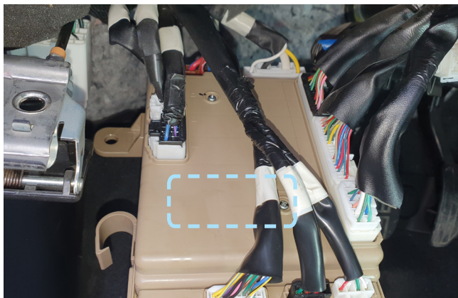
Фото 2.87 Пример расположения центрального блока охранно-телематического комплекса
