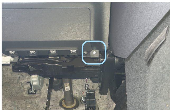
Фото 1.4. Саморез крепления накладки под рулевой колонкой
