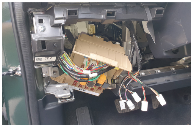
Фото 1.8. Монтажный блок предохранителей снят
