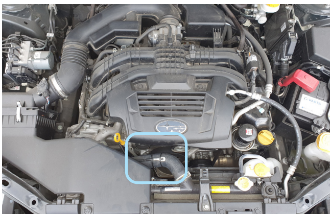
Фото 2.4. Возможное место установки датчика температуры двигателя
