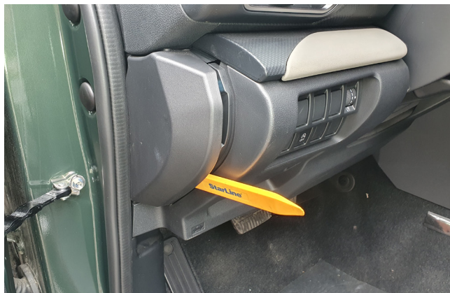
Фото 1.2. Снять левую боковую накладку передней панели
