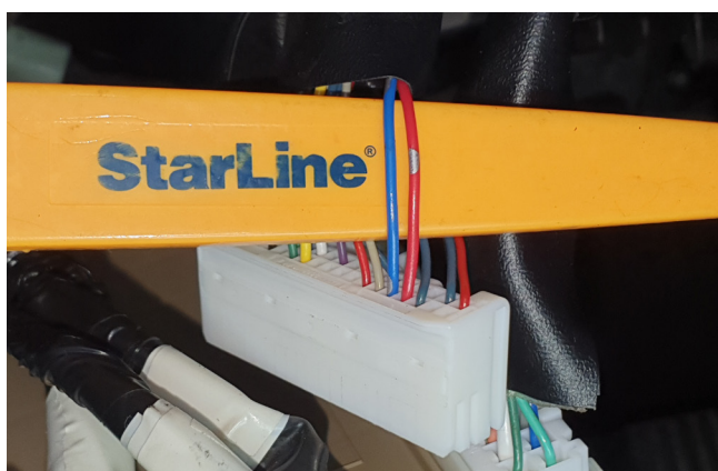
Фото 3.6. Шина CAN-B (красный, pin 24 и синий, pin 25)
