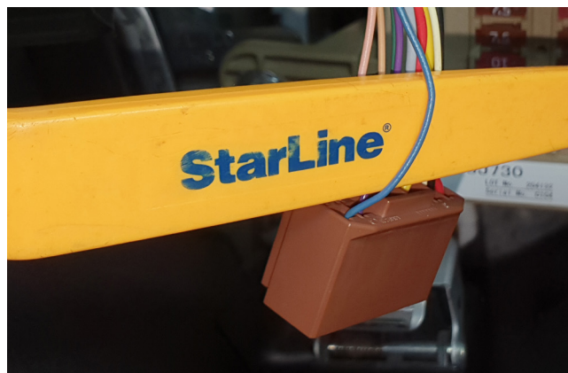
Фото 3.13. Зажигание 1 (синий, pin 12)
