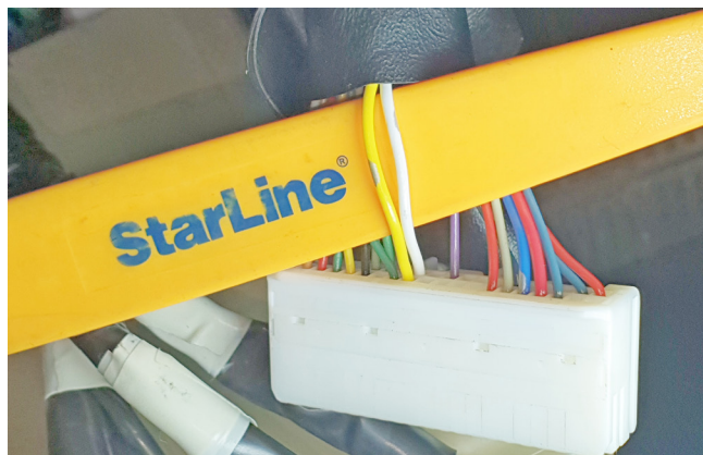
Фото 3.8. Управление центральным замком (жёлтый, pin 32 и белый, pin 12)
