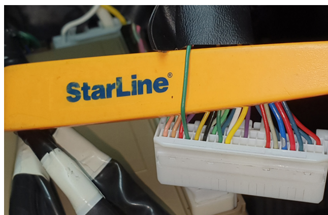
Фото 3.7. Альтернативное управление световыми сигналами (зелёный, pin 37)
