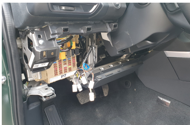
Фото 1.6. Пластиковая накладка под рулевой колонкой снята
