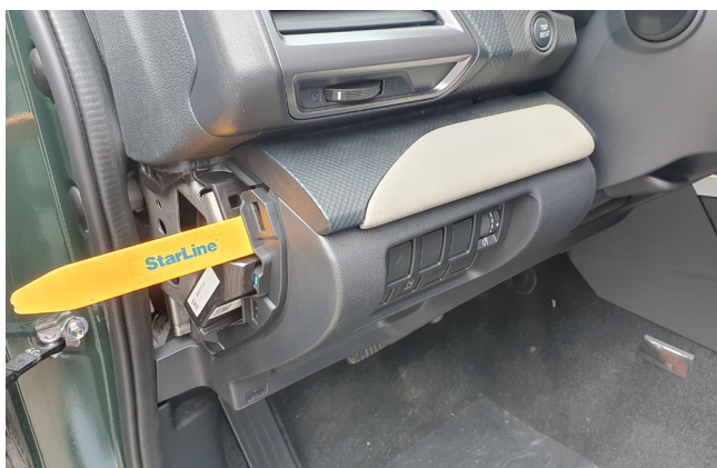
Фото 1.5. Снять пластиковую накладку под рулевой колонкой
