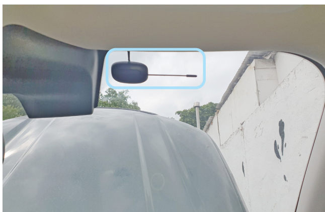
Фото 2.1. Возможное место установки антенного модуля
