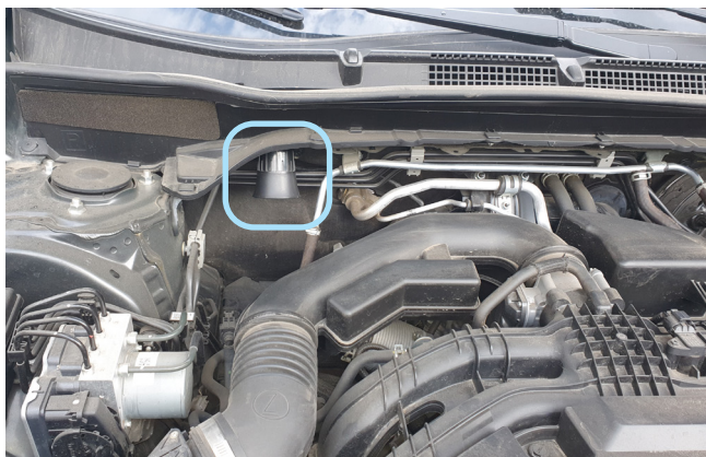
Фото 2.2. Возможное место установки сирены
