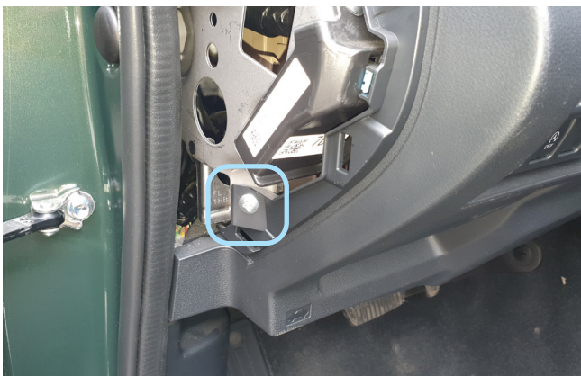
Фото 1.3. Накладка снята. Саморез
