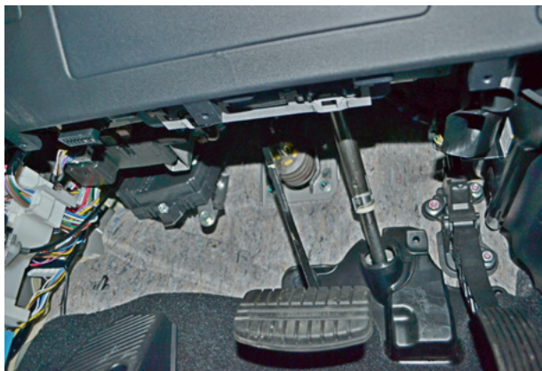
Фото 2.3. Накладка педального узла снята
