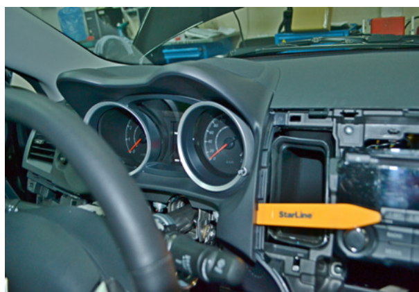
Фото 4.10. Снять пластиковую накладку панели приборов
