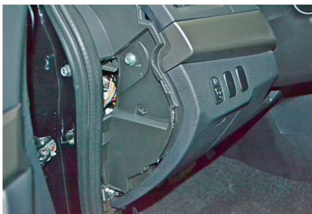
Фото 2.5. Левая боковая накладка передней панели снята
