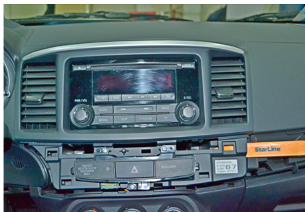
Фото 4.8. Снять декоративную накладку магнитолы
