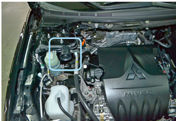
Фото 6.1. Возможное место установки сирены
