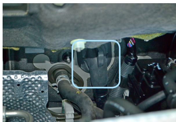
Фото 6.6. Штатный уплотнитель. Вид со стороны капота
