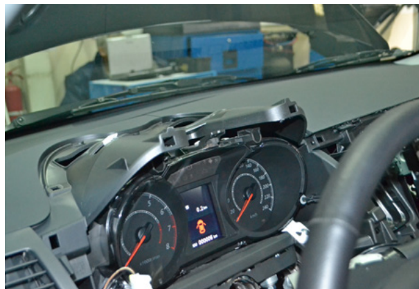
Фото 4.12. Верхняя накладка панели приборов снята
