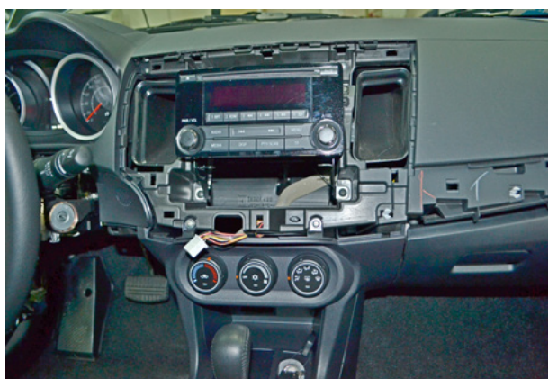
Фото 4.9. Декоративная накладка магнитолы снята
