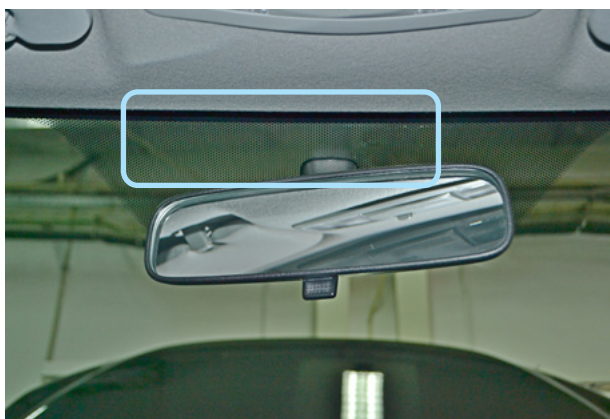
Фото 5.1. Возможное место установки антенного модуля
