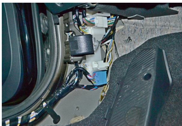
Фото 1.4. Пластиковая накладка левой кик-панели снята
