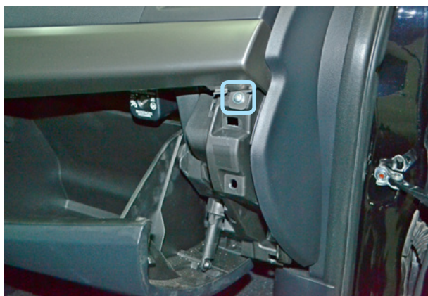
Фото 4.3. Пластиковая накладка справа от перчаточного ящика снята. Саморез
