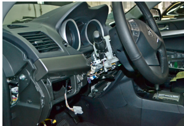
Фото 3.4. Кожух рулевого вала снят
