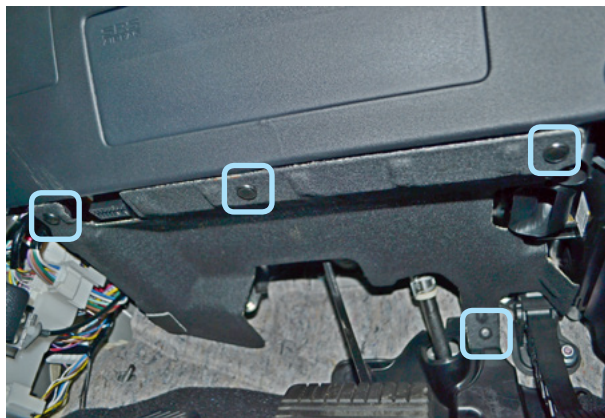
Фото 2.2. Клипсы крепления накладки педального узла
