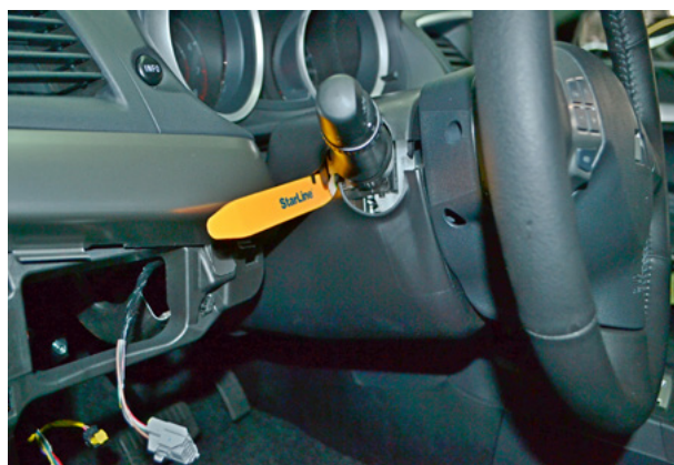
Фото 3.2. Снять верхнюю часть кожуха рулевого вала
