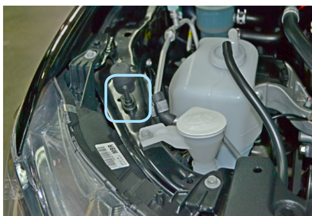
Фото 6.5. Возможное место установки концевика капота
