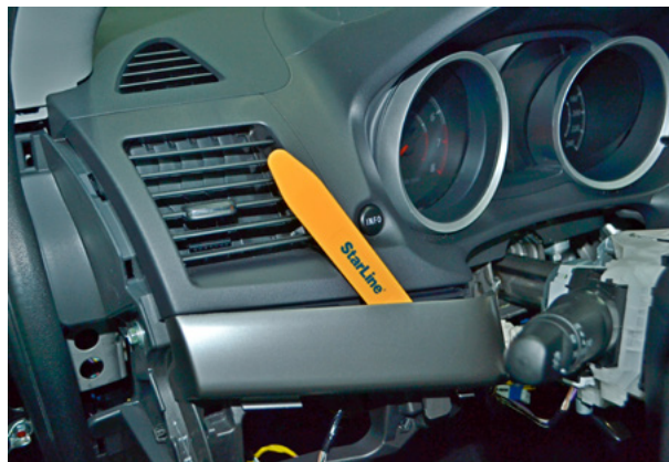
Фото 4.6. Снять левую декоративную накладку передней панели
