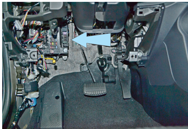
Фото 2.10. Местоположение блока ETACS
