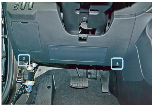
Фото 2.6. Саморезы крепления накладки под рулевой колонкой
