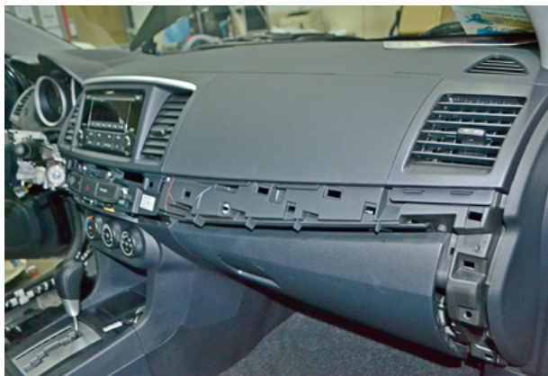
Фото 4.5. Продольная накладка передней панели снята
