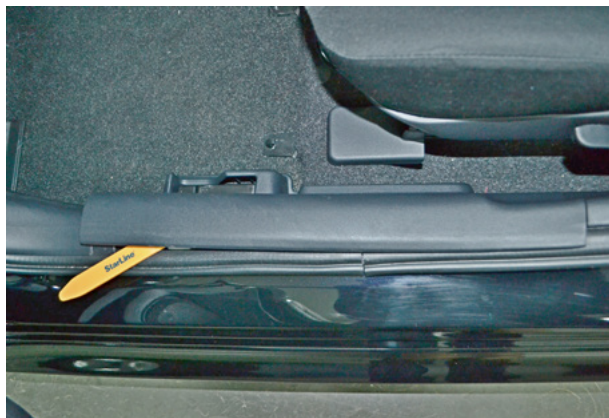
Фото 1.1. Снять накладку порога двери водителя
