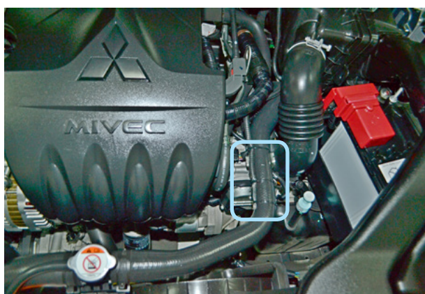
Фото 6.3. Место установки датчика температуры двигателя
