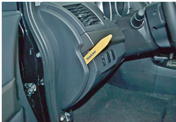
Фото 2.4. Снять левую боковую накладку передней панели
