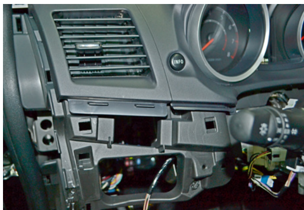
Фото 4.7. Левая накладка передней панели снята
