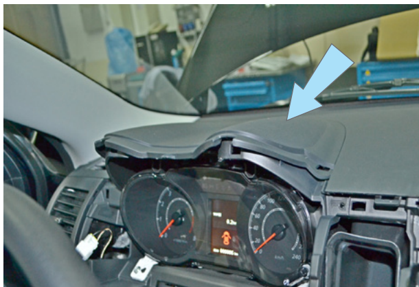
Фото 4.11. Верхняя накладка панели приборов
