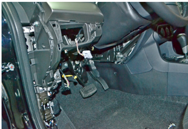
Фото 2.9. Подушка безопасности снята
