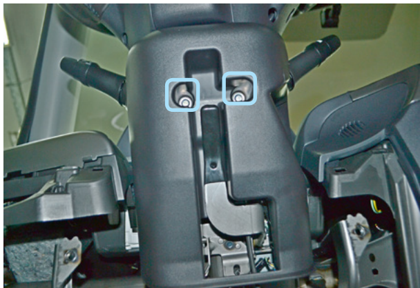
Фото 3.3. Саморезы крепления нижней части кожуха рулевого вала
