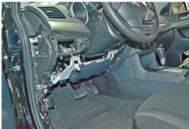
Фото 2.7. Накладка под рулевой колонкой снята
