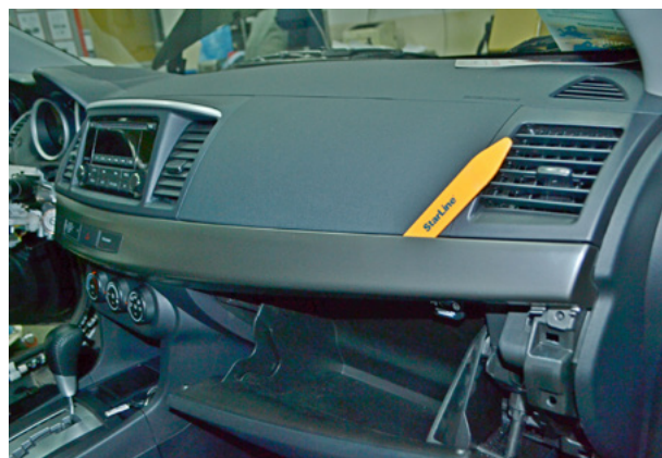
Фото 4.4. Снять продольную декоративную накладку передней панели
