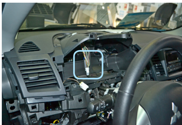
Фото 9.1. Местоположение разъёма панели приборов
