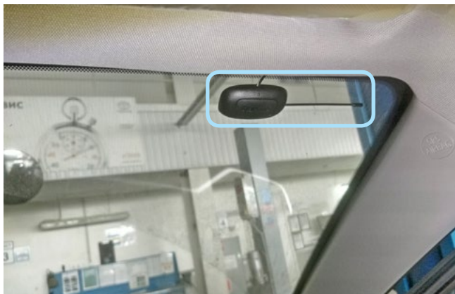
Фото 2.1. Возможное место установки антенного модуля
