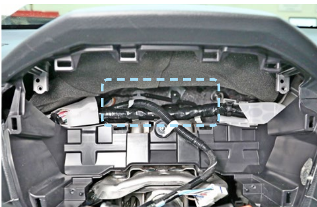
Фото 2.8. Пример расположения центрального блока охранно-телематического комплекса
