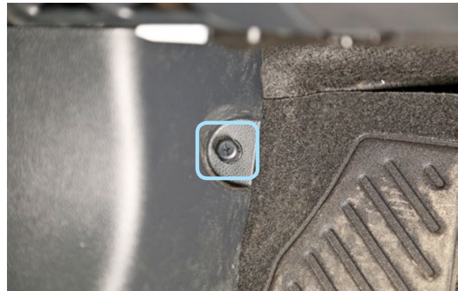
Фото 1.4. Клипса крепления накладки кик-панели
