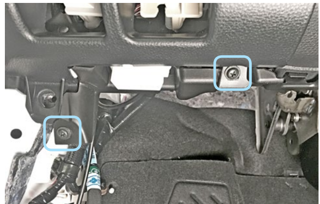
Фото 1.6. Саморезы крепления накладки педального узла слева
