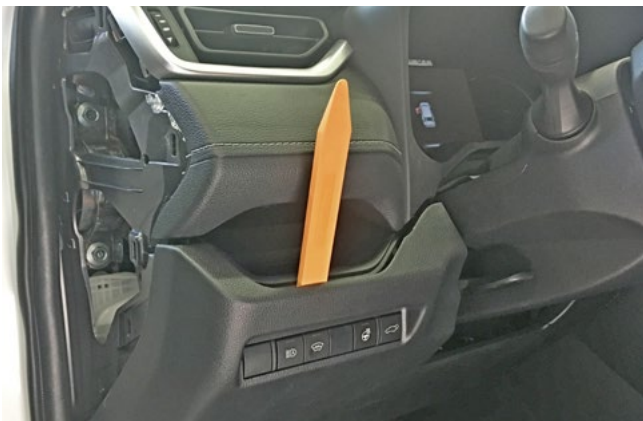
Фото 1.9. Снять накладку под рулевой колонкой
