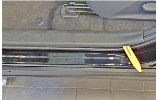
Фото 1.2. Снять накладку порога двери водителя
