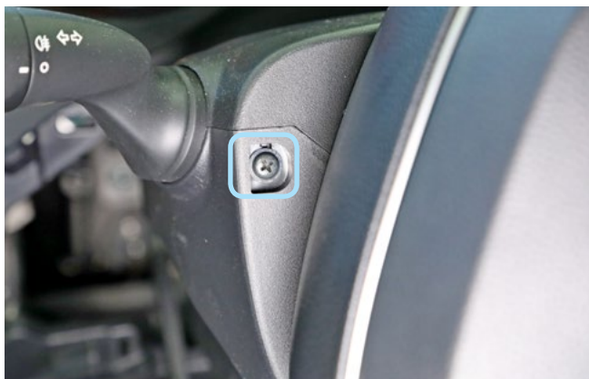
Фото 1.17. Саморез крепления кожуха рулевого вала слева
