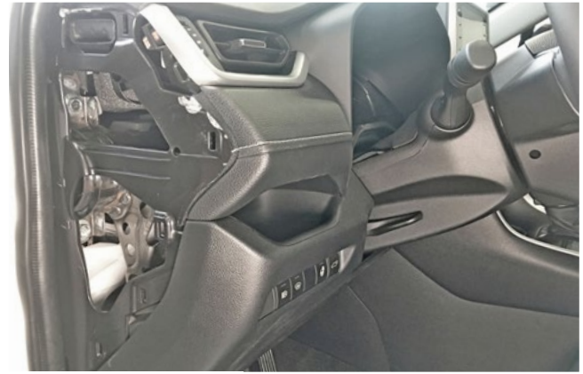
Фото 1.8. Левая боковая накладка передней панели снята
