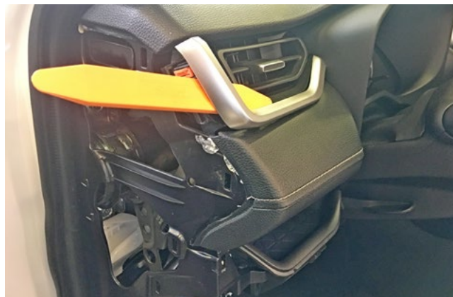
Фото 1.13. Снять накладку под левым воздуховодом
