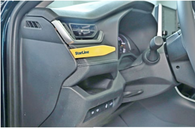
Фото 1.7. Снять левую боковую накладку передней панели
