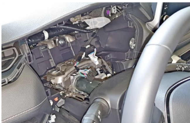
Фото 1.16. Панель приборов снята
