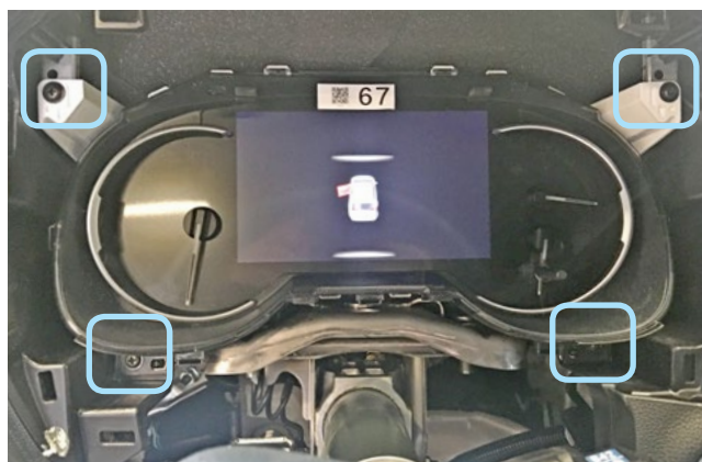
Фото 1.15. Накладка панели приборов снята. Саморезы крепления панели приборов
