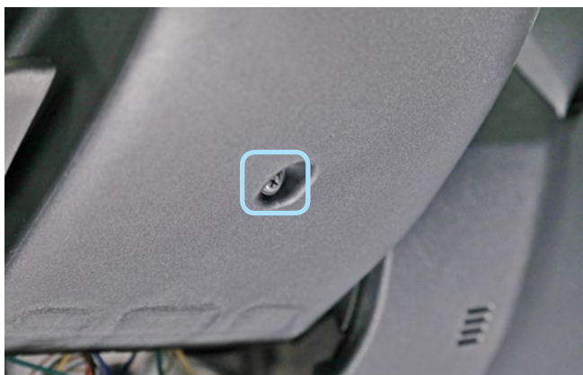
Фото 1.19. Саморез крепления кожуха рулевого вала снизу
