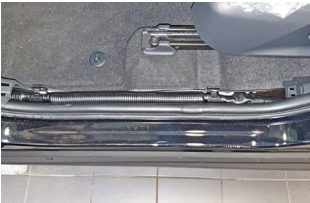
Фото 1.3. Накладка порога двери водителя снята
