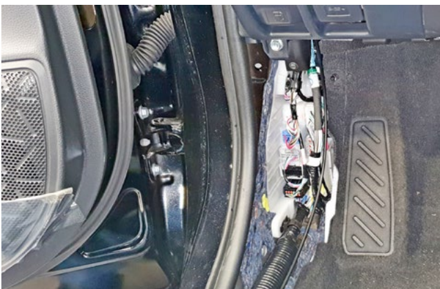
Фото 1.5. Накладка кик-панели снята
