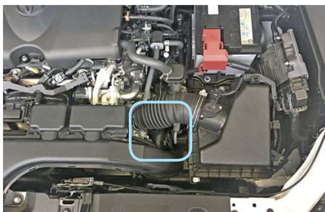
Фото 2.4. Место установки датчика температуры двигателя
