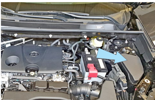
Фото 2.7. Возможное место установки подкапотного блока R6
