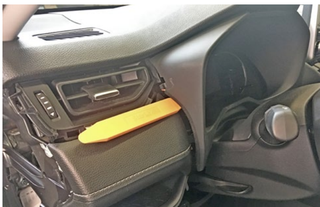
Фото 1.14. Снять накладку панели приборов
