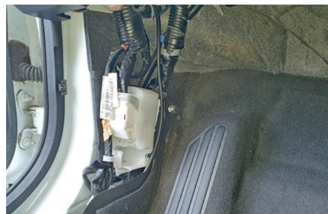
Фото 1.5. Накладка левой кик-панели снята
