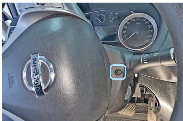
Фото 1.12. Саморез крепления кожуха рулевого вала справа
