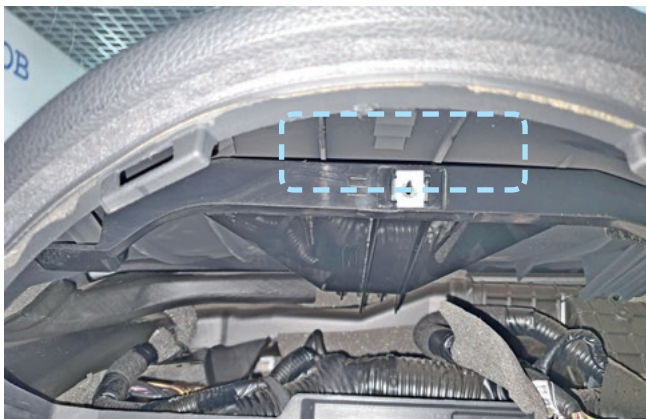
Фото 2.10. Пример расположения центрального блока охранно-телематического комплекса
