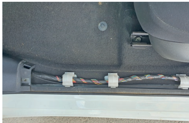
Фото 1.2. Накладка порога двери водителя снята
