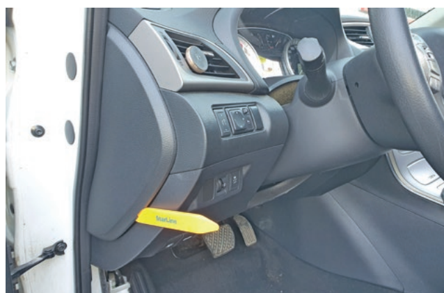
Фото 1.6. Снять левую накладку передней панели
