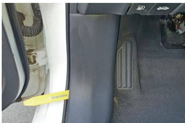
Фото 1.4. Снять накладку левой кик-панели
