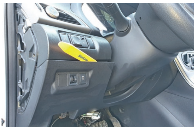
Фото 1.9. Снять накладку под рулевой колонкой
