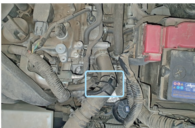
Фото 2.5. Место установки датчика температуры двигателя
