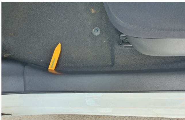
Фото 1.1. Снять накладку порога двери водителя
