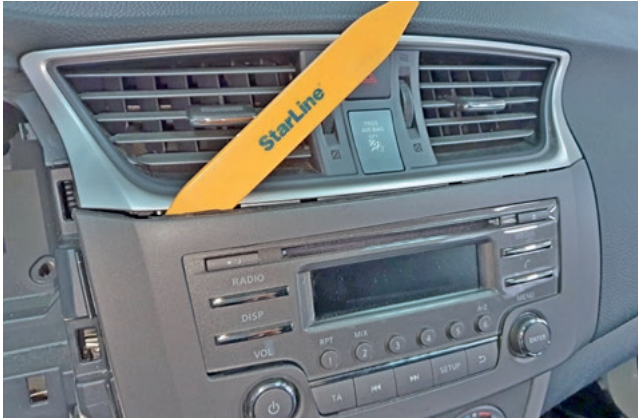
Фото 1.19. Снять накладку магнитолы
