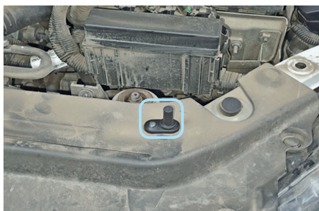
Фото 2.8. Возможное место установки концевика капота
