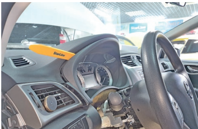
Фото 1.15. Снять накладку панели приборов
