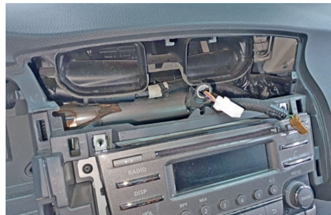
Фото 1.22. Накладка воздуховодов снята
