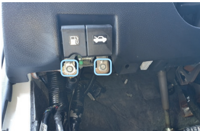
Фото 1.7. Болты крепления ручек отпирания капота и бензобака
