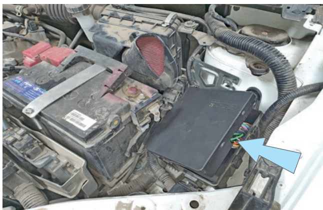
Фото 2.9. Возможное место установки подкапотного блока R6
