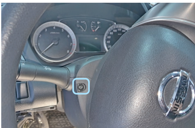
Фото 1.11. Саморез крепления кожуха рулевого вала слева
