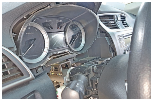
Фото 1.16. Накладка панели приборов снята
