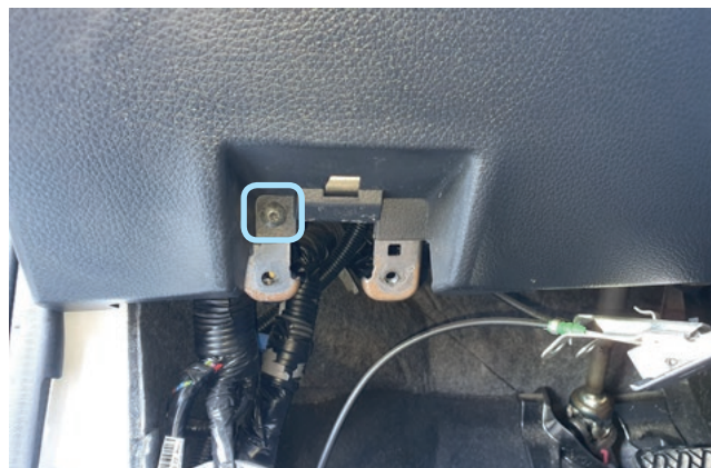
Фото 1.8. Саморез крепления накладки под рулевой колонкой
