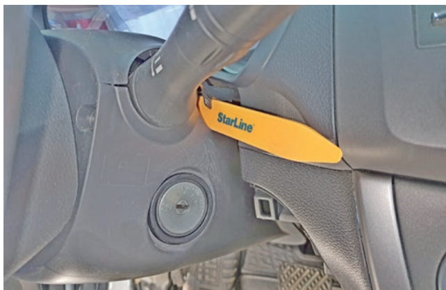
Фото 1.13. Снять верхнюю и нижнюю накладку кожану рулевого вала
